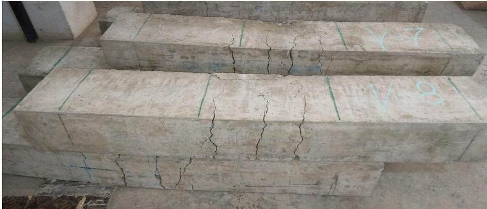
Vigas de Concreto con Refuerzo de Acero, Falla Flexión
