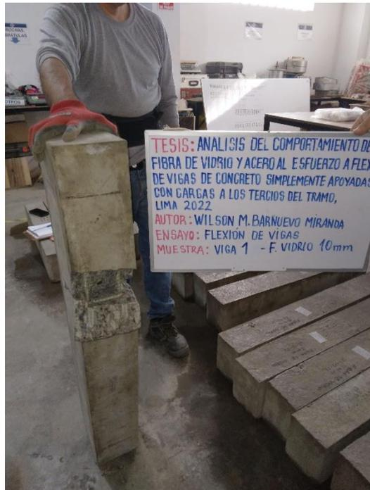
Rotura de Viga con Refuerzo de PRFV
