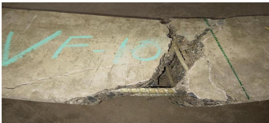
Viga de Concreto con Refuerzo de PRFV, Falla Flexión-Cortante
