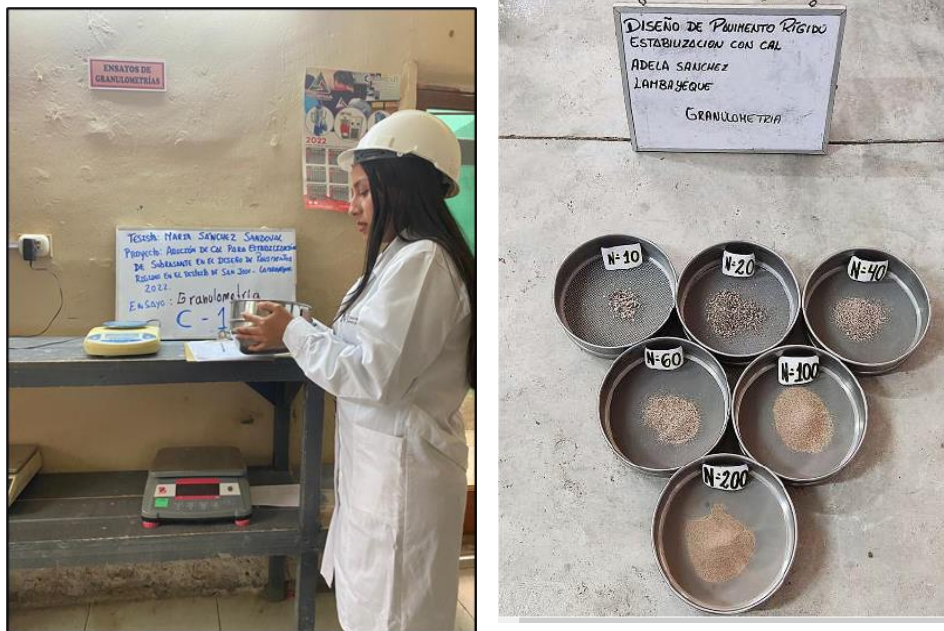
Figura 13 Muestra gráfica de ensayos de análisis del suelo
