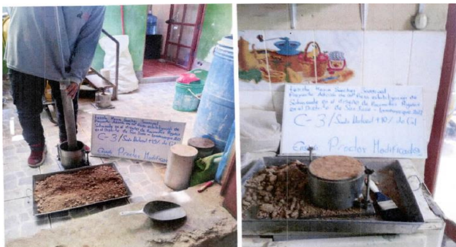
Figura 26 Muestra gráfica de ensayos Proctor
