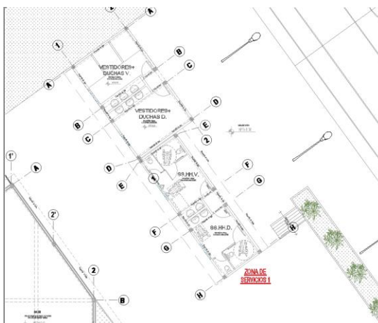
Figura 5. Servicios higiénicos de zona de losa deportiva
