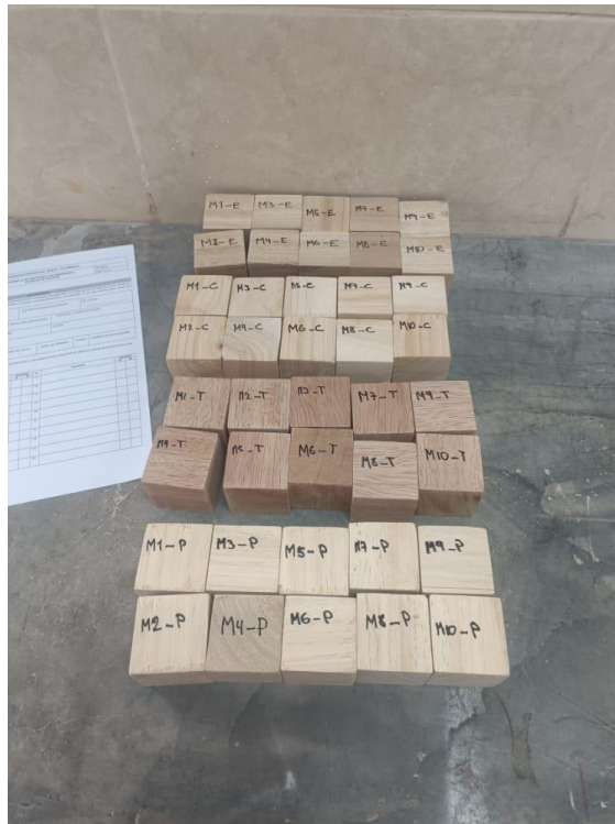
Muestras para ensayo de contenido de humedad
