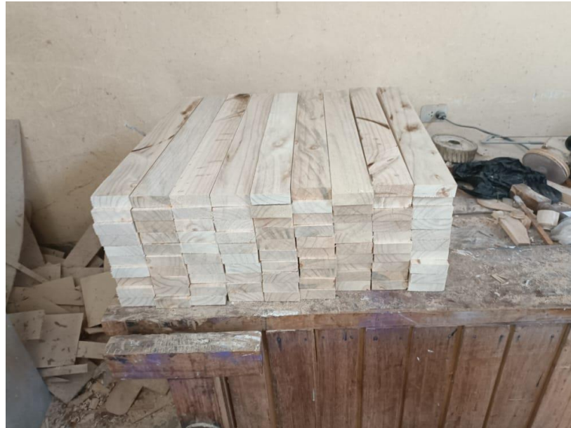
Laminas para elaboración de vigas laminadas
