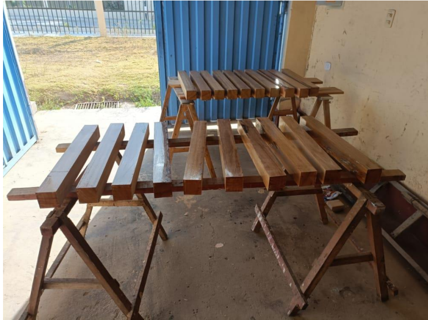
Secado de vigas luego de aplicar aditivos
