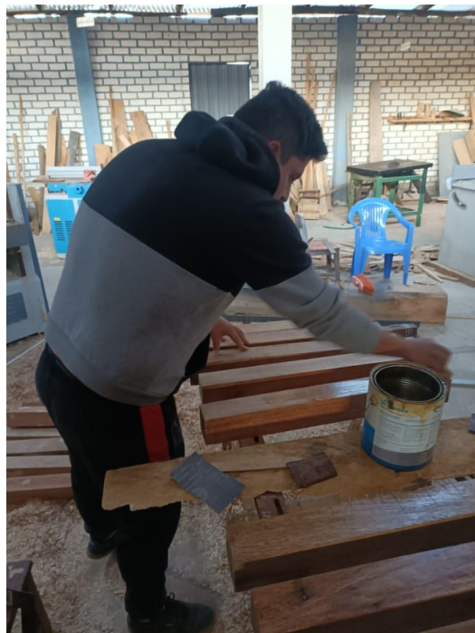
Colocación de aditivos en vigas
