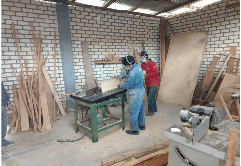
Cortado de madera sólida en laminas
