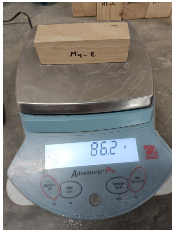
Toma de datos para ensayo de densidad
