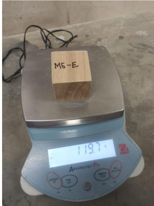
Toma de datos para ensayo de contenido de humedad
