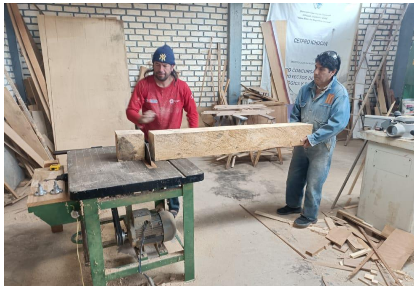
Cortado de madera sólida para elaboración de muestras
