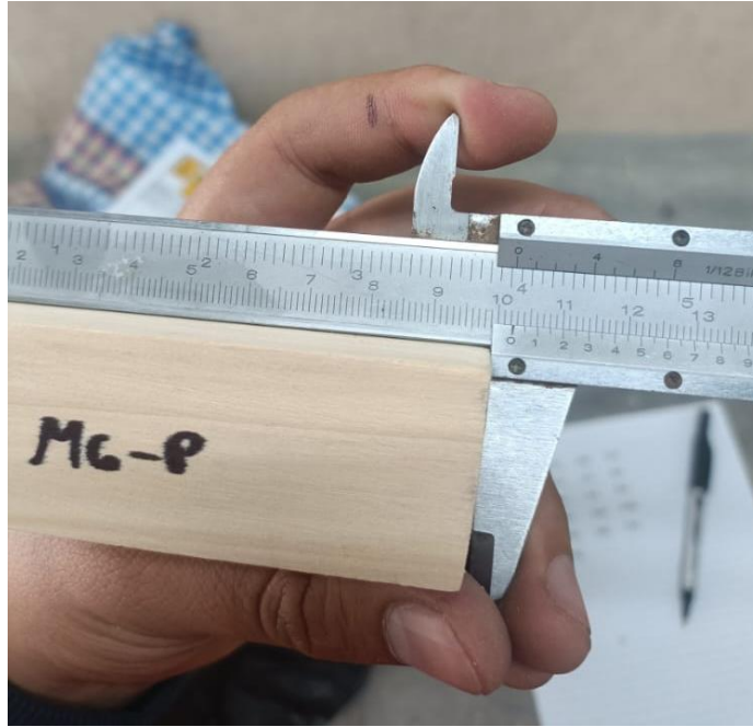
Toma de datos para ensayo de densidad
