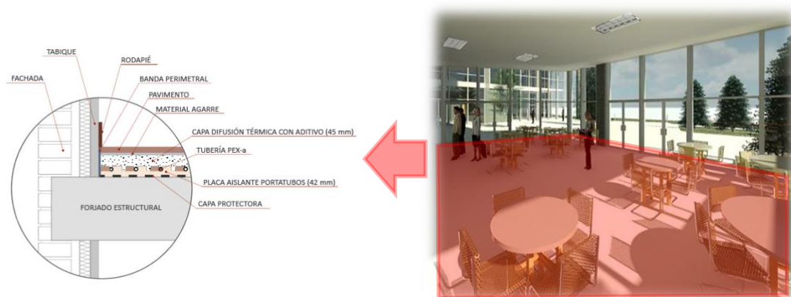
Imagen 1: Tecnología- Detalle de suelo radiante
