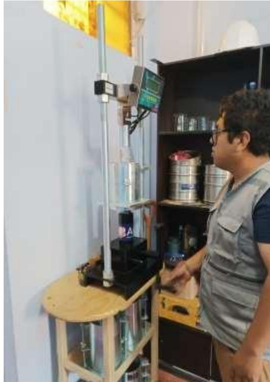
Fotografía 13: Uso de equipo de carga en el ensayo para la capacidad de soporte
