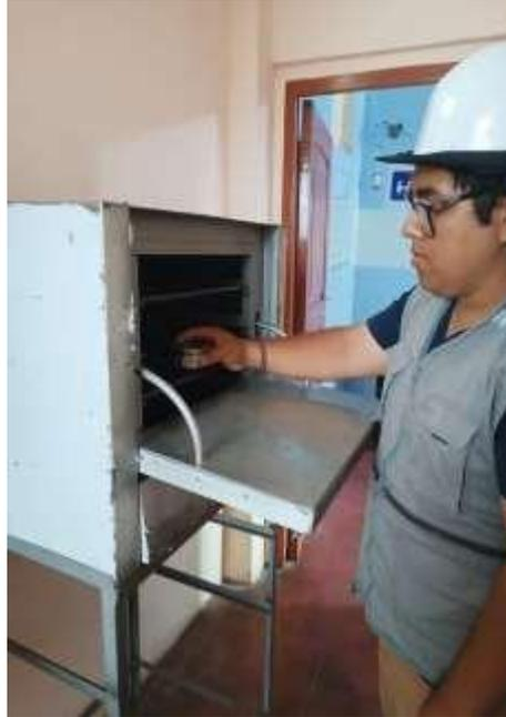
Fotografía 17: Colocación de material de hilos alargados al horno
