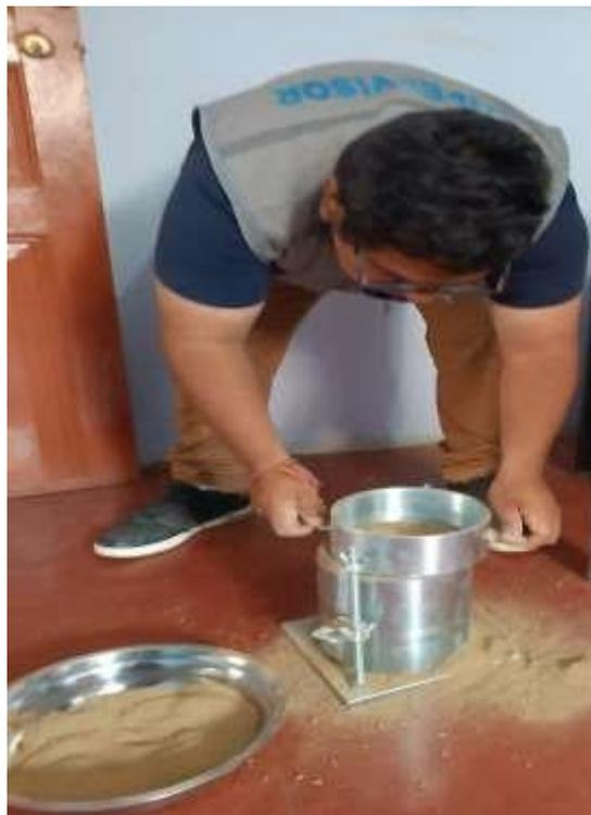
Fotografía 10: Colocación de anillo para el ensayo CBR
