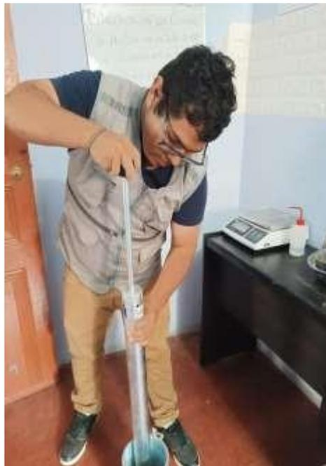
Fotografía 20: Colocación de material en capas y compactado para el ensayo de Proctor
