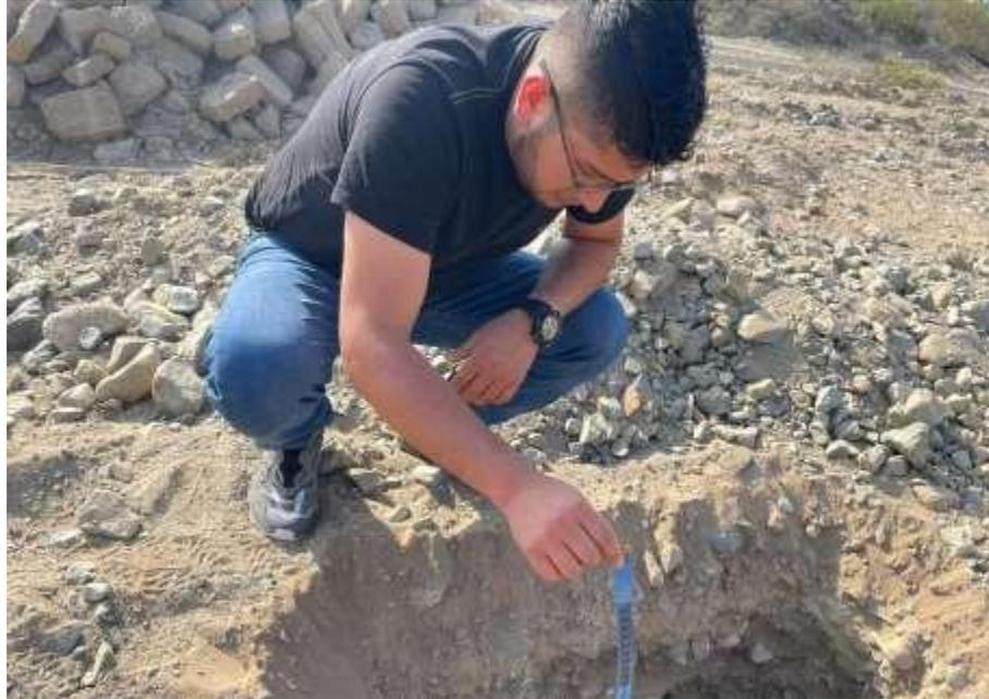
Fotografía 7: Medición de 1.50 de profundidad de calicata
