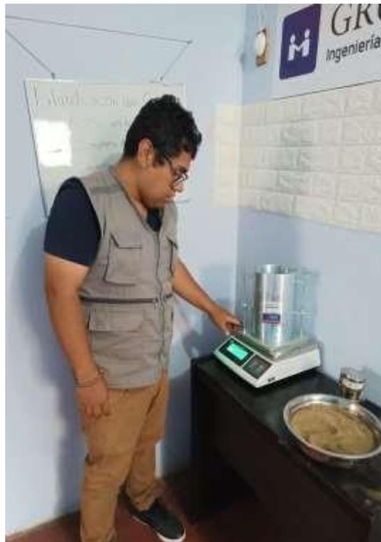
Fotografía 18: Peso del molde para ensayo de Proctor modificado
