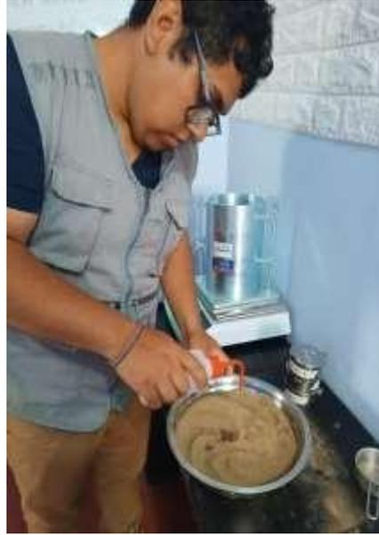
Fotografía 19: Colocación de agua para el contenido de humedad óptima
