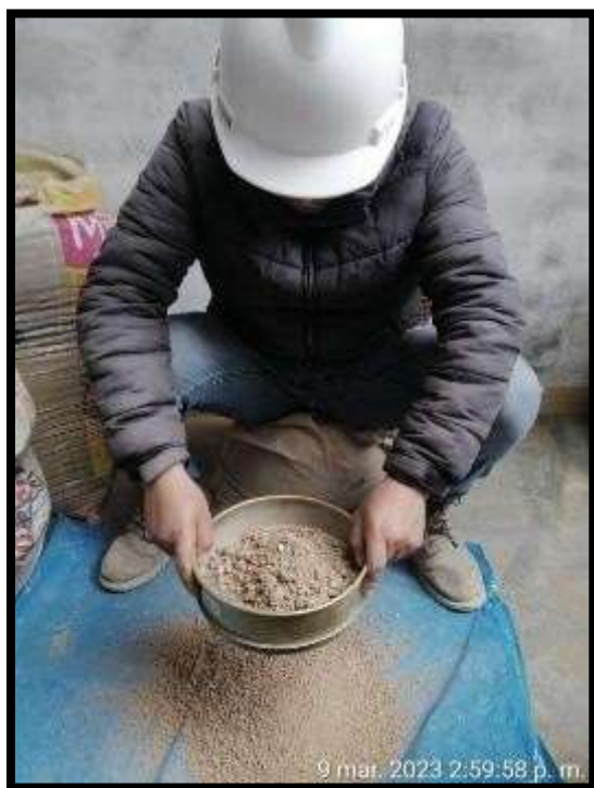
Fotografía 9: Tamizado de material para elaboración de adobes.
