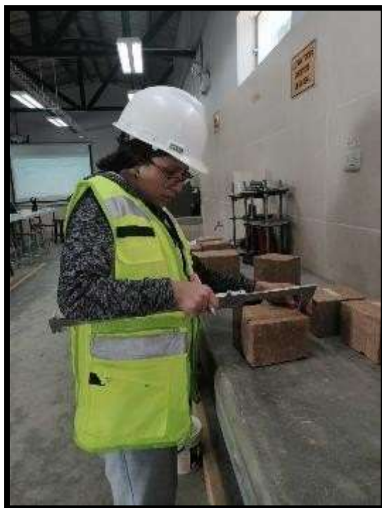
Fotografía 15: Medición de adobes.
