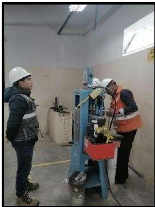
Fotografía 16: Realizando ensayos de compresión
