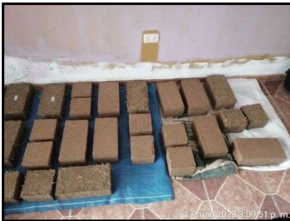
Fotografía 14: Secado de adobes.
