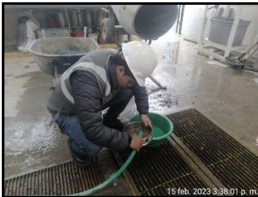
Fotografía 3: Realizando ensayo de granulometría
