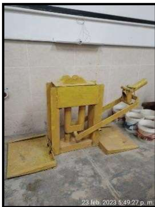
Fotografía 8: Máquina CINVA RAM utilizada para elaboración de los BTC.
