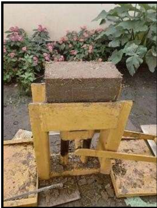
Fotografía 13: Adobe elaborado en la máquina CINVA RAM.
