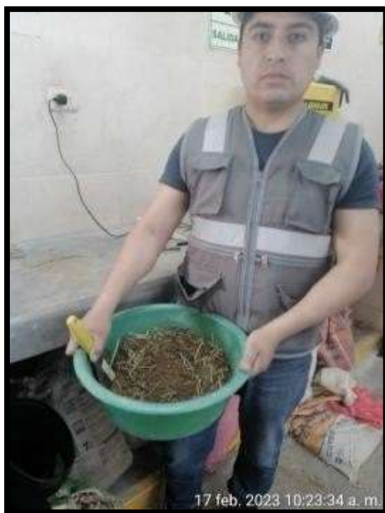
Fotografía 6: Preparación de muestra para ensayo de Proctor Modificado.
