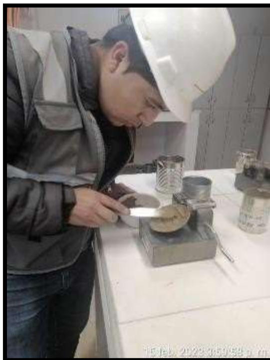
Fotografía 4: Realizando ensayo de Límite Líquido
