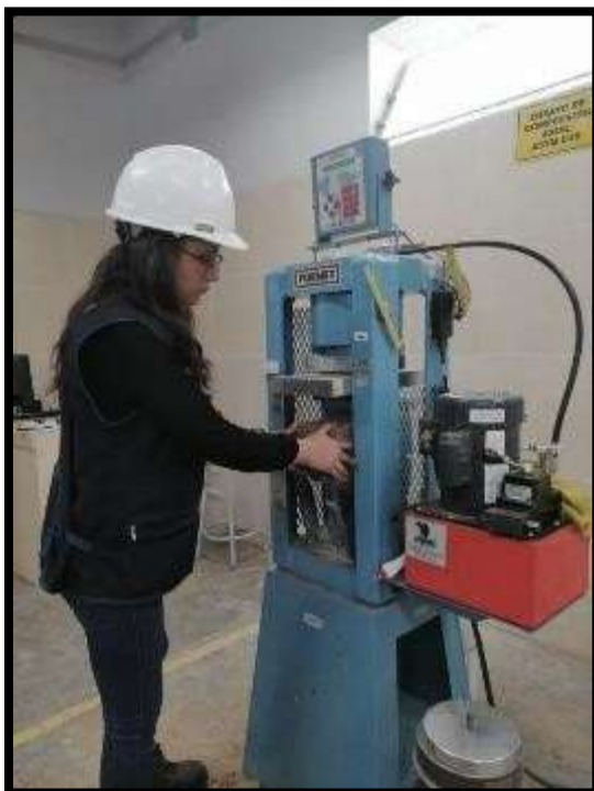
Fotografía 17: Realizando ensayos a flexión
