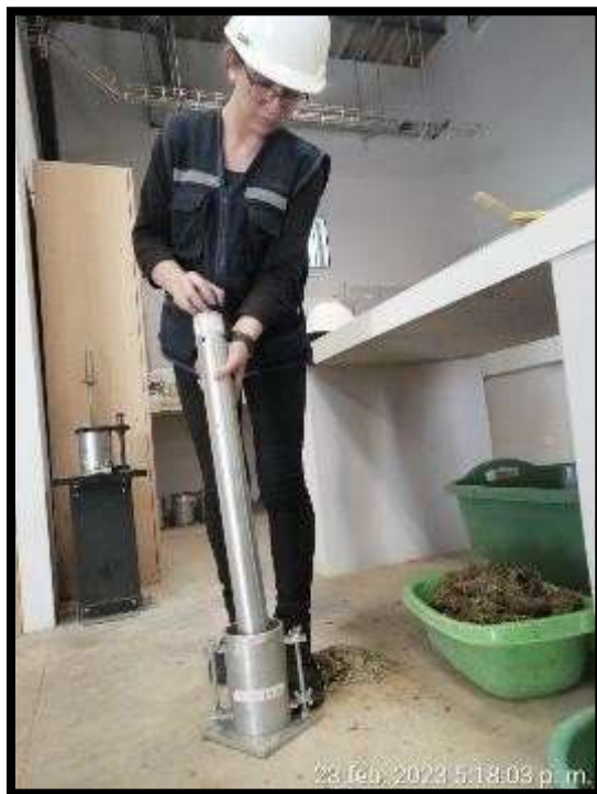
Fotografía 7: Realizando ensayo de Proctor Modificado
