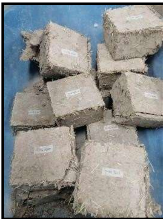
Fotografía 18: Adobes que fueron sometidos a ensayos a compresión y flexión.
