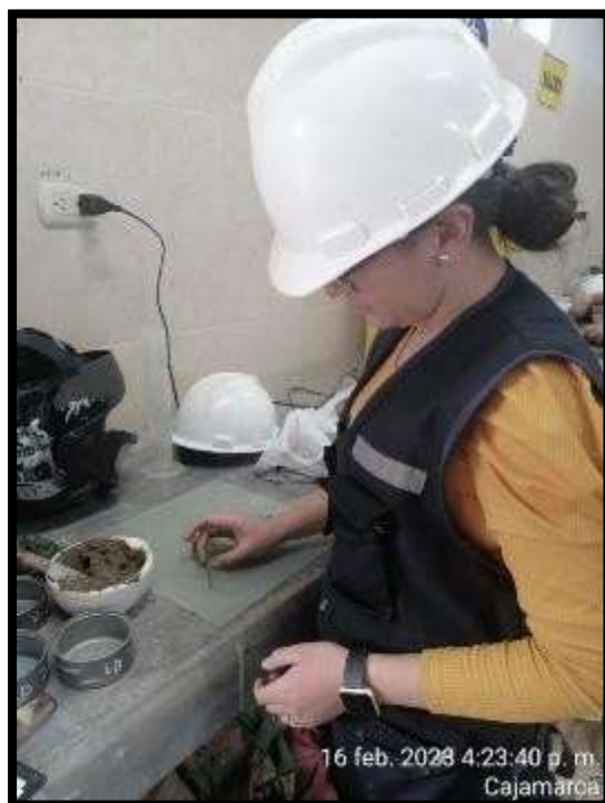
Fotografía 5: Realizando ensayo de Límite Plástico
