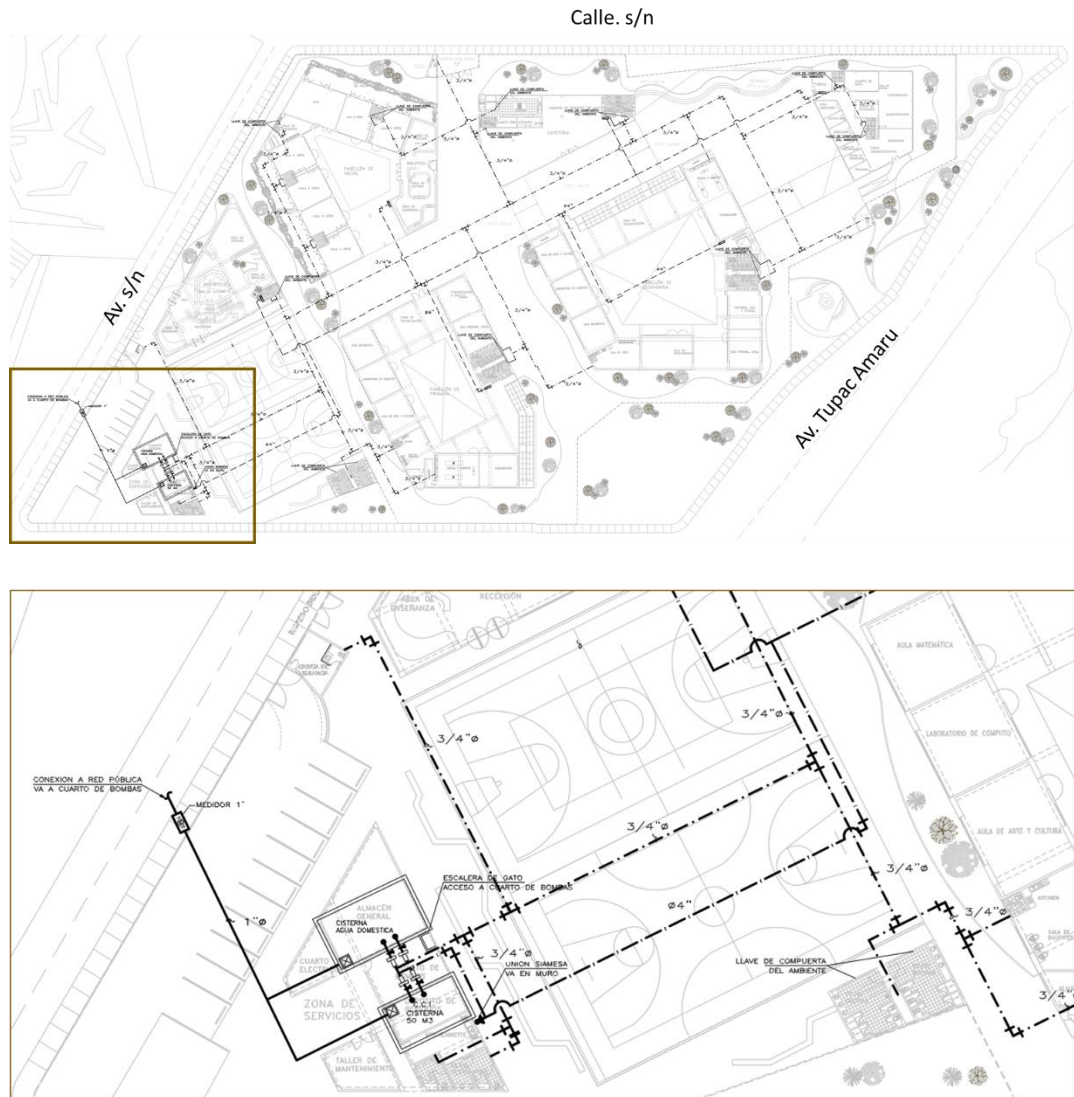
Figura 133. Llegada del medidor al proyecto. Elaboración propia
