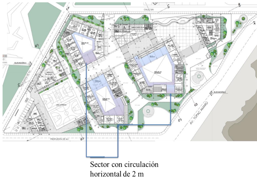
Figura 122. Circulación horizontal, primer nivel. Elaboración propia.
