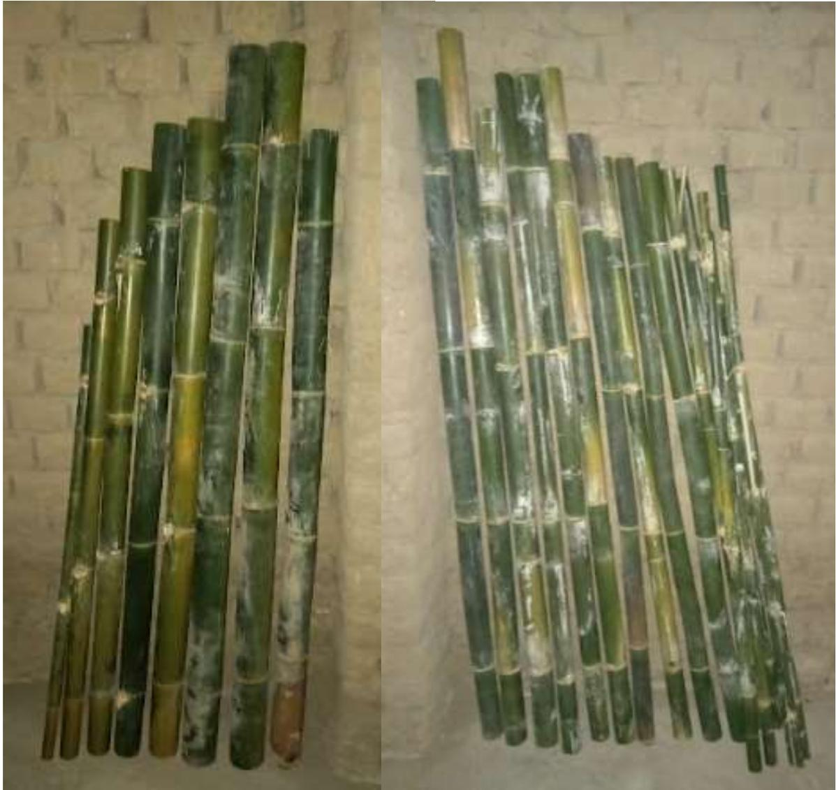
*Nota:* La figura muestra a los culmos de bambú en proceso de secado antes de su preservación
