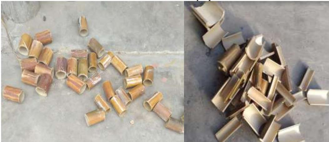
*Nota:* El corte en secciones más pequeñas del bambú se realizó para hacerlo más trabajable, pero más importante: para obtener los palillos y las fibras aditivas para el ladrillo.
