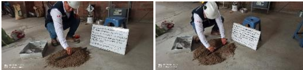
Figura 41: Remojado de la Muestra
