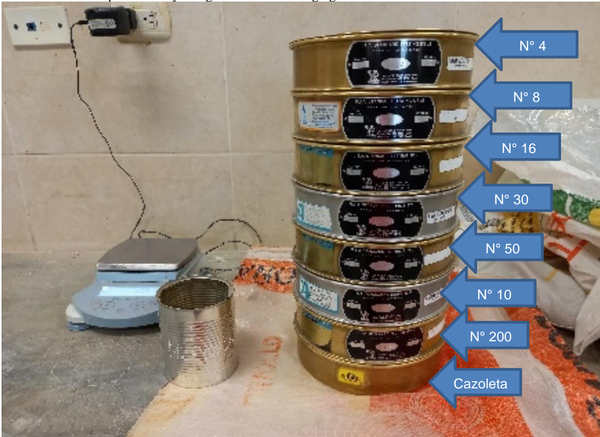
Figura 19 Tamices utilizados para el ensayo de granulometría del agregado fino
