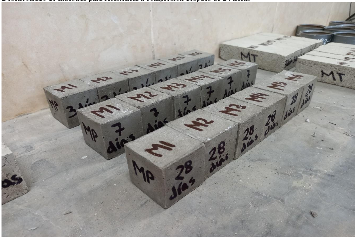
Figura 39 Desencofrado de muestras para resistencia a compresión después de 24 horas
