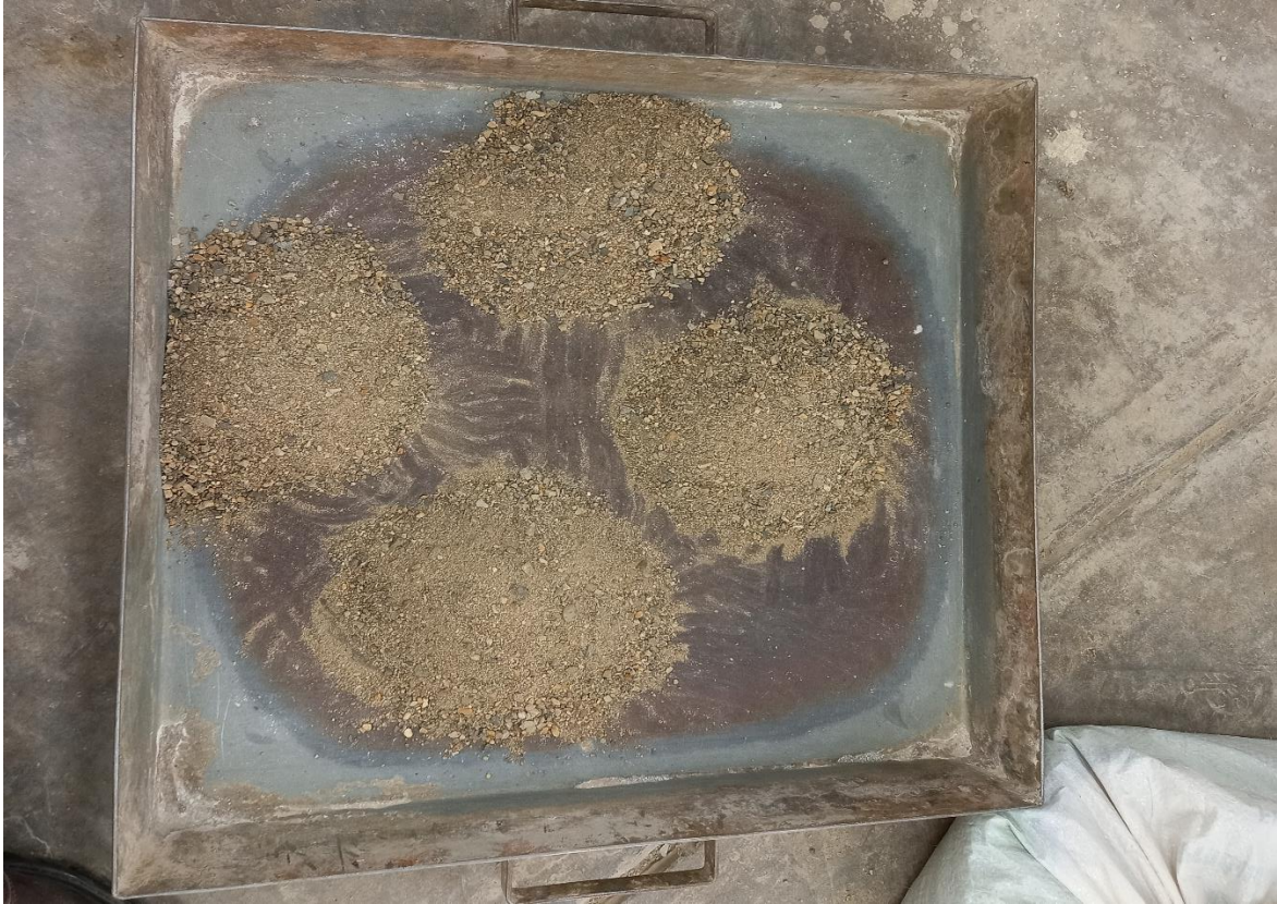
Figura 18 Cuarteo de agregado fino para realizar ensayo de granulometría
