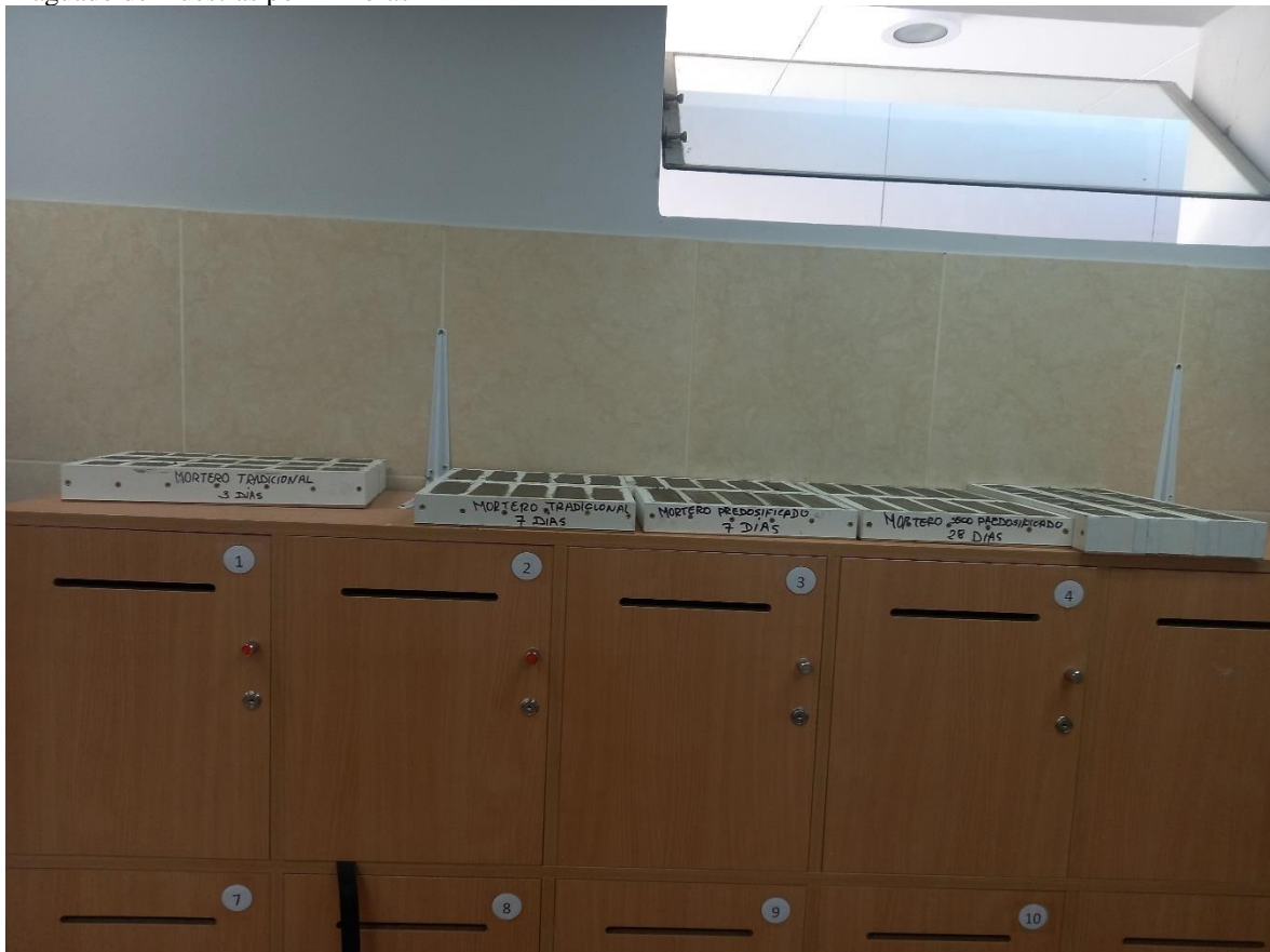
Figura 39 Desencofrado de muestras para resistencia a compresión después de 24 horas
