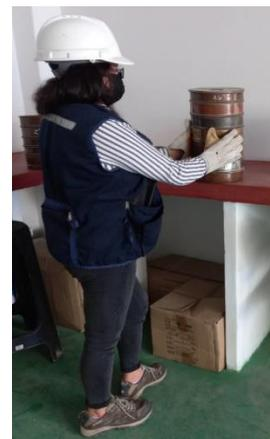
*Nota.* Se visualiza el proceso de la ejecución del ensayo de tamizado de materiales.
