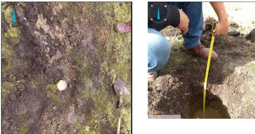
*Nota.* Se observa la ejecución del ensayo de permeabilidad In situ, que se llevó a cabo para el reconocimiento geotécnico, con el objetivo de determinar del coeficiente de permeabilidad del material In situ.
