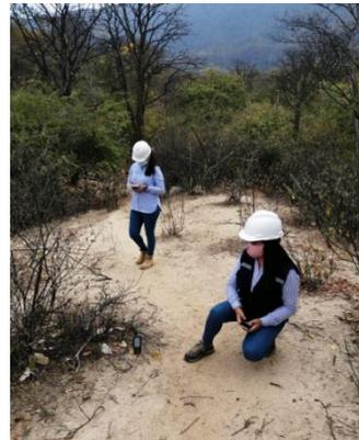
*Nota.* Se visualizan los trabajos de geofísica (ensayo de sondeo eléctrico vertical), mediante el cual se establece la forma en la que se distribuye la resistencia eléctrica y propiedades de los materiales que constituyen el subsuelo.
