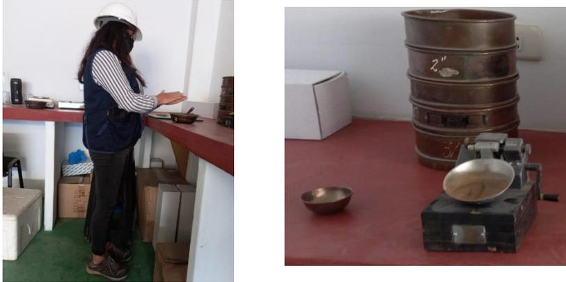
*Nota.* Se visualiza el manipúlelo del material mediante la verificación del procedimiento de la ejecución de limite liquido – plástico.
