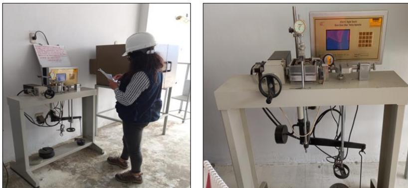
Nota. Se observa la ejecución del ensayo de corte directo, con lo que se determina los parámetros de resistencia drenado no consolidado, mediante este ensayo se
