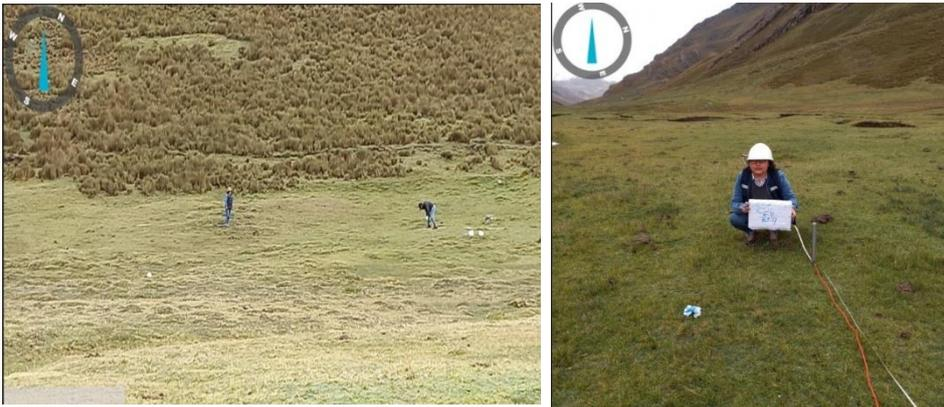
*Nota.* Ejecución del ensayo de geofísica (sondeo eléctrico vertical), In Situ para hallar la distribución de resistividad del suelo.
