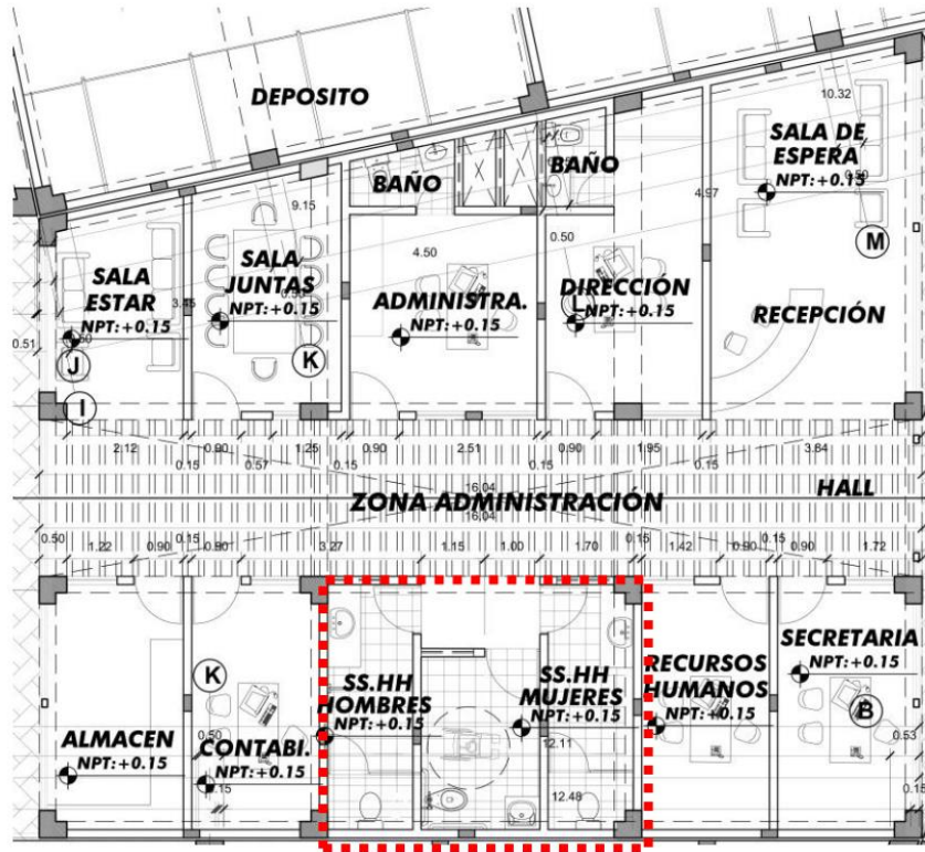
Figura 57. Dotación de baños en zona administrativa
