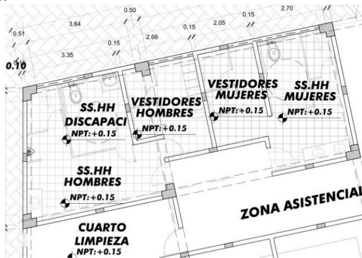
Figura 60. Dotación de servicios higiénicos en zona asistencial
