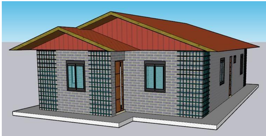
Figura 70: Estructura reforzada con malla electrosoldada. Fuente: Elaboración propia.
