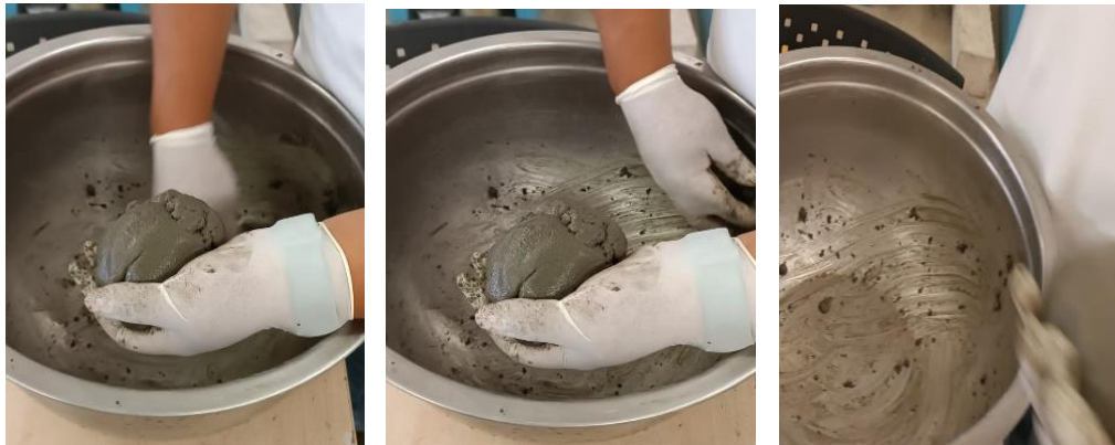
Ilustración 21: Moldeado de la mezcla.
