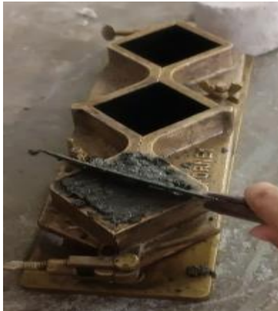
Ilustración 34: Enrazado de la muestra
