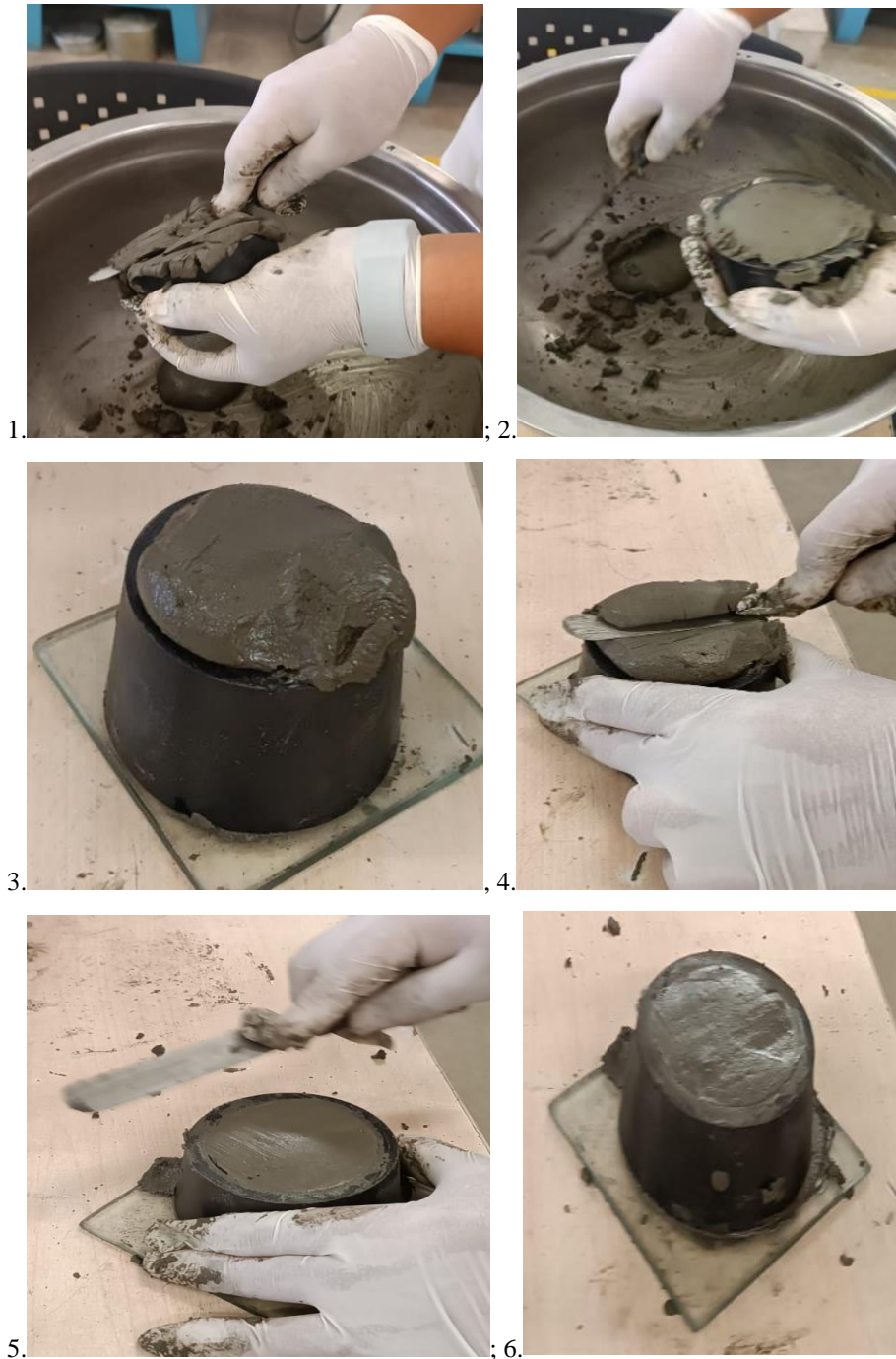
Ilustración 27: Moldeado de la mezcla.
