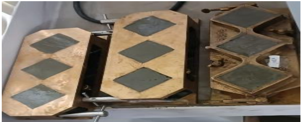
Ilustración 35: Reposo de la muestra en los moldes hasta que se solidifique.
