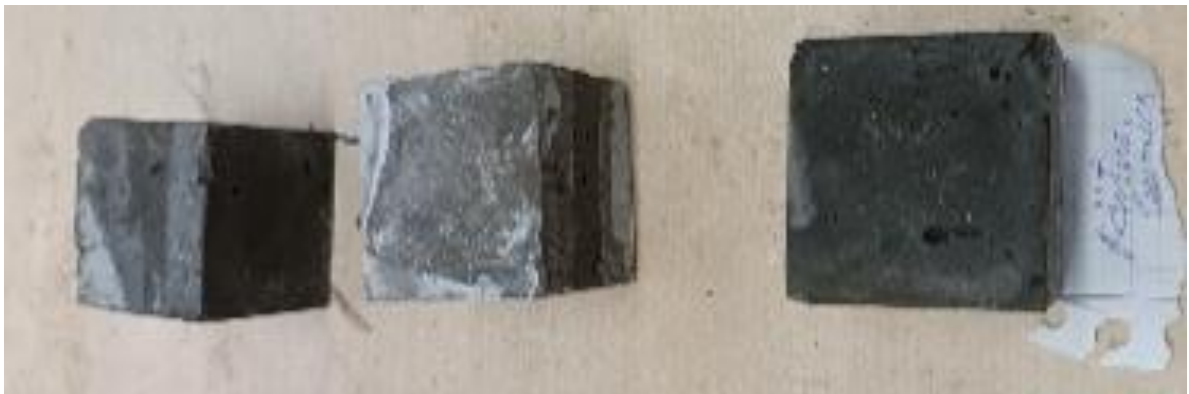
Ilustración 45: Muestras secas de los cubos en base a cemento, aditivo y agua.
