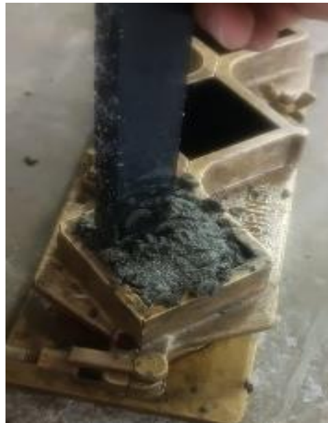
Ilustración 33: Compactacion de la muestra.
