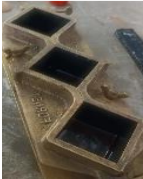
Ilustración 32: Molde de acero con desmoldante.
