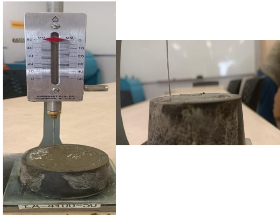
Ilustración 28: Posicionamiento de la muestra en el aparato de vicat.
