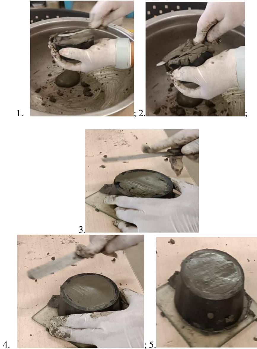
Ilustración 22: Moldeado de la mezcla.
