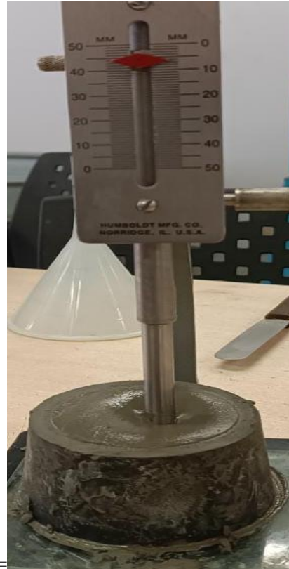
Ilustración 39: Resultados de consistencia con los porcentajes de agua utilizados.
