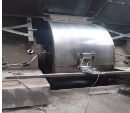
Figura 11: Medición de diámetros en rodillos
