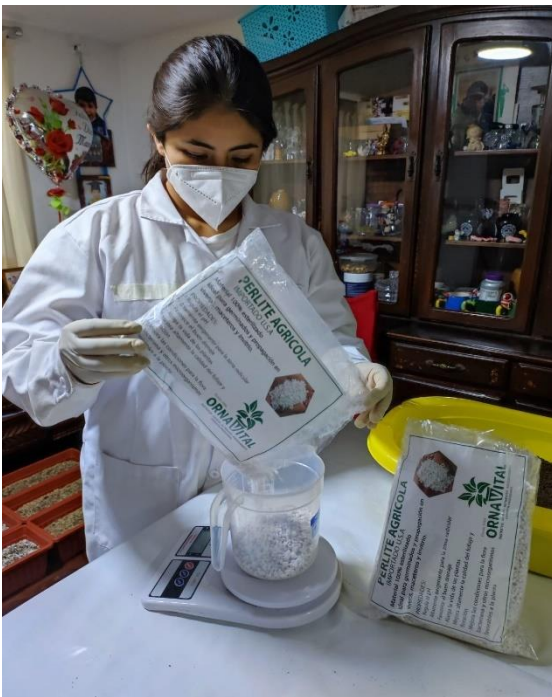
Nota: Pesado del sustrato perlita para el tratamiento 3 – Tierra de chacra 70% + perlita 30%.
