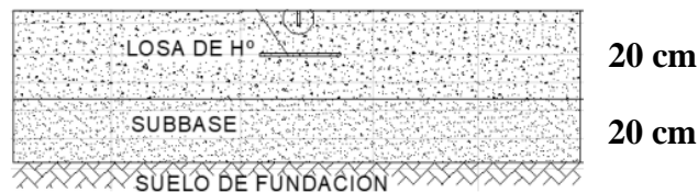
Figura 17: Representación del espesor de la losa por método PCA
