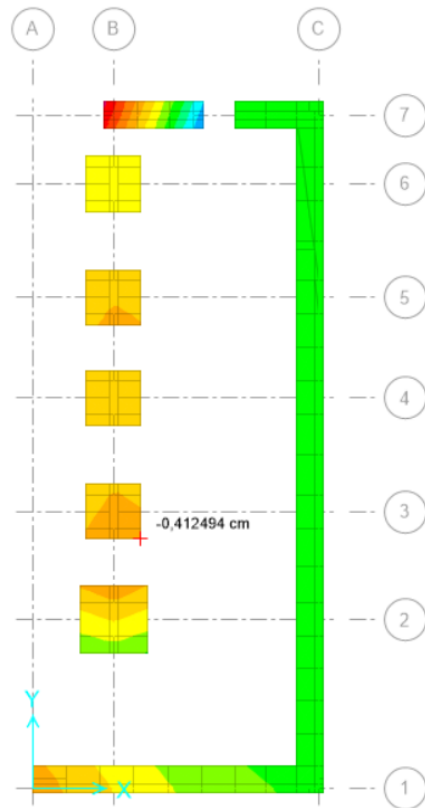
Figura 143. Asentamiento total admisible. SAFE V.2016.
