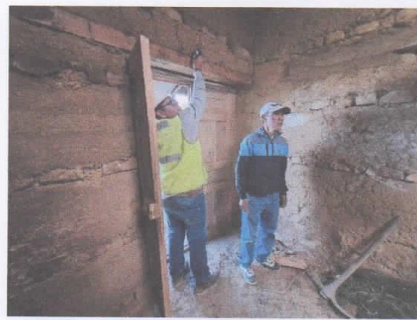
Medición con distanciómetro Laser en interiores
