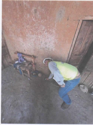
Medición de altura de muro con distanciómetro Laser
