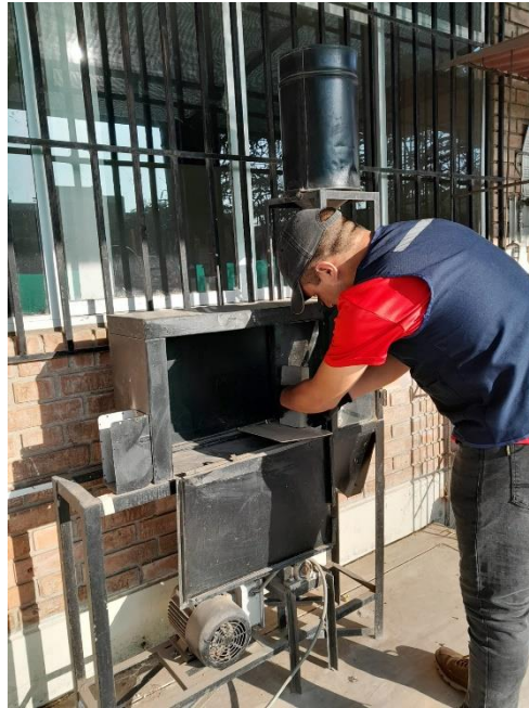
Fotografía 15: Colocación de adoquín en ensayo de desgaste
