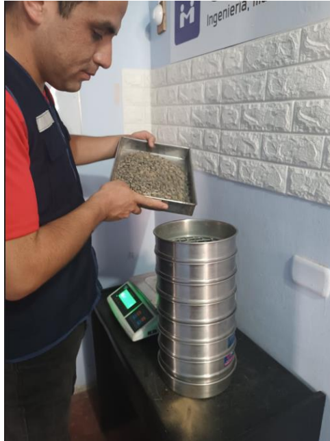
Fotografía 1: Colocación de material granular para granulometría
