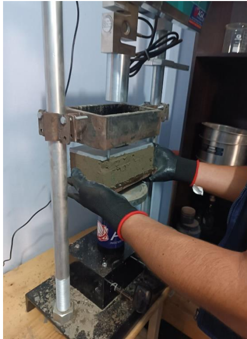
Fotografía 13: Adoquín con dimensiones 20 x 10 x 6 cm
