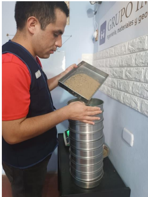
Fotografía 3: Colocación de material fino para granulometría
