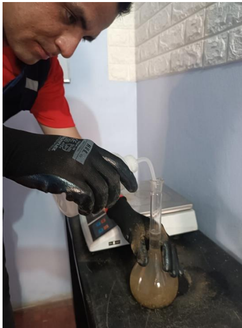
Fotografía 7: Ensayo de peso específico del agregado
