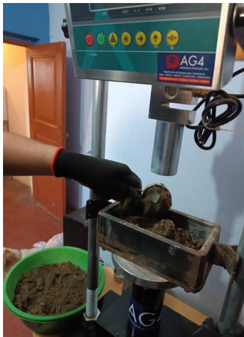
Fotografía 12: Colocación de mezcla en el molde de adoquín
