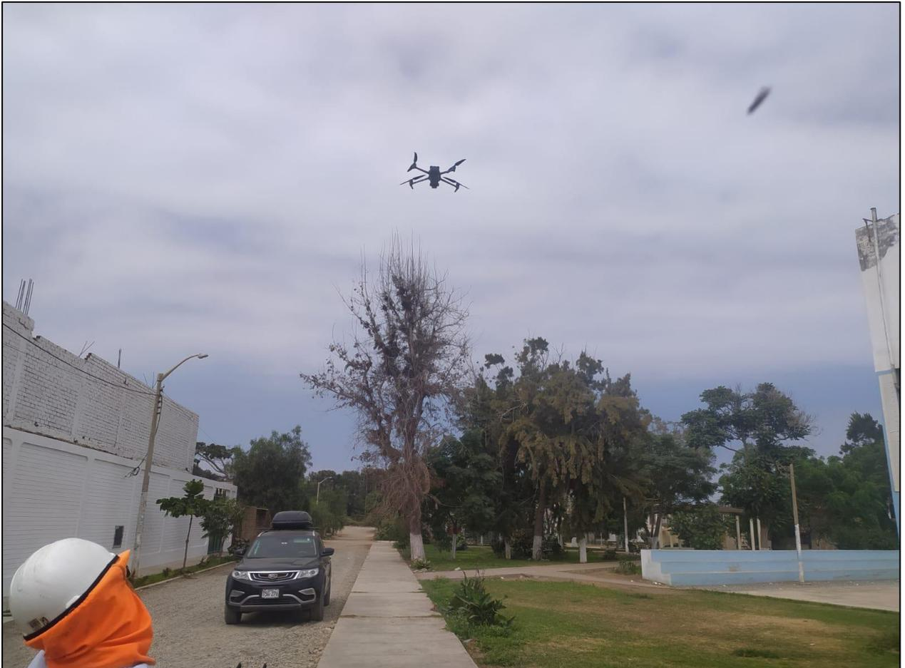
El dron de forma automática realiza el recorrido previamente ingresado mientras realiza la toma de fotos en cada momento para su posterior procesamiento con el programa Pixy4D
