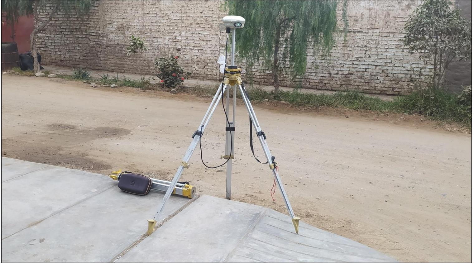
Montaje del equipo GPS Diferencial Trimble Modelo R8-3 para la toma de BM.
