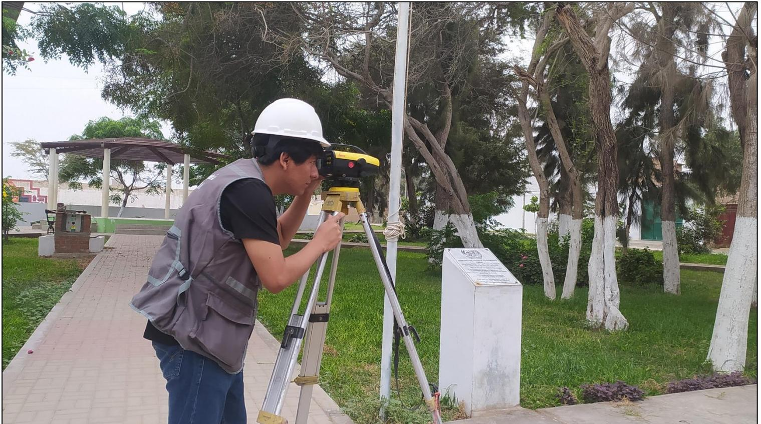
Elaboración de la poligonal para establecer puntos de apoyo para el levantamiento y elaboración de planos.
