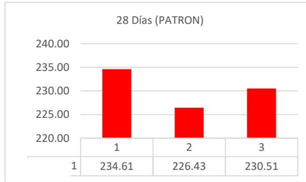
Fig.9 Resistencia a la compresión axial del concreto patrón a la edad de 28 días.
