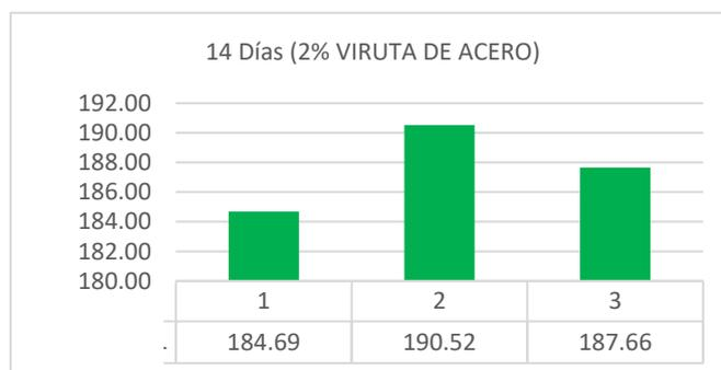
Fig.6 Resistencia a la compresión axial del concreto 2% de viruta de acero a la edad de 14 días.
