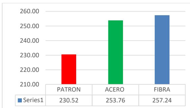
Fig.12 Resistencia ensayos a la compresión axial del concreto, añadiendo 2% de viruta de acero y añadiendo 2% de fibra de vidrio a la edad de 28 días.
