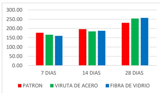
Fig.13 Resistencia ensayos a la compresión axial del concreto, añadiendo 2% de viruta de acero y añadiendo 2% de fibra de vidrio a la edad de 7,14 y 28 días.
