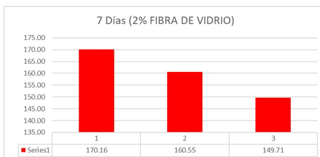
Fig.3 Resistencia a la compresión axial del concreto 2% de fibra de vidrio a la edad de 7 días.
