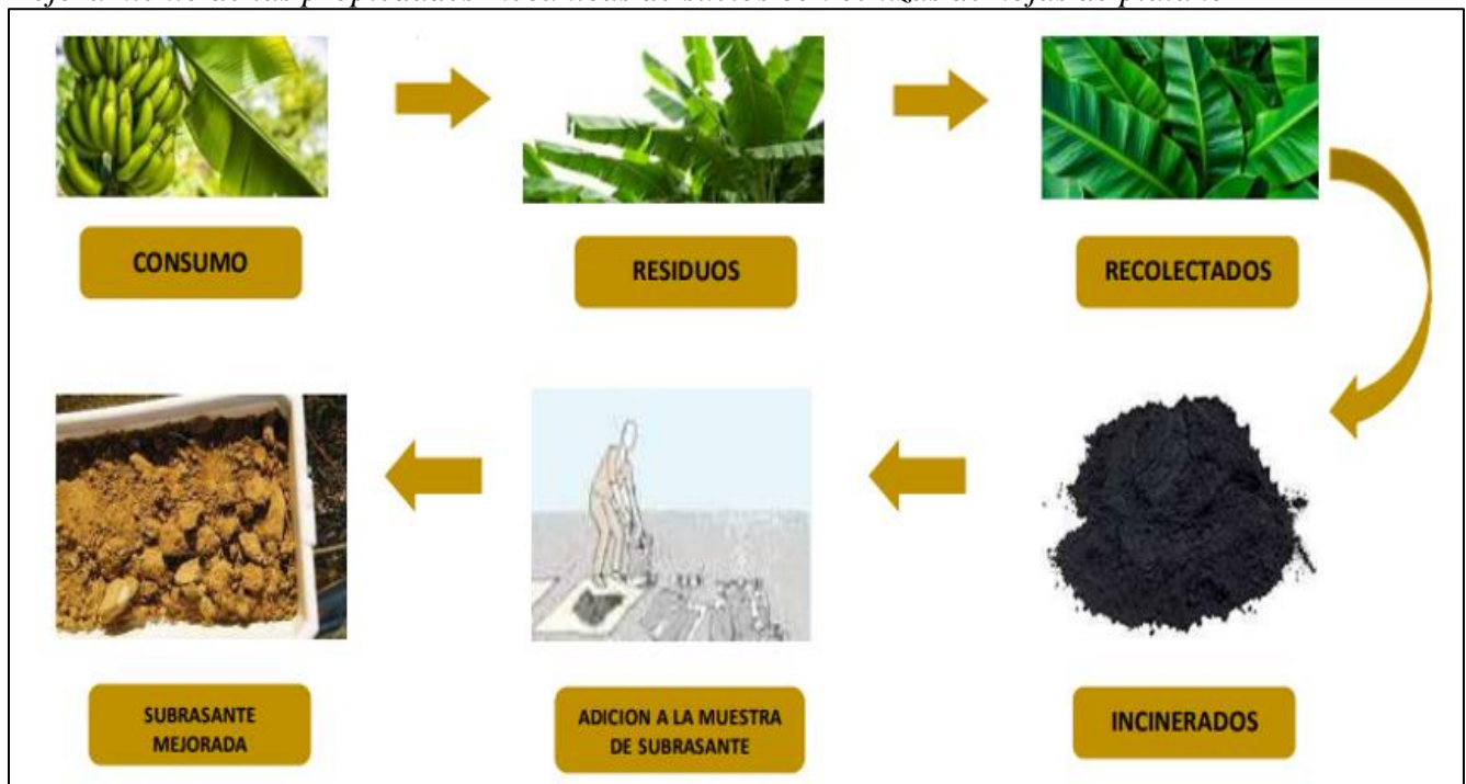
Figura 53 Mejoramiento de las propiedades mecánicas de suelos con cenizas de hojas de plátano
