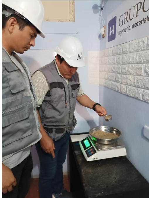
Figura 17: Pesado de agregado fino para la elaboración del adoquín
