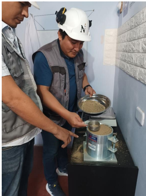
Figura 10: Ensayo de peso unitario del agregado fino
