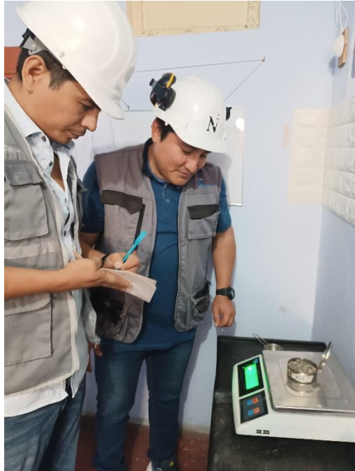
Figura 13: Ensayo de contenido de humedad de agregado grueso
