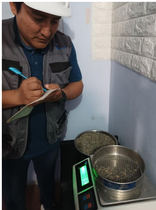
Figura 4: Pesado de agregado grueso retenido en cada malla
