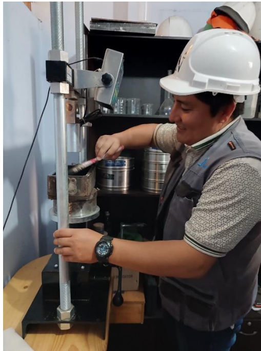
Figura 23: Engrasado del molde de adoquín
