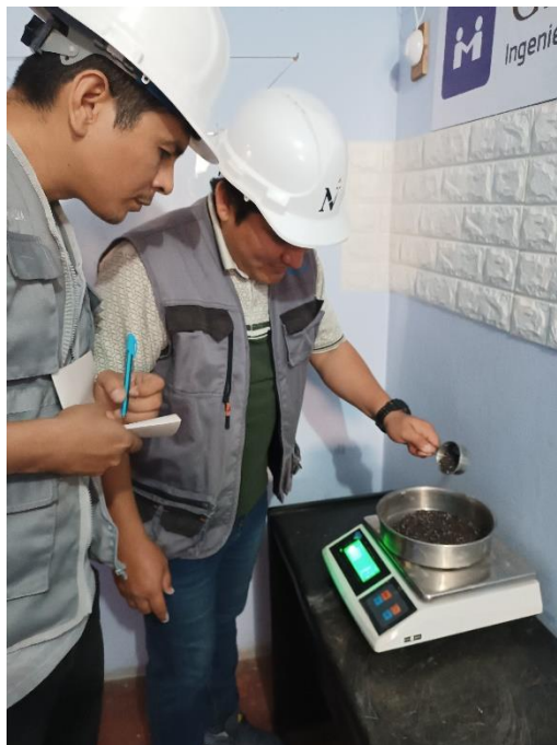
Figura 20: Pesado de reciclado de acero para la elaboración del adoquín
