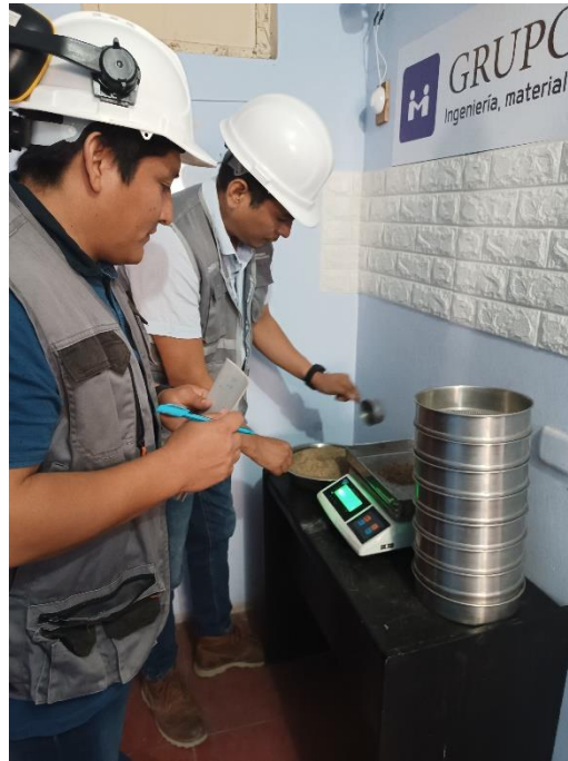
Figura 5: Pesado de agregado fino para ensayo de granulometría
