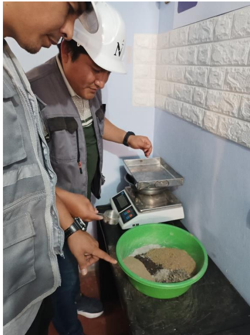
Figura 22: Mezclado para la elaboración del adoquín con adición de reciclado de acero
