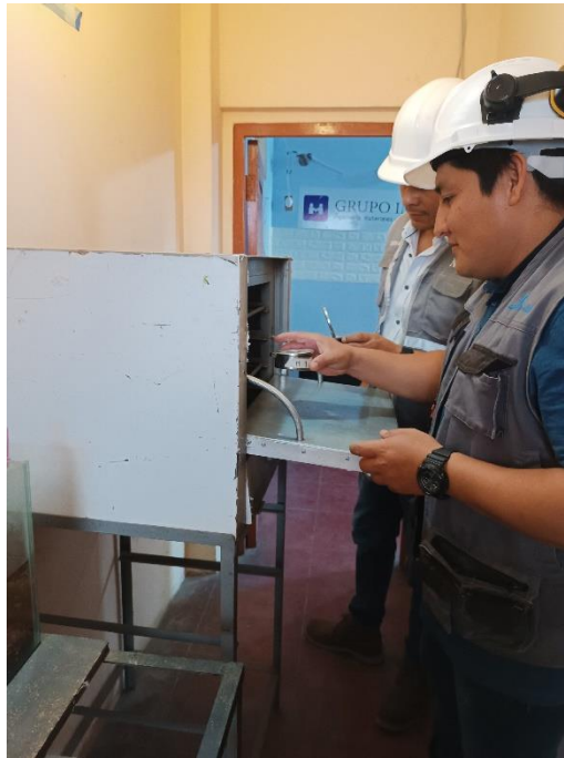
Figura 15: Colocando en horno para secado de ensayo de contenido de humedad
