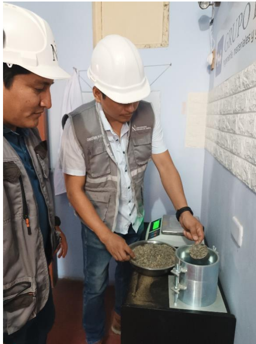
Figura 7: Ensayo de peso unitario del agregado grueso
