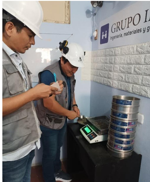
Figura 1: Pesado de agregado grueso para ensayo de granulometría
