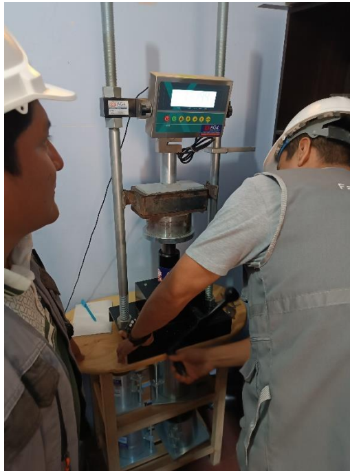
Figura 25: Prensado de adoquín
