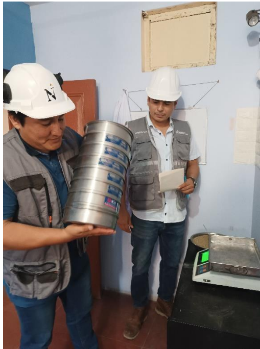
Figura 3: Ensayo de granulometría por tamizado
