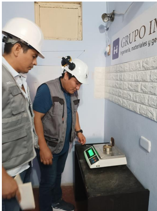
Figura 14: Ensayo de contenido de humedad de agregado fino
