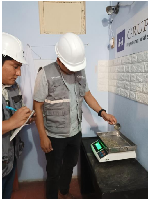
Figura 18 Pesado de agregado grueso para la elaboración del adoquín
