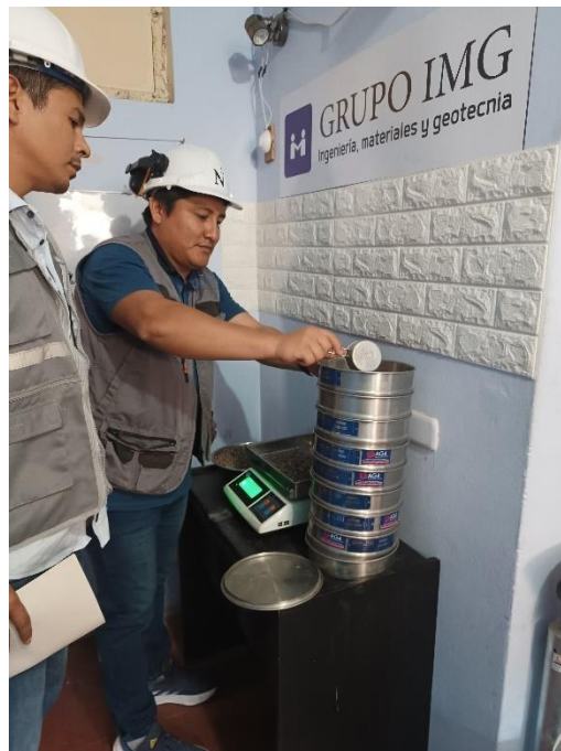
Figura 2: Agregando el material a las mallas para el ensayo de granulometría
