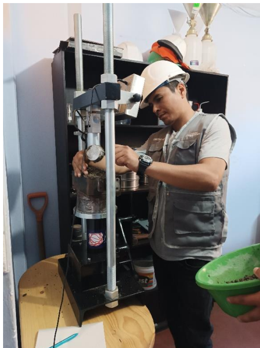
Figura 24: Agregando la mezcla para la conformación del adoquín
