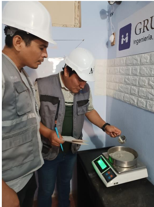
Figura 19: Pesado del cemento para la elaboración del adoquín
