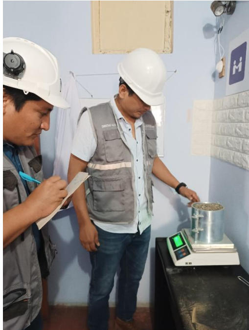
Figura 9: Ensayo de peso unitario del agregado grueso
