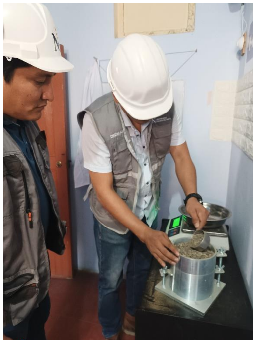
Figura 8: Ensayo de peso unitario del agregado grueso
