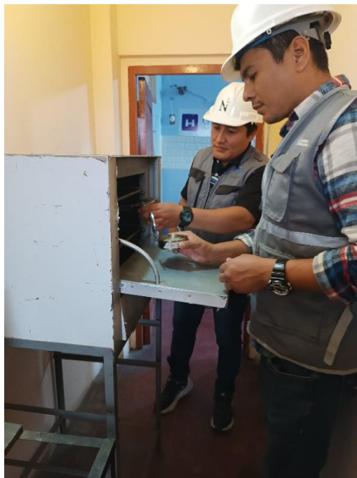
Figura 16: Retirando las muestras del horno del ensayo de contenido de humedad
