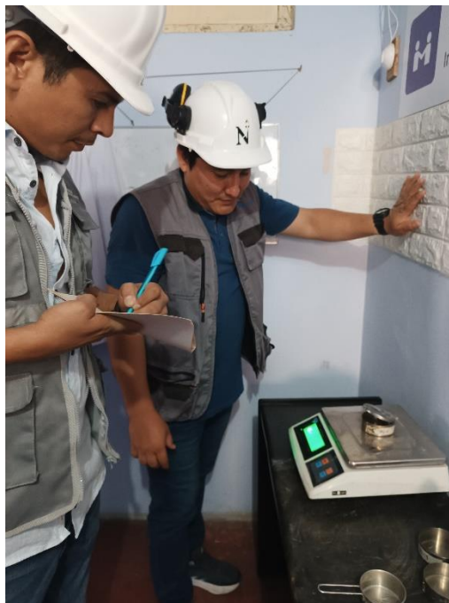
Figura 12: Pesado de recipiente para ensayo de contenido de humedad natural
