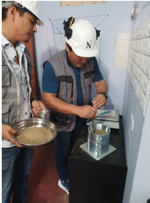
Figura 11: Ensayo de peso unitario compacto del agregado fino
