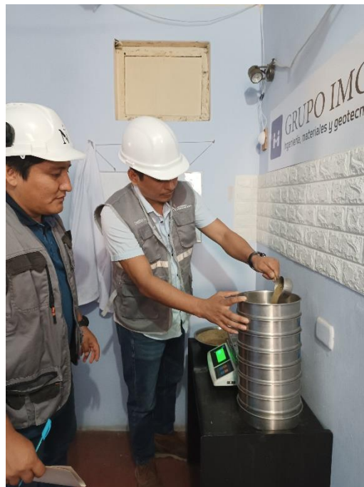
Figura 6: Agregando el material a las mallas
