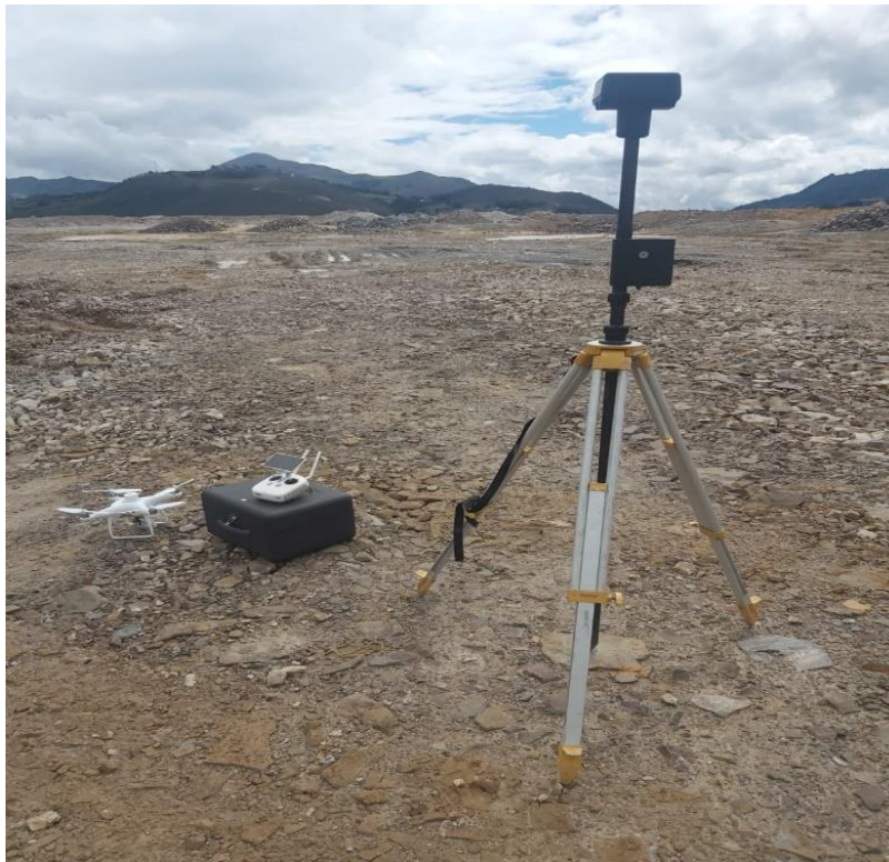
Figura 7. Paso 1, equipos para el procedimiento del levantamiento topográfico
