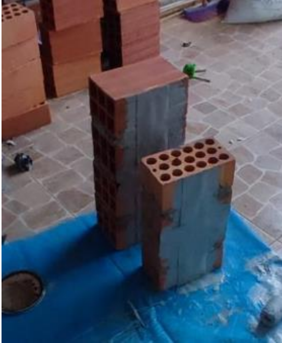
ANEXO N°6. Reforzamiento con malla electrosoldada en muretes de pandereta y King Kong
