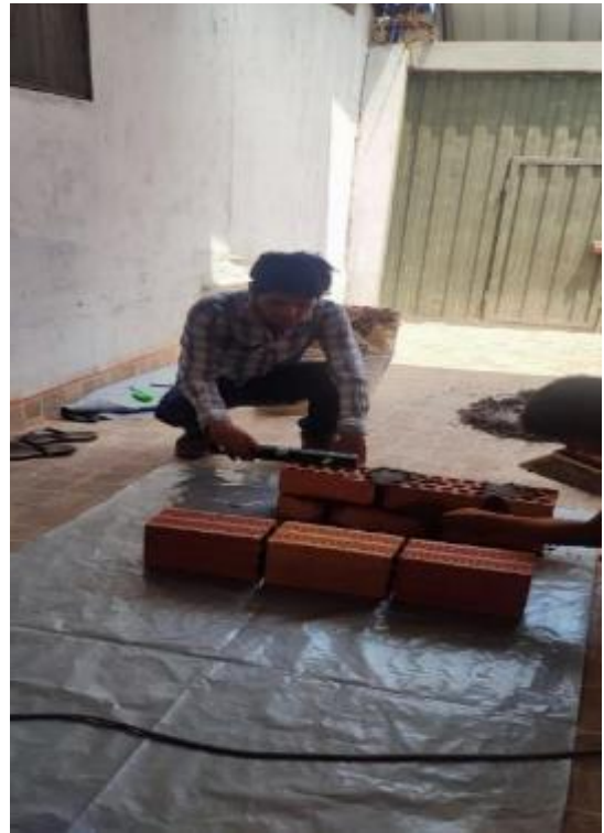
ANEXO N°5. Proceso de elaboración de muretes con 1.5 cm de junta
