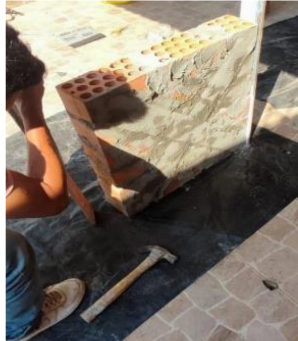
ANEXO N°6. Reforzamiento con malla electrosoldada en muretes de pandereta y King Kong
