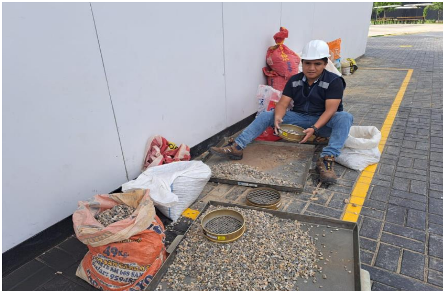
Figura 28. Tamizado de la grava.
