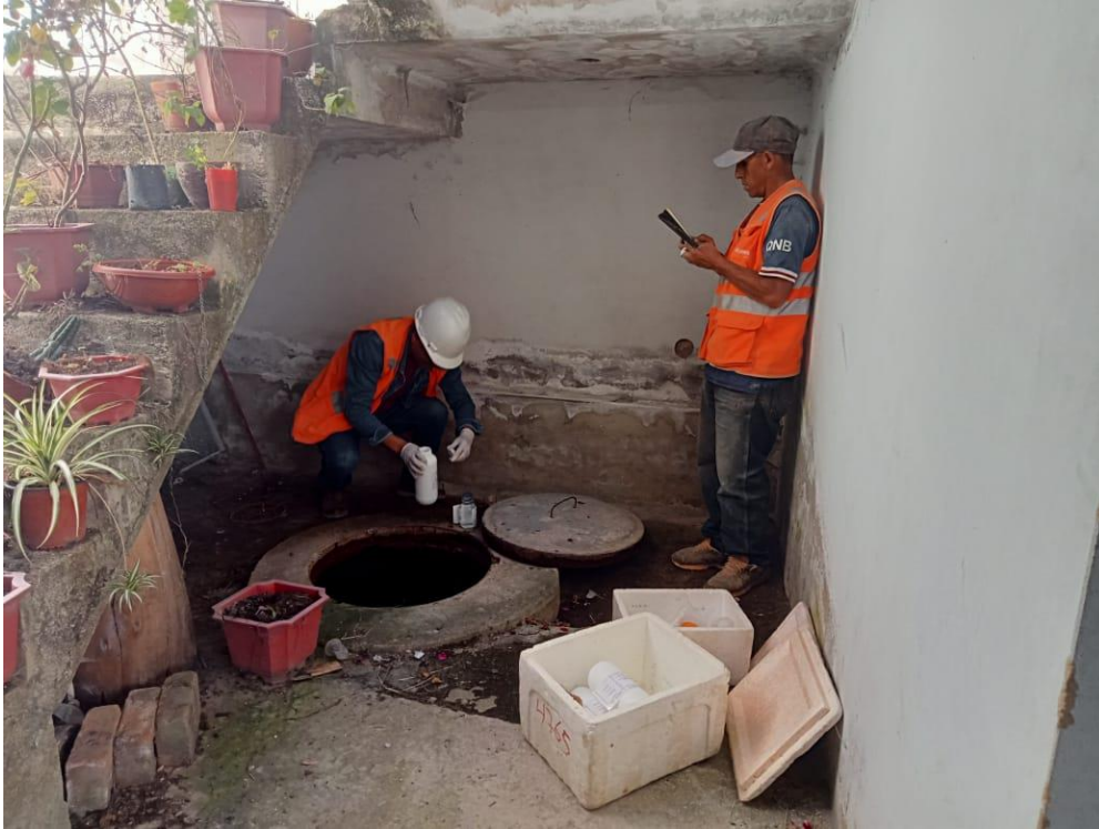
Foto 12: Realizando la toma de muestras de agua del pozo 05.
