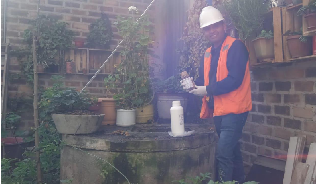
Foto 4: Pozo N°01. Realizando la toma de muestras de agua.
