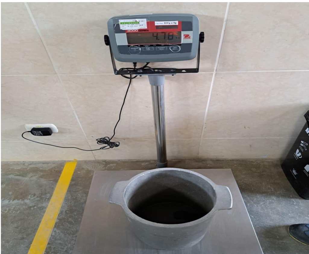
Fotografía N° 8: en el laboratorio de concreto de la UPN realizando el pesado o tarado de los equipos para realizar los ensayos de peso específico del agregado grueso.
