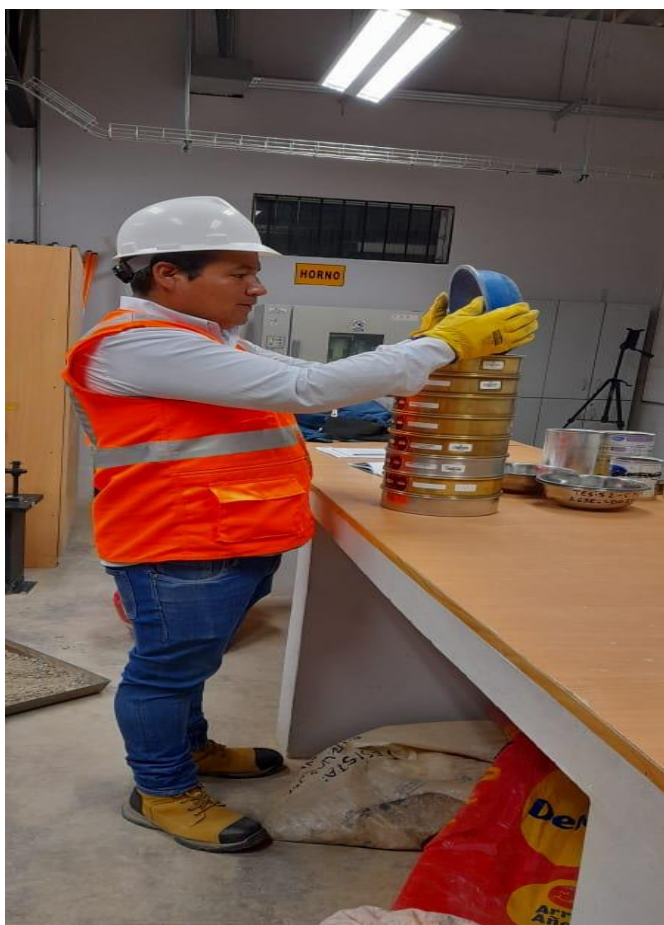
Fotografía N° 6: en el laboratorio de concreto de la UPN realizando en tamizado de los agregados.
