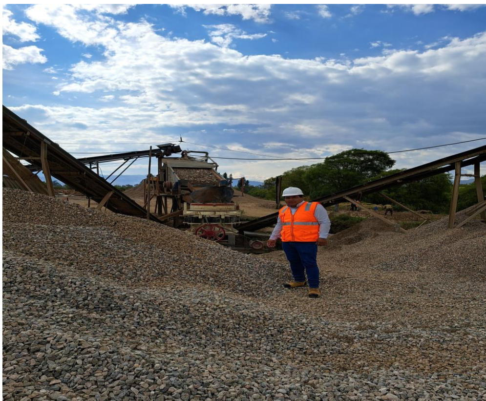
Fotografía N° 1: en la cantera de los hermanos Alaya ubicada en el sector la victoria donde realizan el lavado y extracción de agregados grueso y fino.
