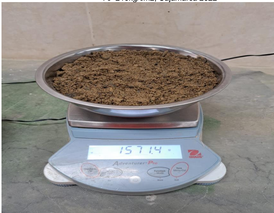
Fotografía N° 9: en el laboratorio de concreto de la UPN realizando el pesado del agregado fino para realizar el peso específico del material.
