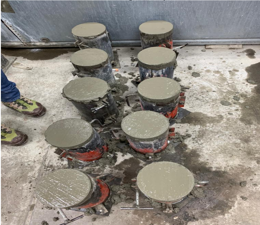
Fotografía N° 25: realizando el llenado de las probetas con la incorporación del mucilago.
