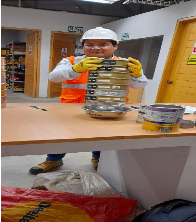
Fotografía N° 7: en el laboratorio de concreto de la UPN realizando en tamizado de los agregados.
