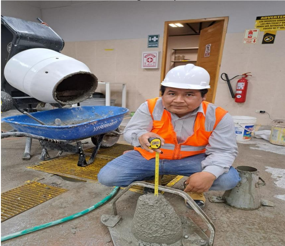
Fotografía N° 21: realizando la medición del asentamiento del concreto Slump.
