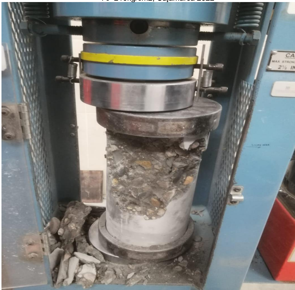
Fotografía N° 31: realizando el ensayo a compresión de los testigos en el laboratorio de la UPN.
