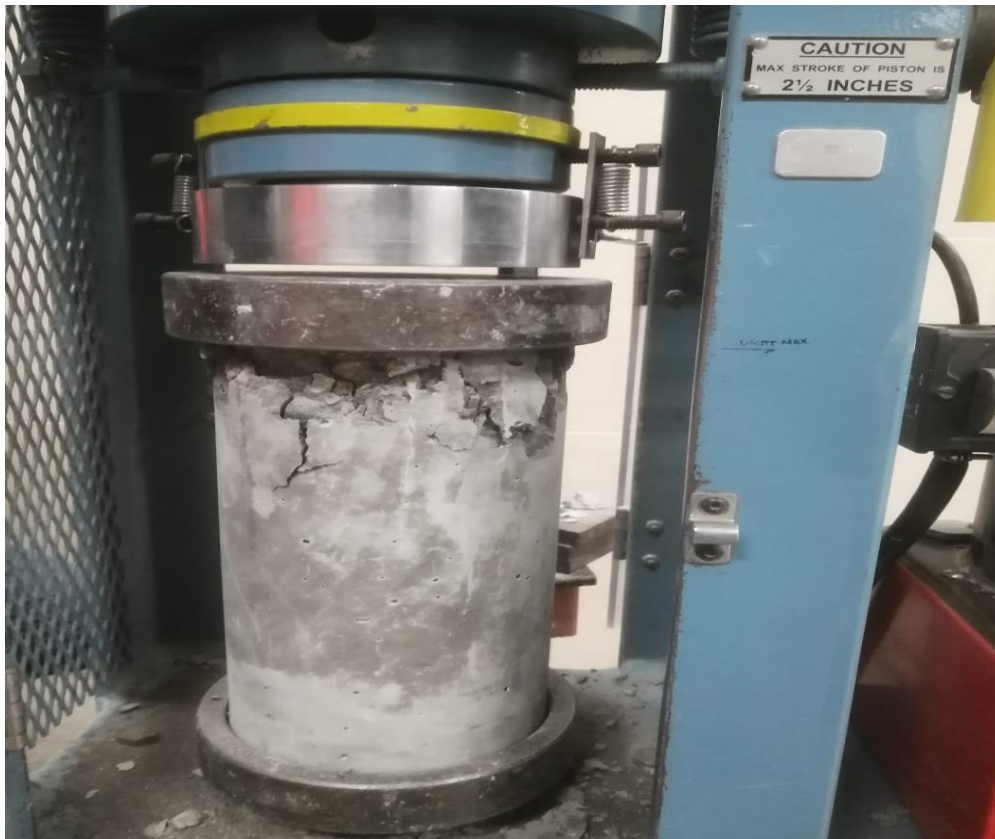
Fotografía N° 28: Realizando la rotura de los testigos en la prensa hidráulica realizando el ensayo a compresión de los testigos.
