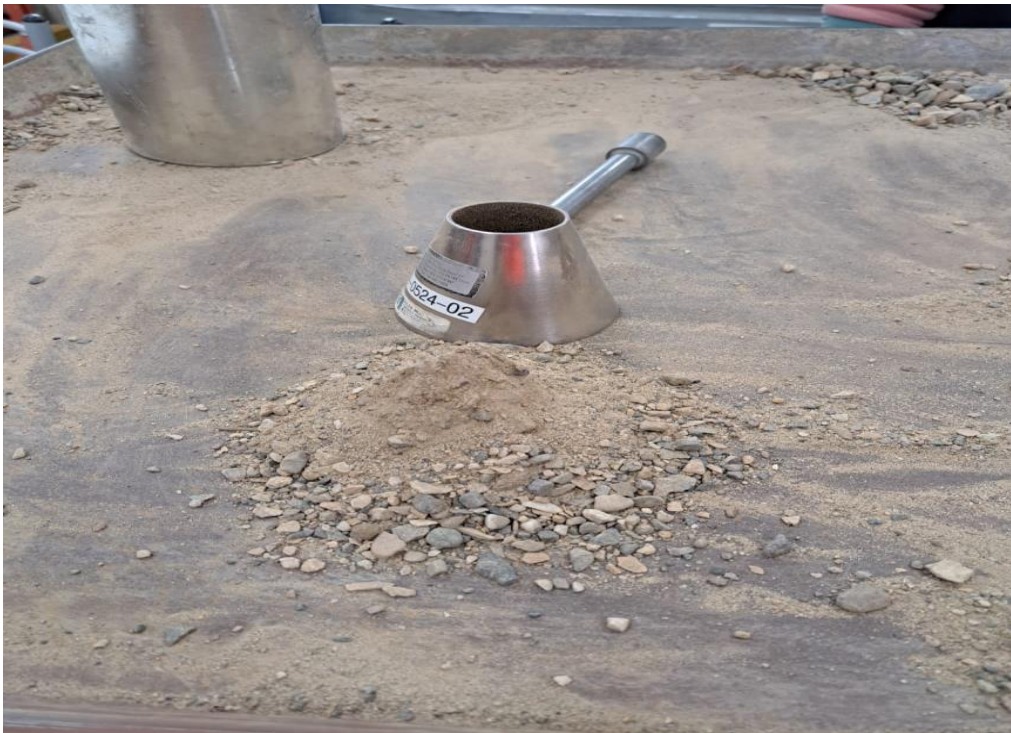
Fotografía N° 12: en el laboratorio de concreto de la UPN realizando el ensayo con el agregado fino.
