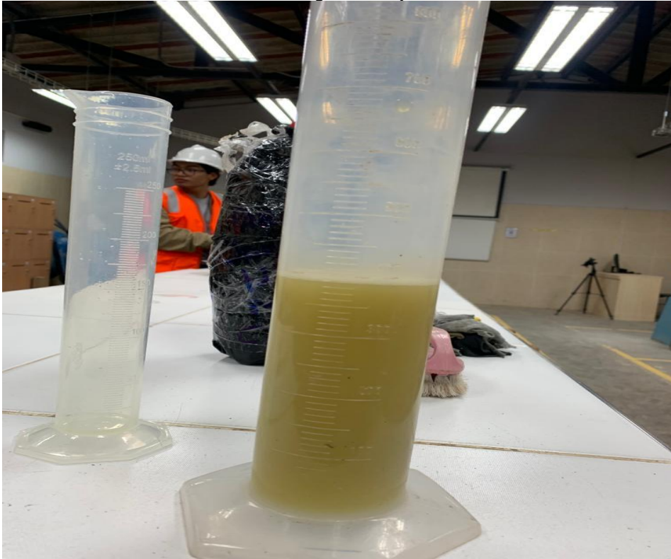
Fotografía N° 19: realizando la debida dosificación del mucilago de Stenocereus Prinosus para añadirlo al agua con la que se preparara el concreto.
