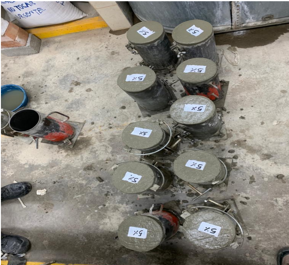
Fotografía N° 22: realizando el llenado de las probetas con la incorporación del 5% del mucilago.
