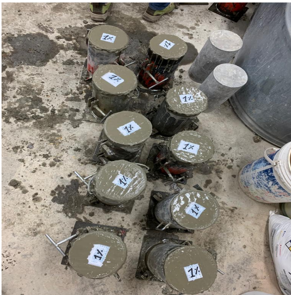
Fotografía N° 24: realizando el llenado de las probetas con la incorporación del 1% del mucilago.
