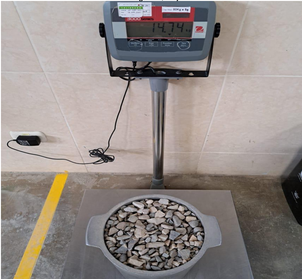
Fotografía N° 11: en el laboratorio de concreto de la UPN realizando el pesado del agregado grueso para realizar los ensayos de peso específico del agregado grueso.
