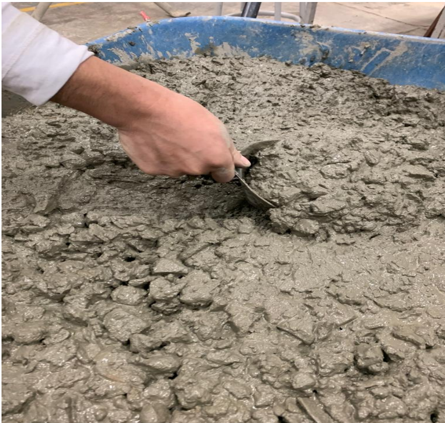
Fotografía N° 26: realizando el llenado de las probetas con la incorporación del mucilago.
