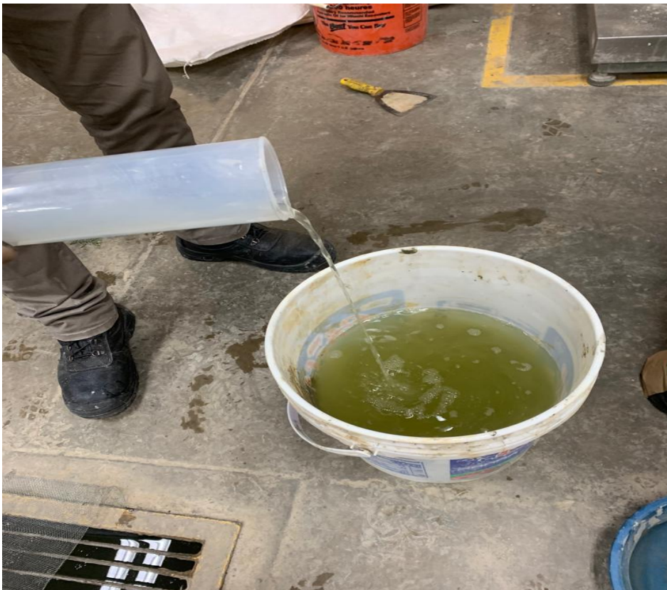
Fotografía N° 20: mezclando con el agua mucilago de Stenocereus Prinosus para añadirlo a la preparación del concreto.
