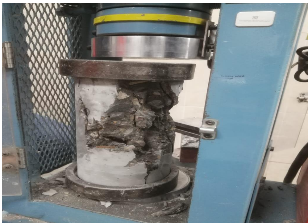
Fotografía N° 30: realizando el ensayo a compresión de los testigos en el laboratorio de la UPN.
