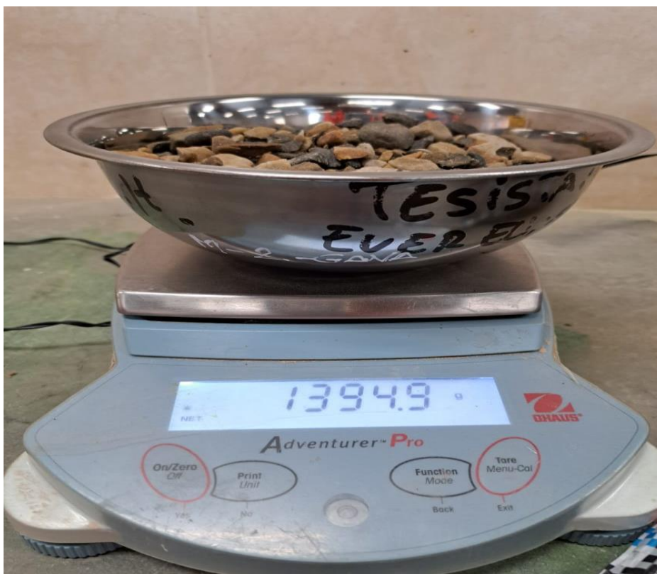
Fotografía N° 10: en el laboratorio de concreto de la UPN realizando el pesado del agregado grueso para realizar el peso específico del material.
