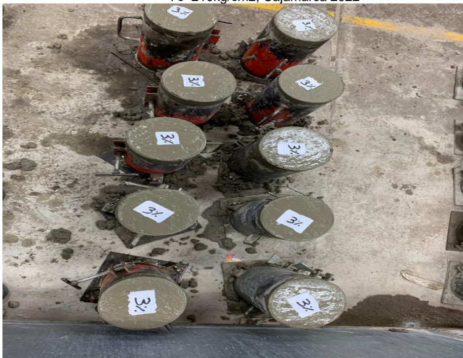
Fotografía N° 23: realizando el llenado de las probetas con la incorporación del 3% del mucilago.
