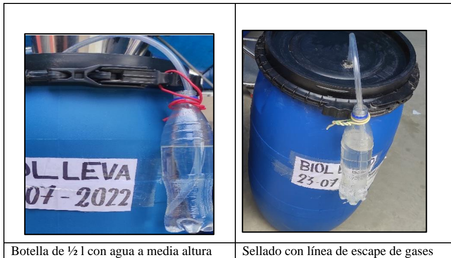
Figura 6. Armado del sistema anaerobio en cilindros de capacidad de 60 l
