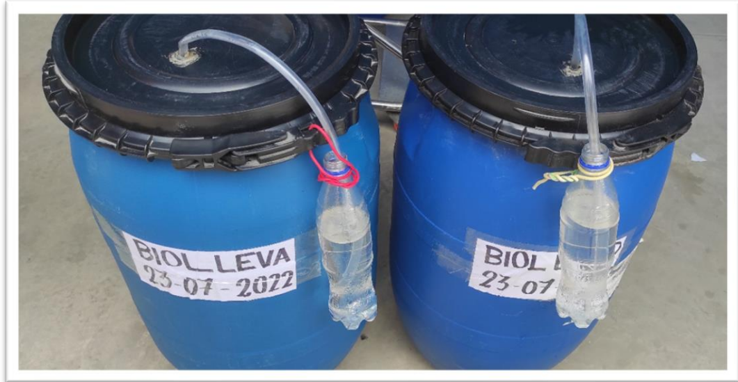
Imagen 1. Biol LEVA y Biol BACID sellados herméticamente y con sistema de escape de gases
