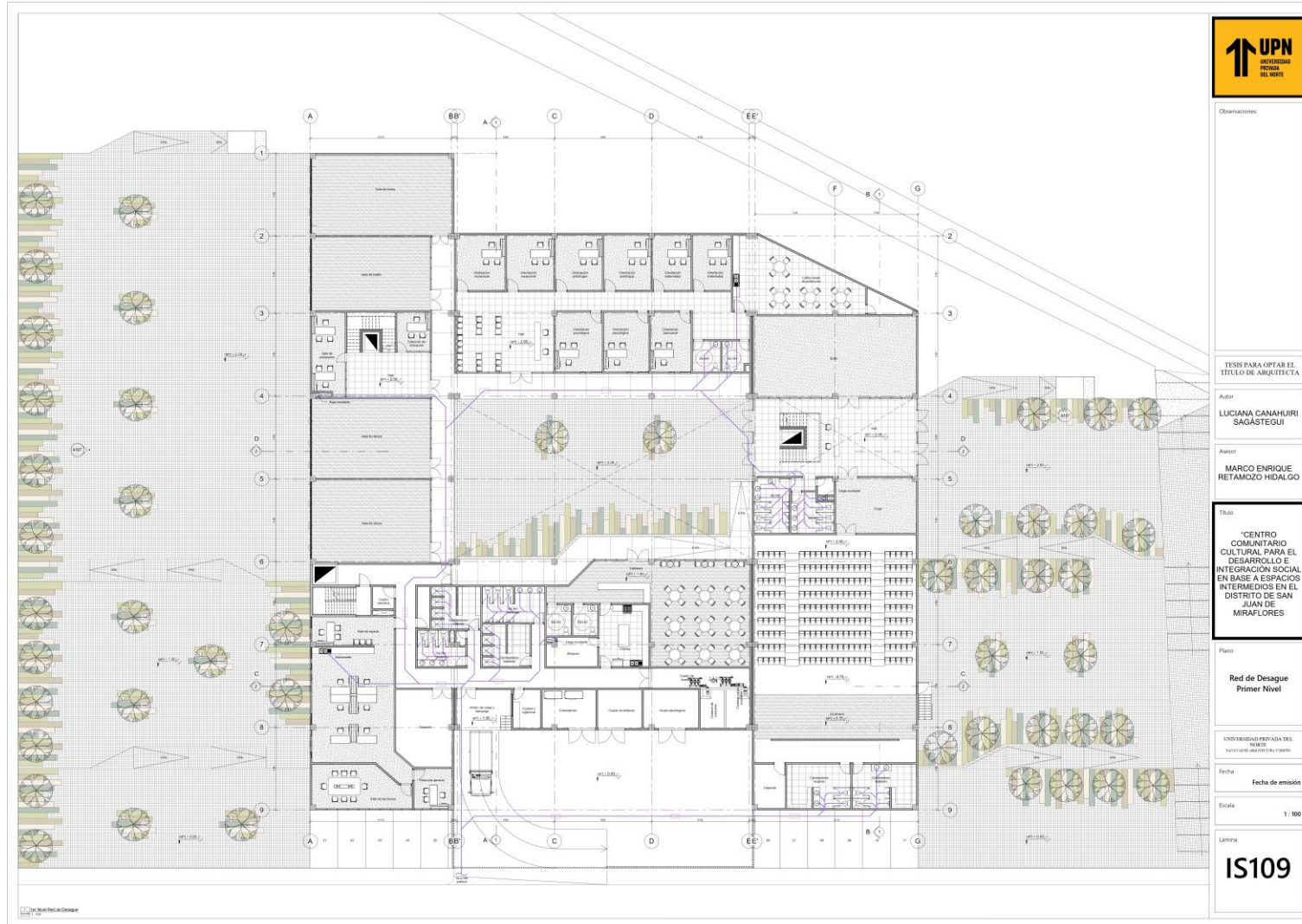
Figura 80. Red de Desagüe Primer Nivel.
