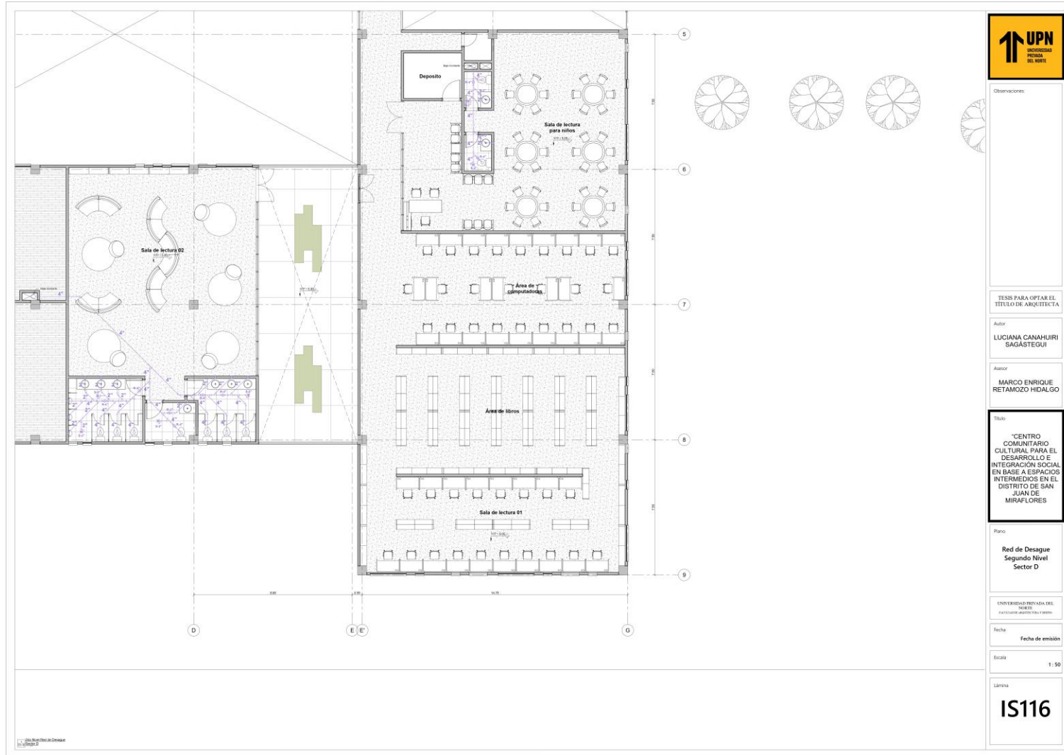
Figura 87. Red de Desagüe Segundo Nivel Sector D.
