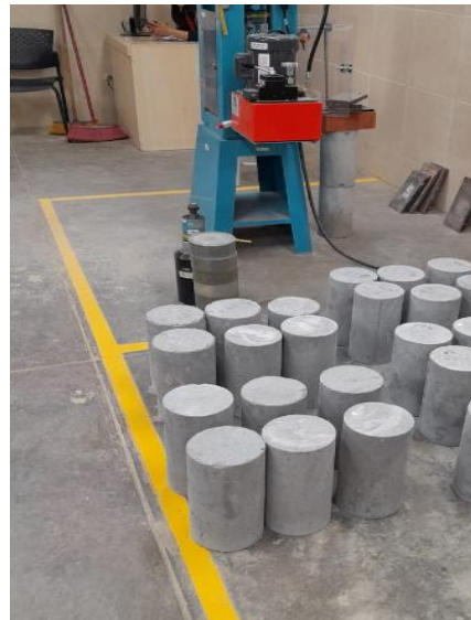
Figura 14. Probetas listas para en ensayo a resistencia a compresión.
