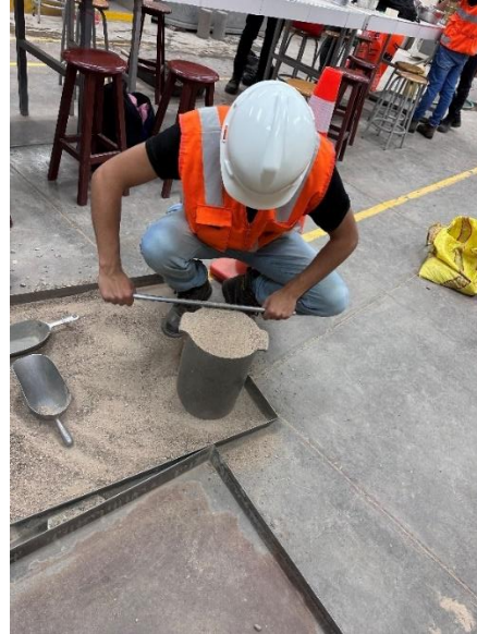
Figura 7. Enrazado de la muestra para el peso unitario del agregado fino.
