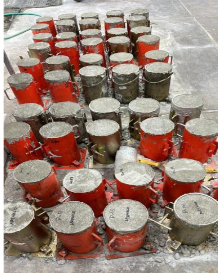
Figura 11. Moldes de 15 cm x 30 cm para probetas de concreto.
