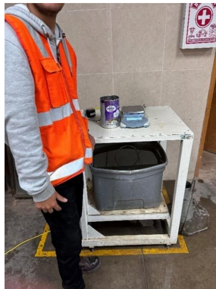
Figura 6. Prueba de peso específico y absorción del agregado grueso.
