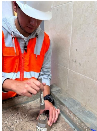
Figura 4. Uso del molde cónico para ver si el agregado fino alcanza la condición de superficie seca.
