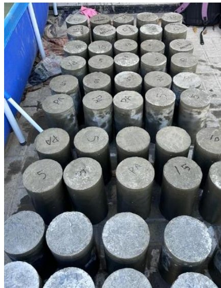
Figura 12. Probetas de concreto curadas.
