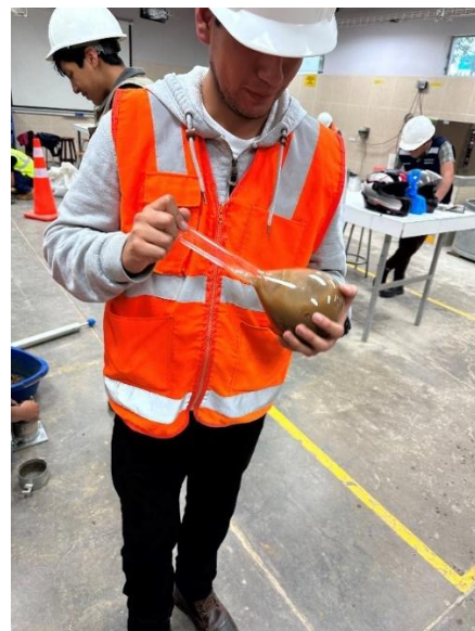
Figura 8. Prueba del peso específico y absorción del agregado fino.
