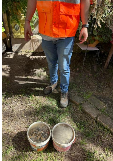
Figura 5. Agregados sumergidos 24 horas para los ensayos de peso específico y absorción del agregado.
