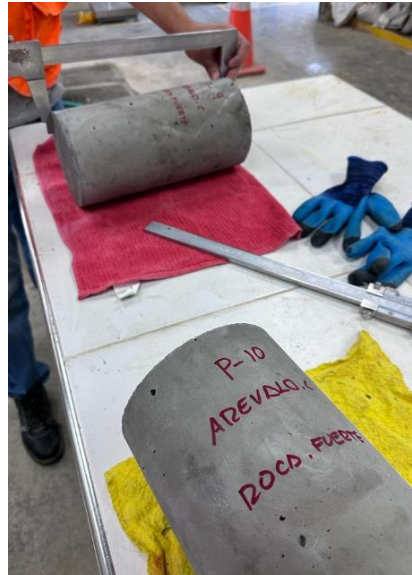
Figura 13. Medición del diámetro y altura de los especímenes cilíndricos.
