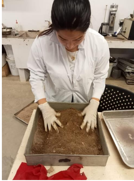
Figura 30. Mezcla de agua con terreno
