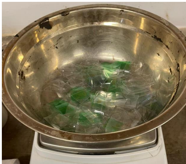
Figura 65. Plástico PET en forma romboidal (2-3 cm)
