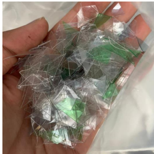
Figura 69. Plástico PET en forma romboidal (5mm)
