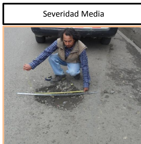
Bache de alta severidad, ubicado en la unidad de muestra U23, sección 4.
