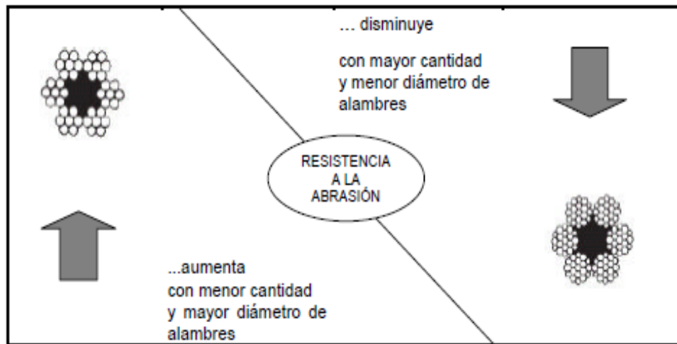
Fig. N°. 19: Influencia de cantidades y diámetro de los alambres en la resistencia a la abrasión.
