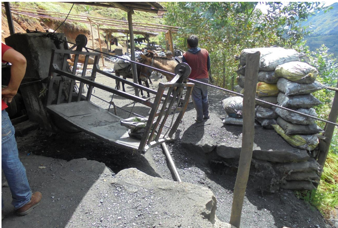
FOTO N° 4: Sistema de soporte de tensión de carguio
