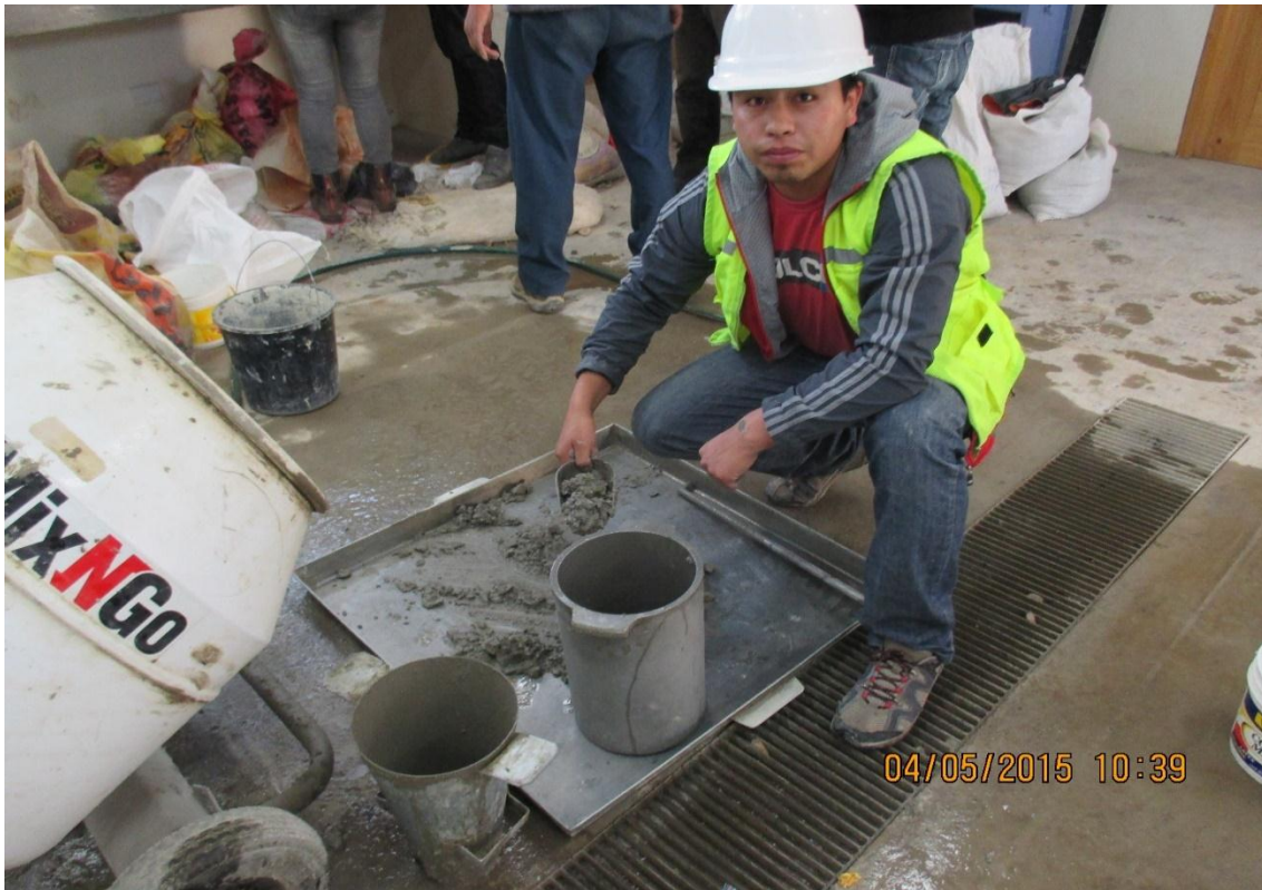
Fotografía N° 18: Se pasó a determinar el peso volumétrico del concreto se llenó en tres capas y se compactó con 25 golpes cada capa
