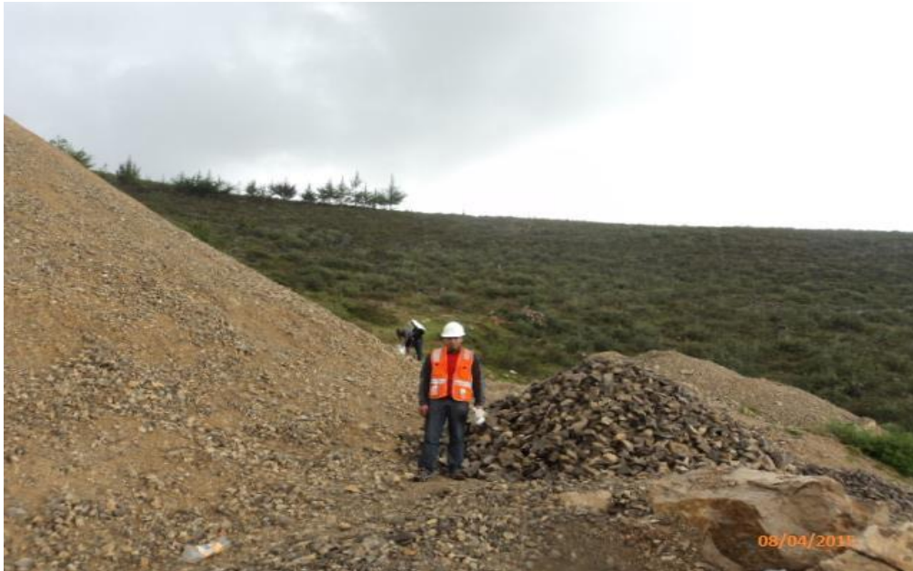
Fotografía N° 04: Chancado del agregado de roca caliza hasta convertirlo en una granulometría de 3/4"
