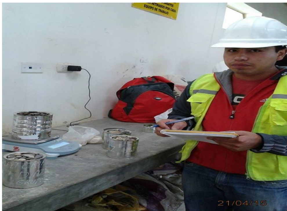
Fotografía N° 10: Peso de las muestras para obtener el contenido de humedad del agregado
