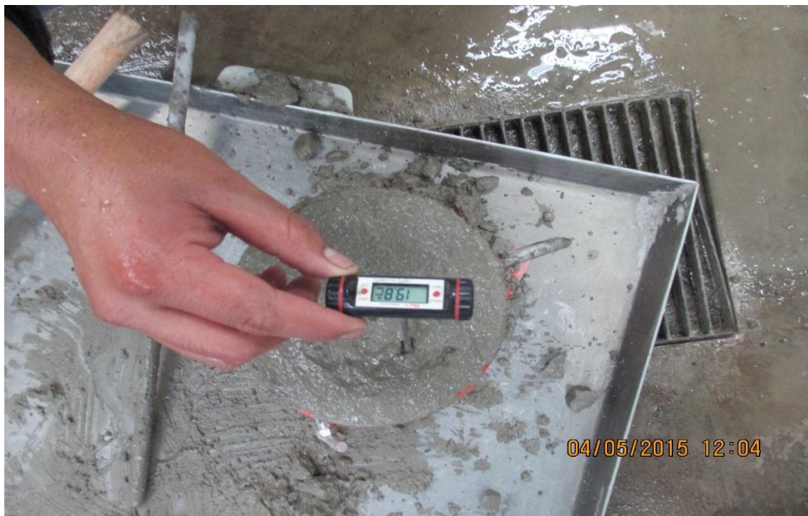
Fotografía N° 19: Se determinó la temperatura del concreto en laboratorio UPN
