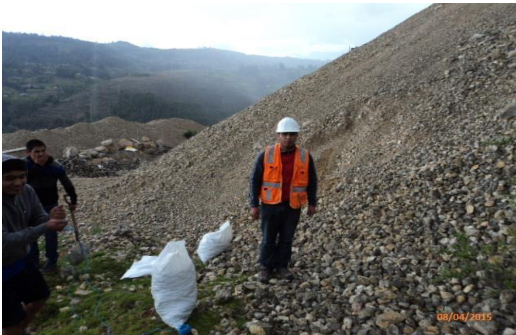
Fotografía N° 02: Muestreo de agregados de roca caliza de un tamaño máximo de 3.5", de la cantera Otuzco Mirador
