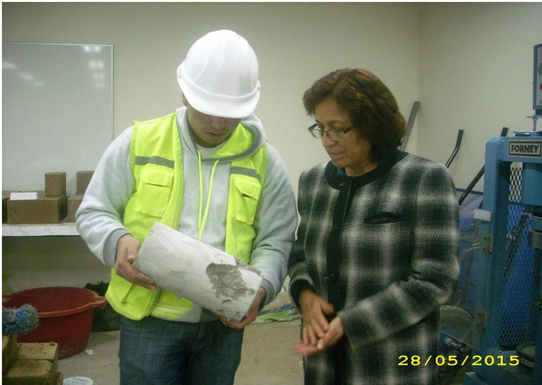
Fotografía N° 24: Analizando el tipo de falla, debido a las cargas que actuaron en la probeta falla tipo cono
