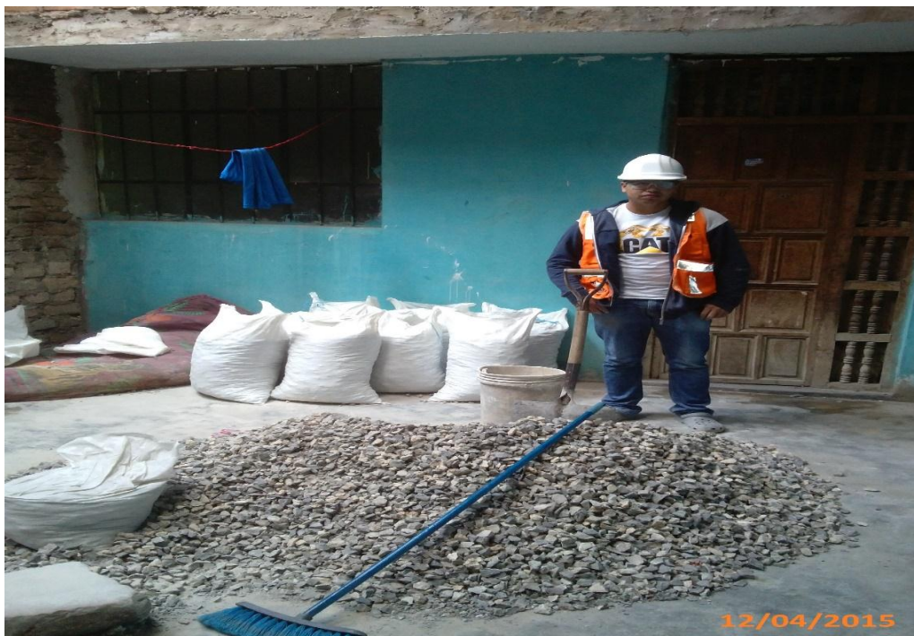
Fotografía N° 06: Una vez que se terminó de triturar el agregado, se muestreo del montón que se tenía y se transportó al laboratorio para determinar sus propiedades del agregado
