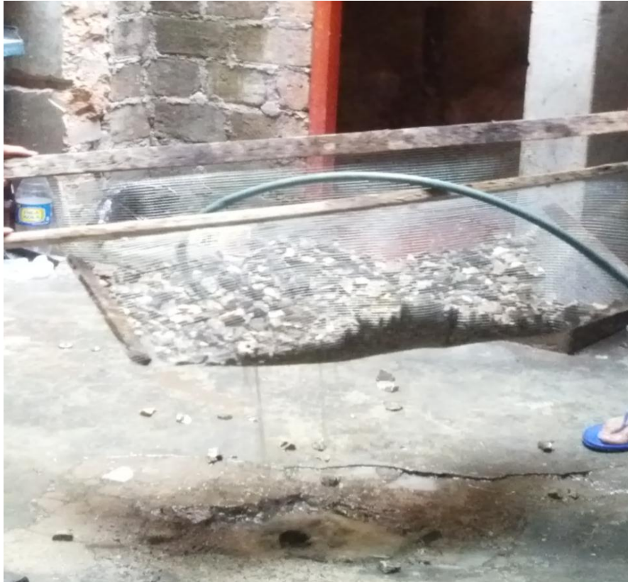
Fotografía N° 13: agregado lavado, claramente se observa el agua turbia con presencia de material fino
