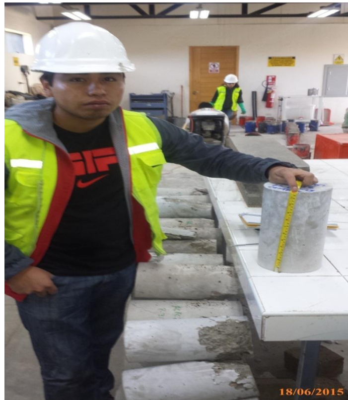
Fotografía N° 23: Ensayo de resistencia a compresión axial de muestras cilíndricas falla de la probeta por aplastamiento
