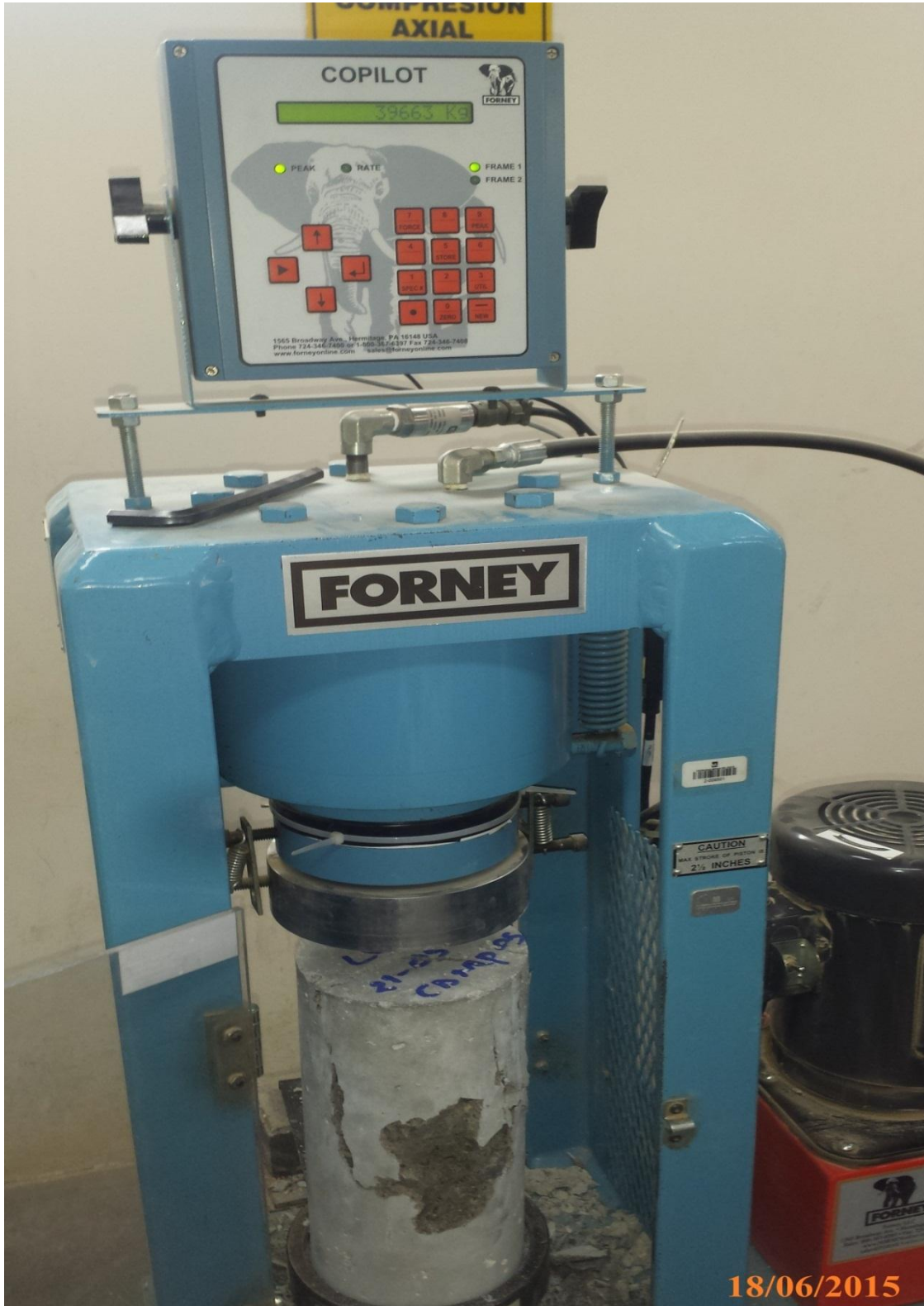
Fotografía N° 27: probeta con agregado lavado resistencia máxima alcanzada 39663.00 kg
