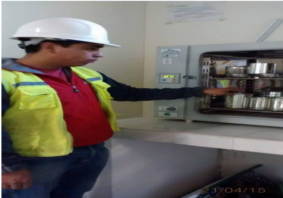
Fotografía N° 09: Obteniendo el contenido de humedad del agregado en el horno a una temperatura de 110^{\circ}\text{C} \pm 5^{\circ}\text{C}
