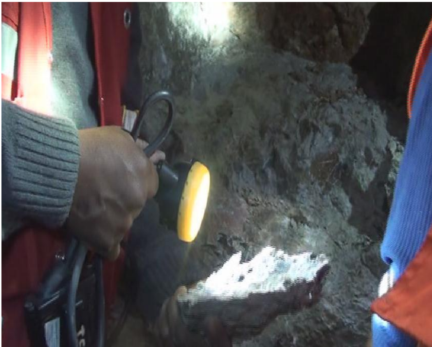
Foto N°06 Toma de muestras para el estudio de dureza del macizo rocoso.
