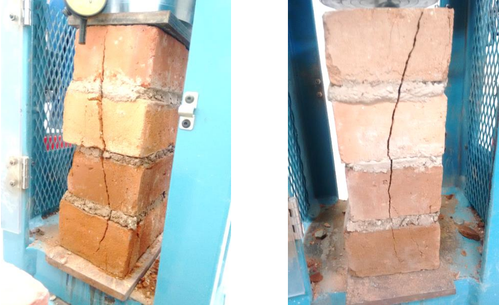
Fotografía 23: Falla típica de pilas de 1.0 cm de espesor.
