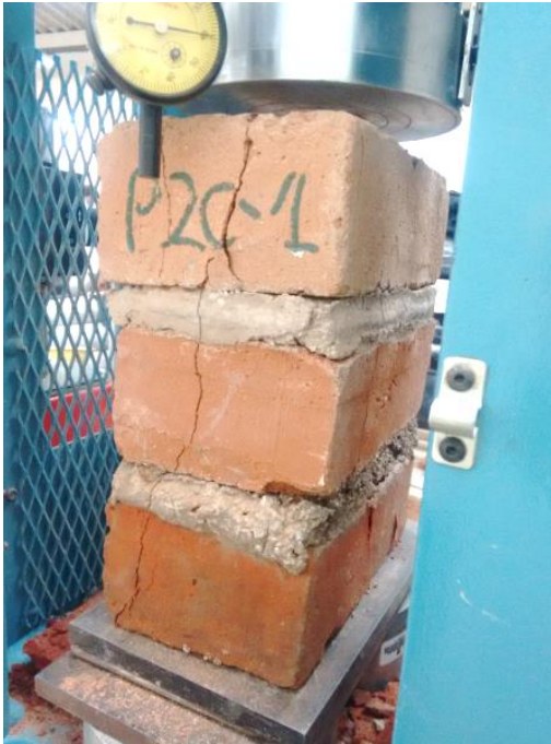
Fotografía 22: Falla típica de pilas de 1.5 cm de espesor.
