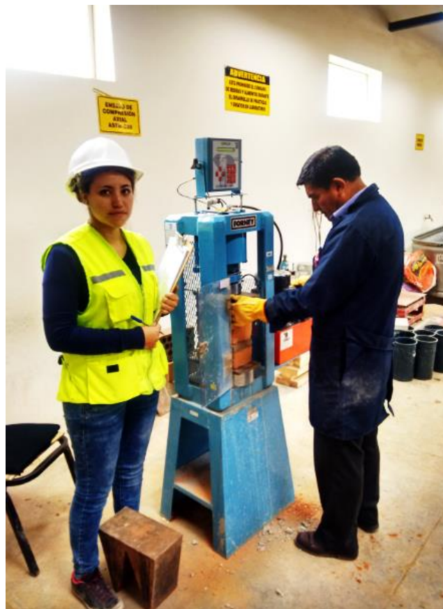
Fotografía 18: Ensayo a compresión de pilas de albañilería.
