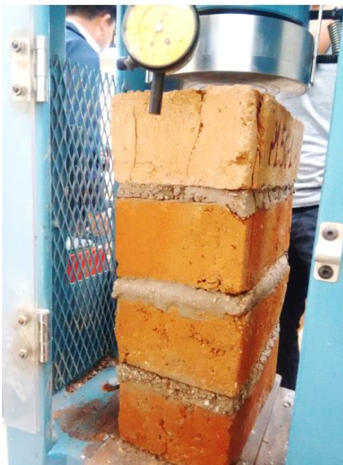
Fotografía 22: Falla típica de pilas de 1.5 cm de espesor.
