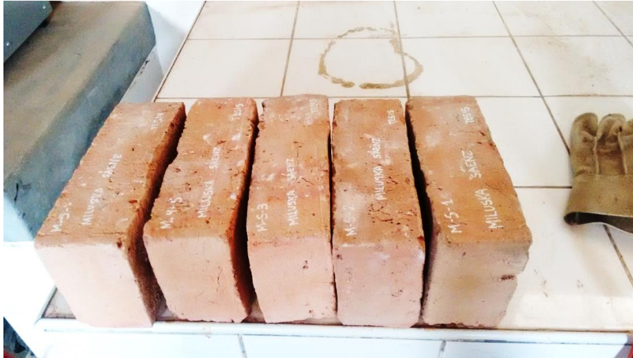
Fotografía 5: Muestras de ladrillos para el ensayo a absorción.
