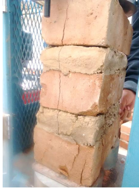
Fotografía 19: Falla típica de pilas de 4.0 cm de espesor.
