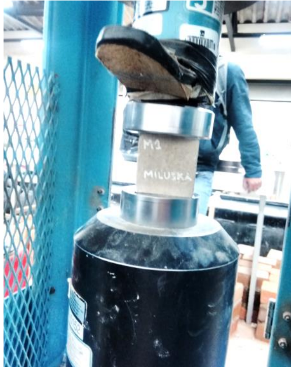
Fotografía 9: Ensayo de resistencia a compresión axial del mortero.
