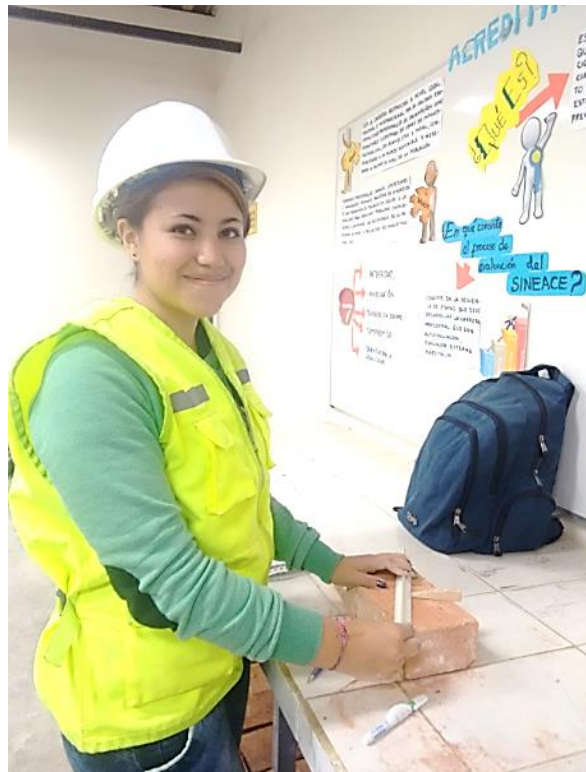
Fotografía 8: Realizando el ensayo de alabeo.
