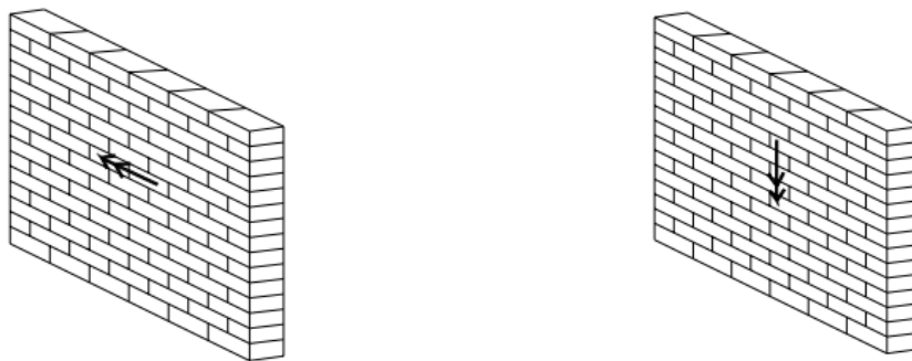
Figura N° 2: Vector momento paralelo y perpendicular a la junta.
