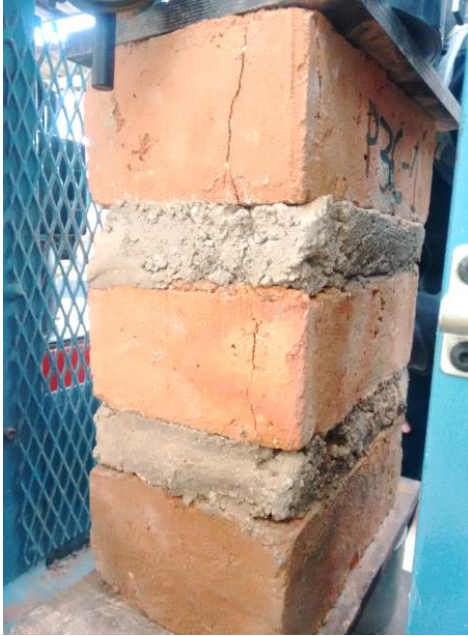
Fotografía 19: Falla típica de pilas de 4.0 cm de espesor.
