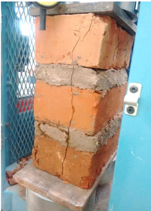
Fotografía 20: Falla típica de pilas de 3.0 cm de espesor.
