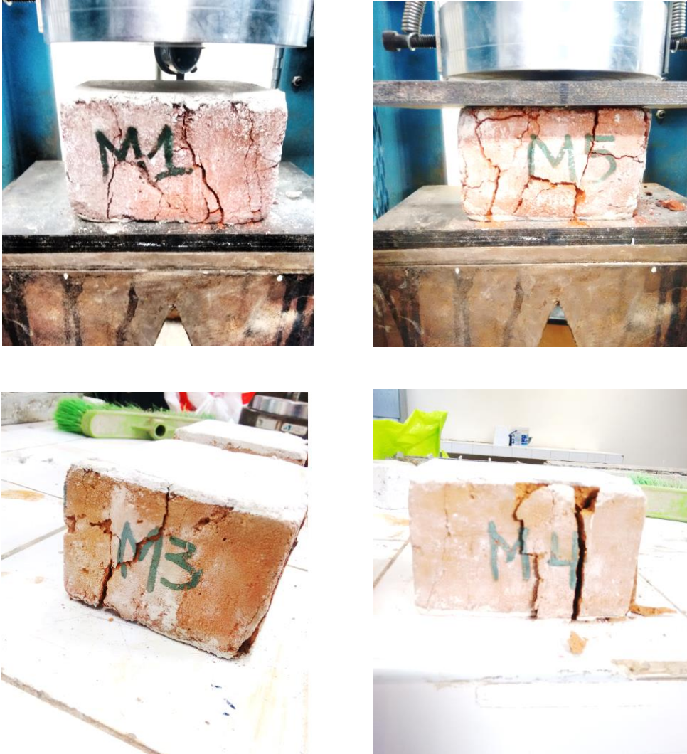
Fotografía 13: Falla en medios ladrillos artesanales.
