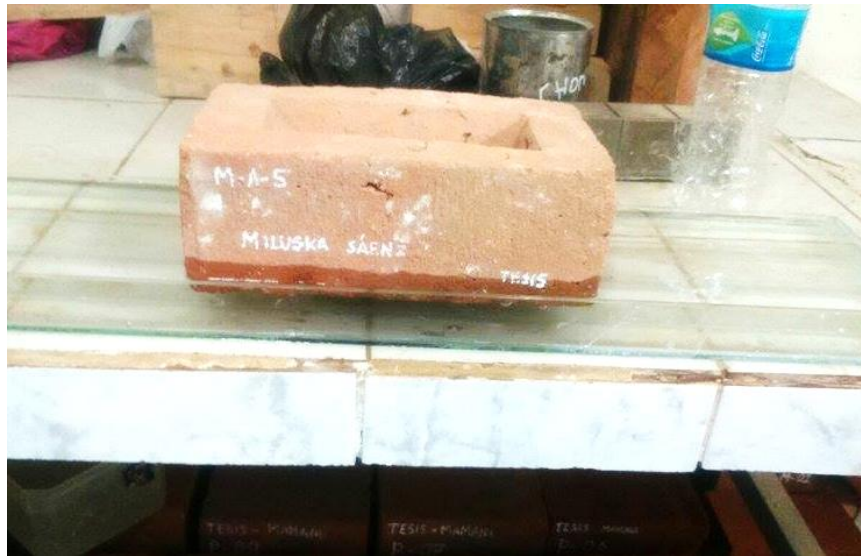
Fotografía 3: Ensayo de succión sobre bandeja rectangular.
