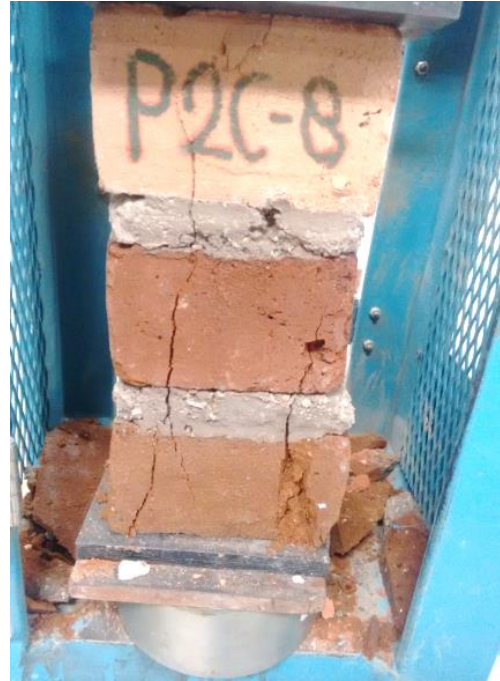
Fotografía 22: Falla típica de pilas de 1.5 cm de espesor.
