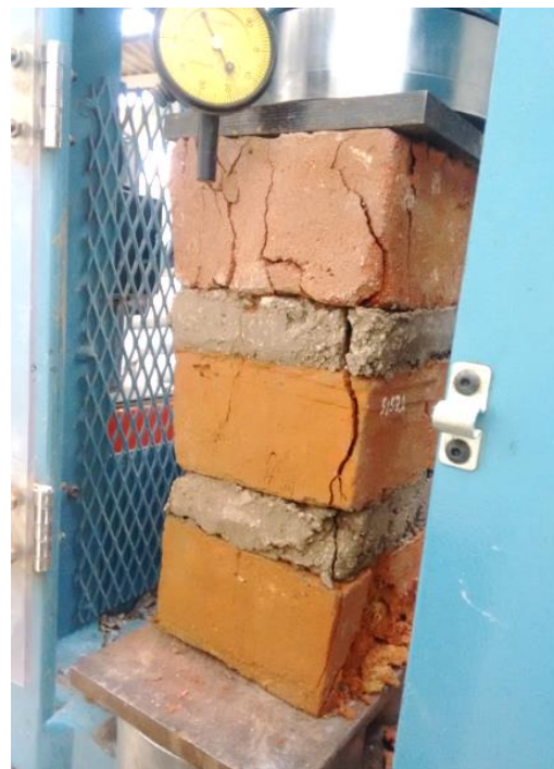
Fotografía 20: Falla típica de pilas de 3.0 cm de espesor.
