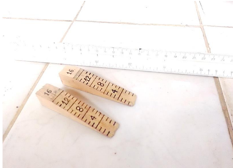
Fotografía 8: Realizando el ensayo de alabeo.
