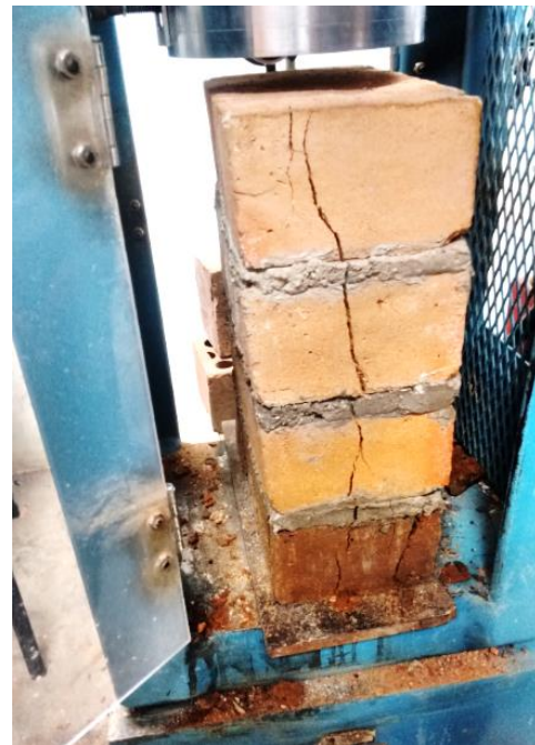
Fotografía 22: Falla típica de pilas de 1.5 cm de espesor.
