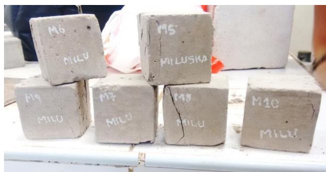
Fotografía 10: Muestras ensayadas de mortero.
