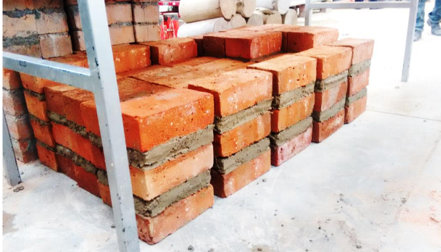
Fotografía 18: Ensayo a compresión de pilas de albañilería.
