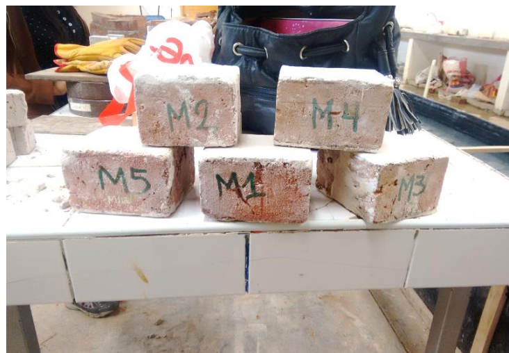
Fotografía 12: Muestras para ensayar a compresión.
