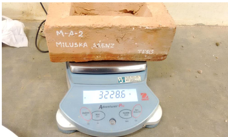
Fotografía 4: Peso de ladrillo después del ensayo a succión.
