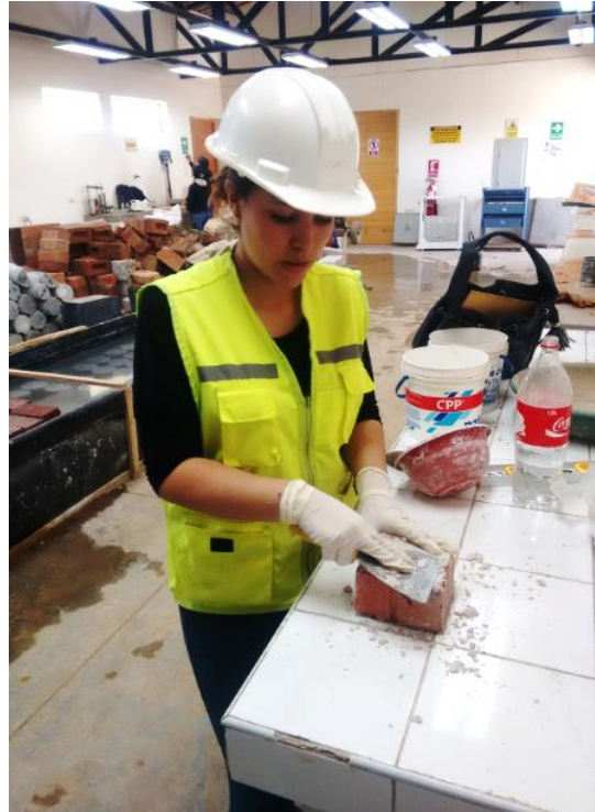
Fotografía 11: Enrasado con yeso medios ladrillos para ensayo a compresión.
