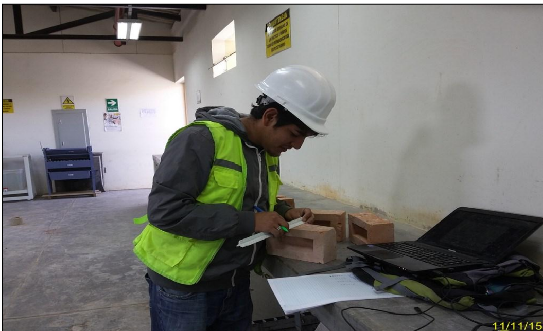
Foto N° 28 Medidas de las dimensiones del ladrillo
