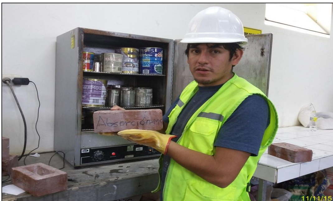
Foto N° 26 Retiro de ladrillos del horno
