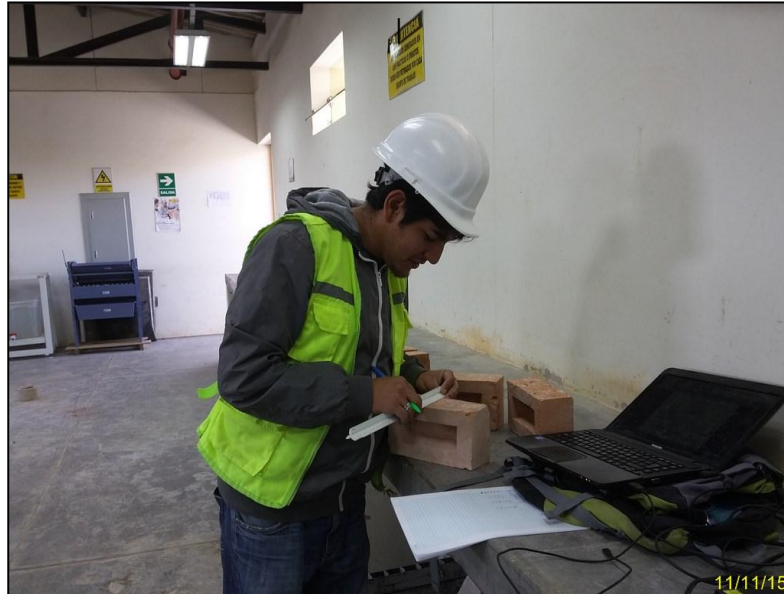
Foto N° 1 Medidas de las dimensiones del ladrillo
