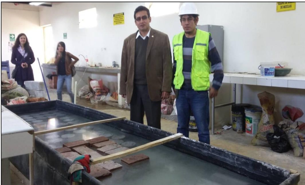
Foto N° 22 Exposición de pilas en agua
