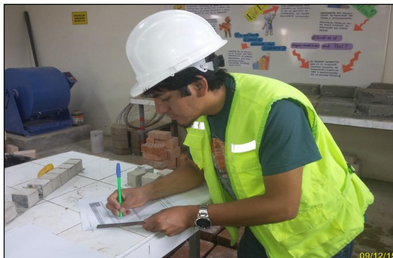
Foto N° 6 Toma de medidas de cubos de mortero
