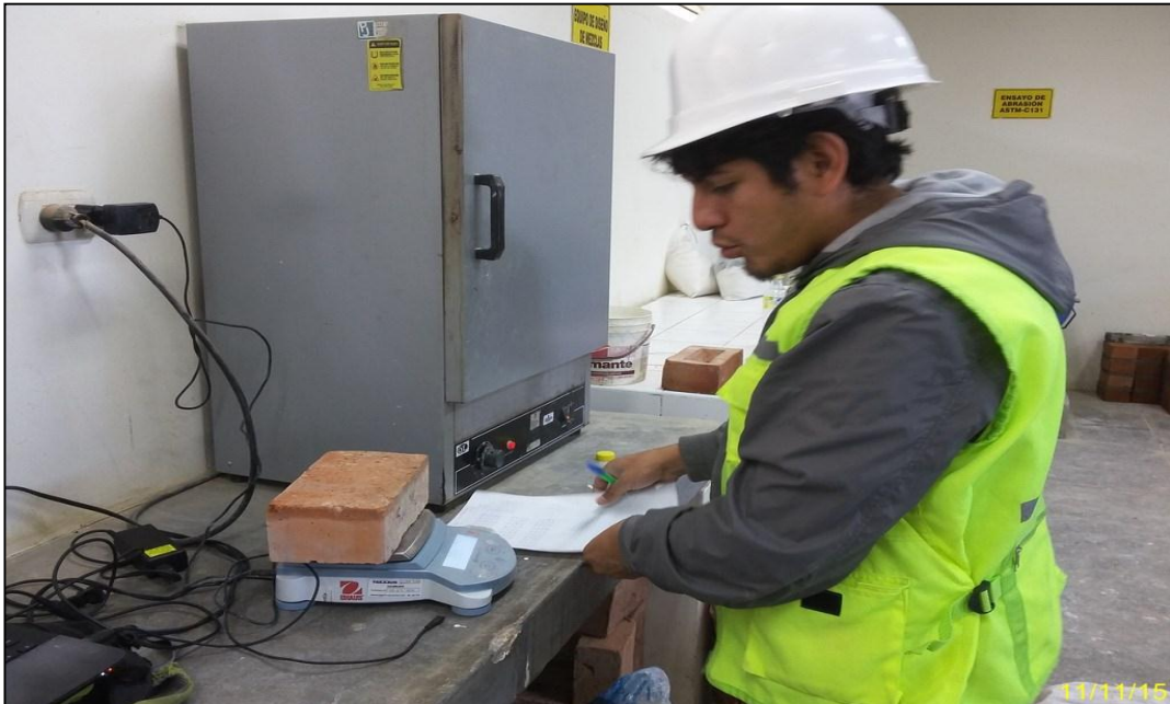
Foto N° 27 pesaje de ladrillos ensayados a succión
