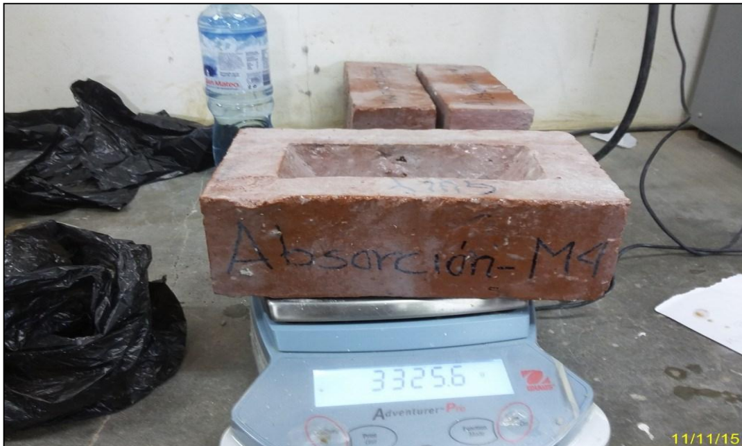
Foto N° 25 pesaje de ladrillo ensayado a absorción
