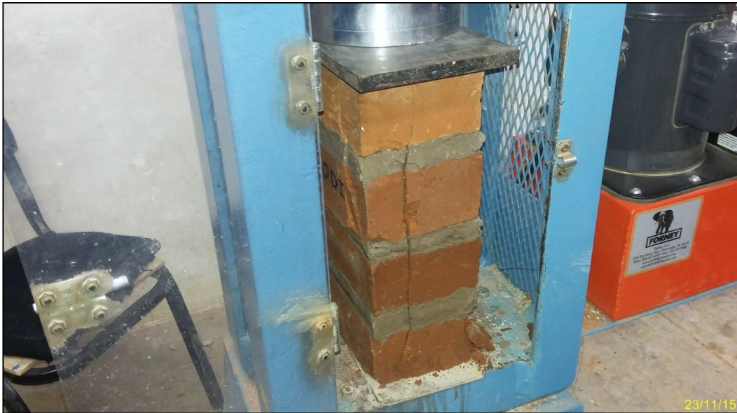
Foto N° 23 Falla del ladrillo
