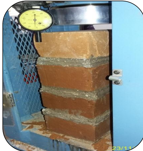
Foto N° 13 Visualización de la deformación de la pila de albañilería
