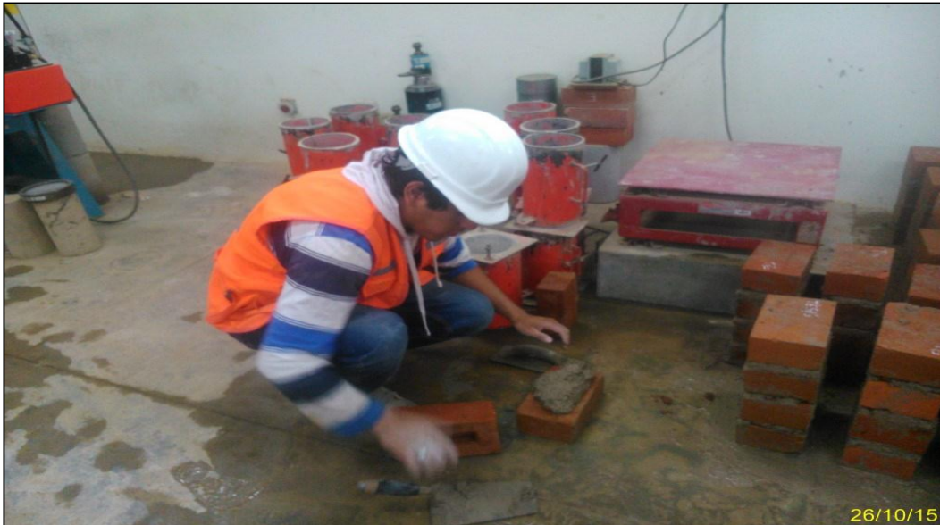
Foto N° 17 Elaboración de pilas de albañilería
