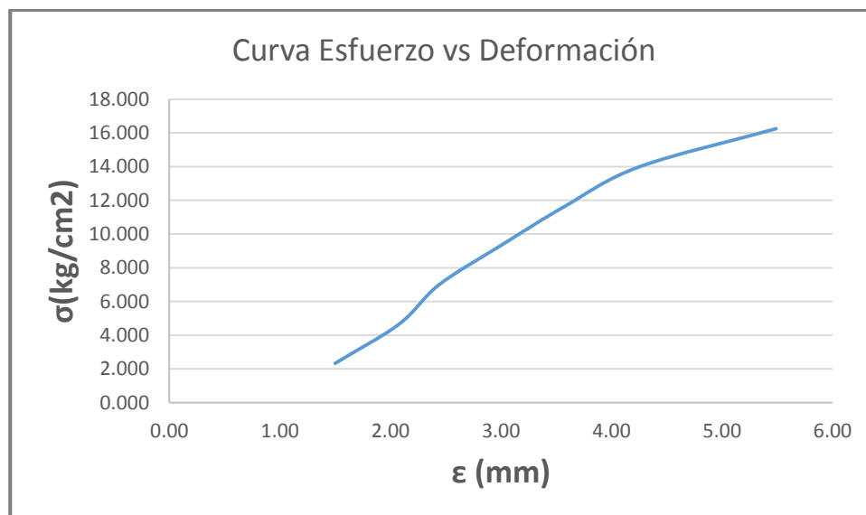
Gráfico 73. Curva Esfuerzo vs Deformación J3 - 1.5% de Adición de Aserrín de Eucalipto.
