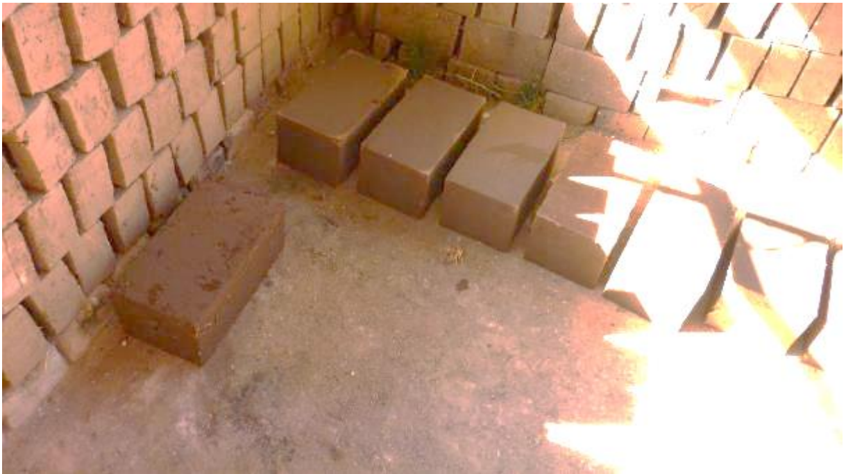
Figura 27. Acopio de los primeros adobes.
