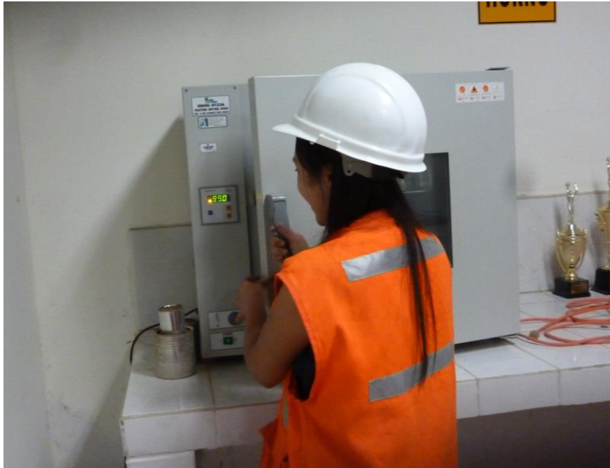
Figura 31. Colocación de adobes en el horno.
