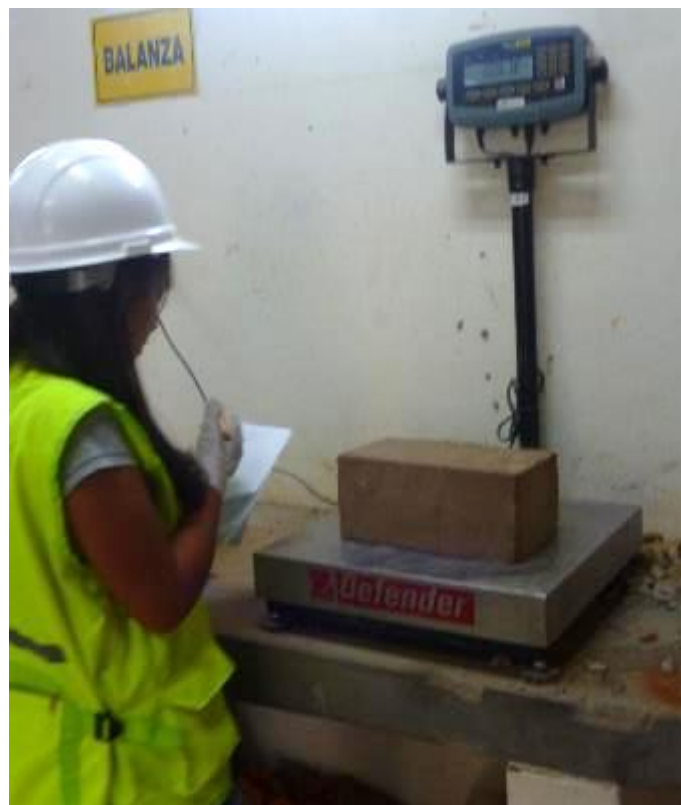
Figura 30. Peso de cada adobe para el ensayo de absorción de agua.
