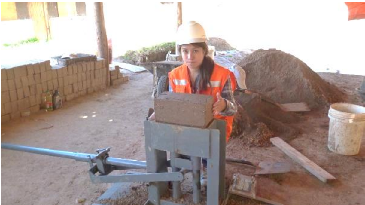
Figura 26. Retiro de los adobes del molde.
