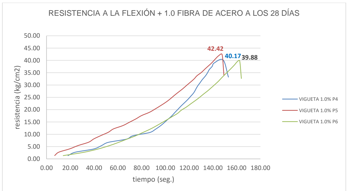
Gráfico N° 9: Ensayo de 03 viguetas de diseño de mezclas patrón con adición de 1.0% de fibras de acero con respecto al peso del concreto. "P4, P5 y P6"
