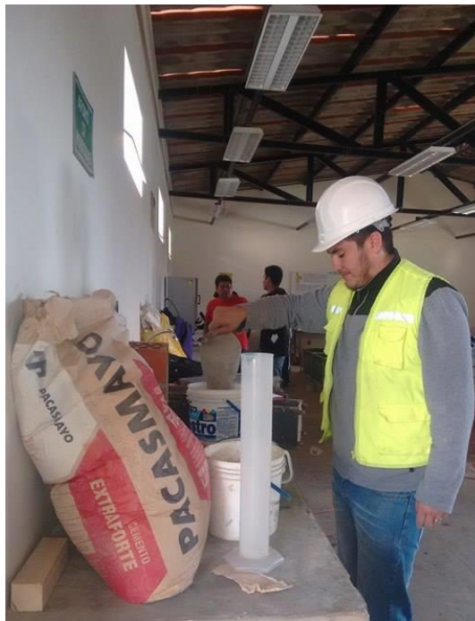
Foto N° 16: Empezando a pesar los materiales para el concreto patrón.
