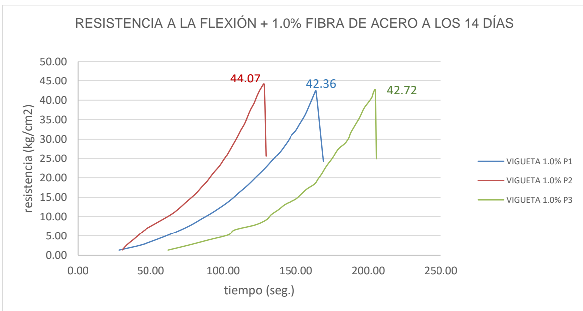
Gráfico N° 17: Ensayo de 03 viguetas de diseño de mezclas patrón con adición de 1.0% de fibras de acero con respecto al peso del concreto. "P1, P2 y P3"
