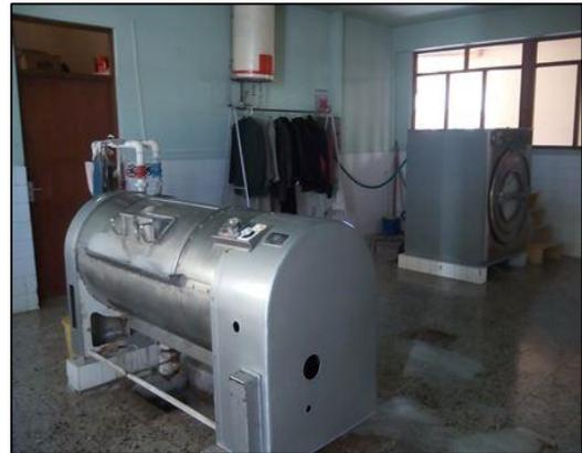
*Figura 3 y 4: Maquinas lavadoras industriales.
