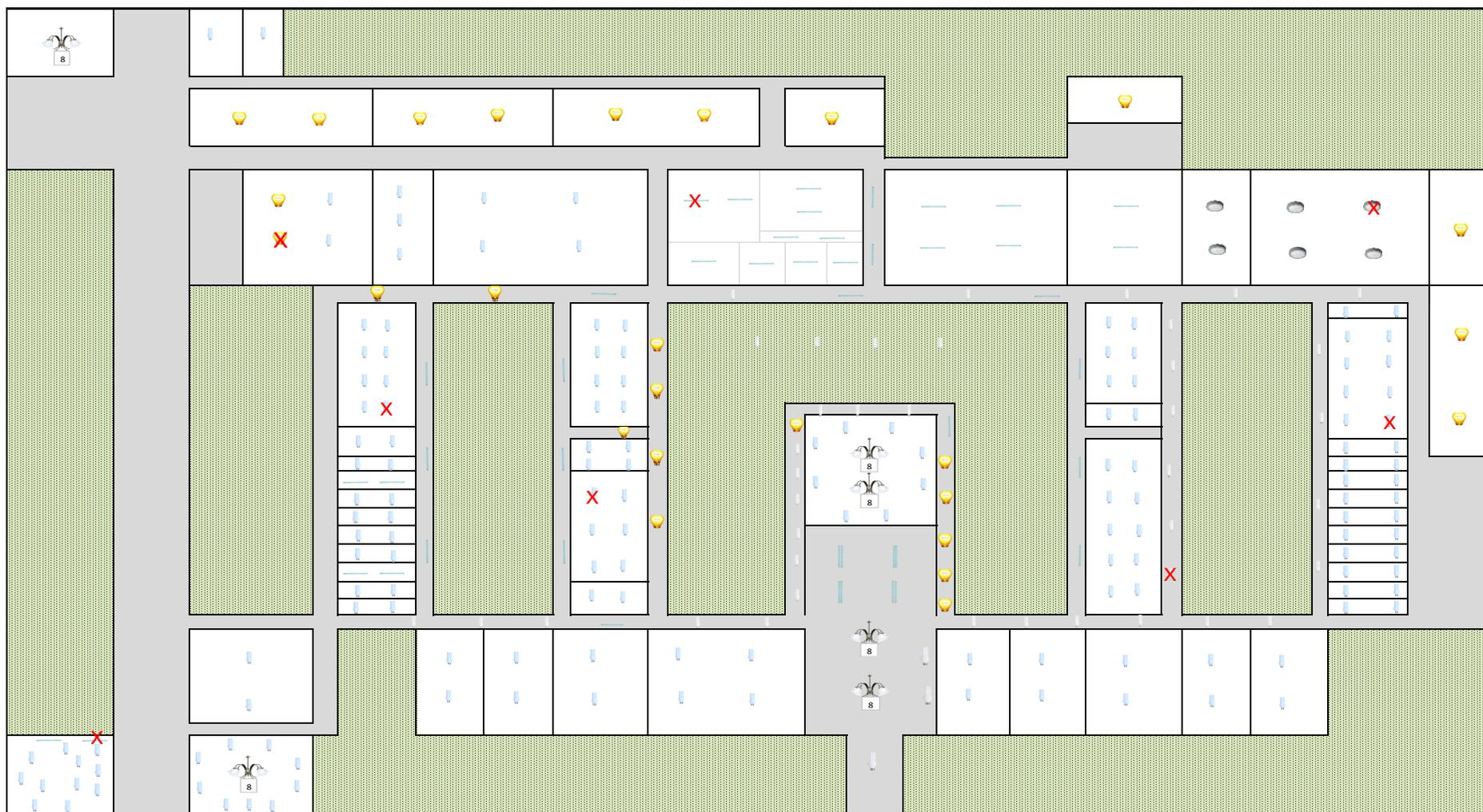
Figura 18: Distribución de las luminarias en la primer planta de la institución.
