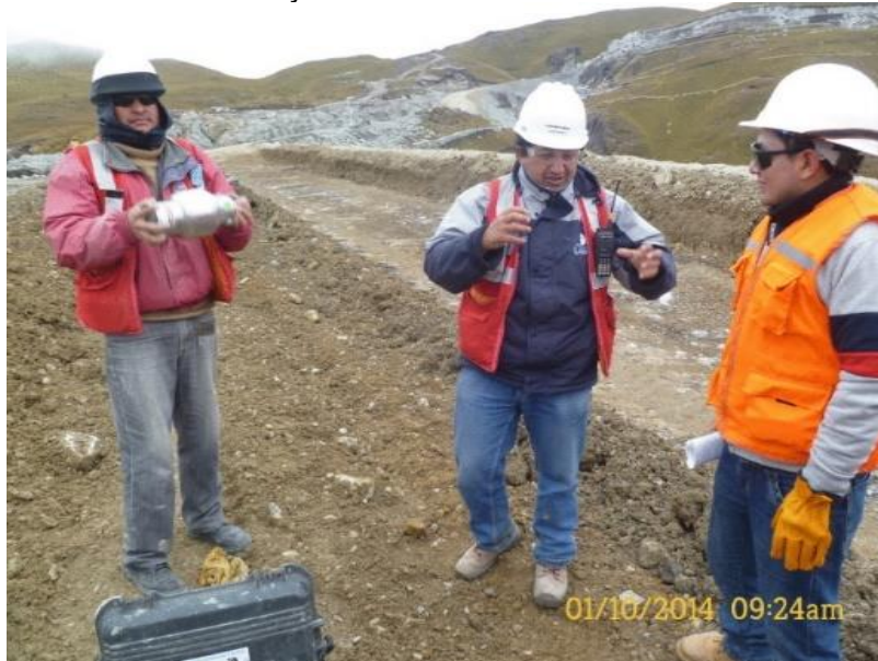
Foto N° 03 Ensayo de humedad con carburo.
