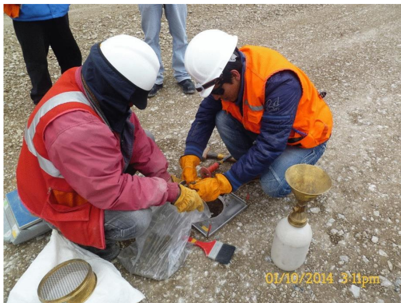
Foto N° 12 Realizando ensayo de cono de arena.
