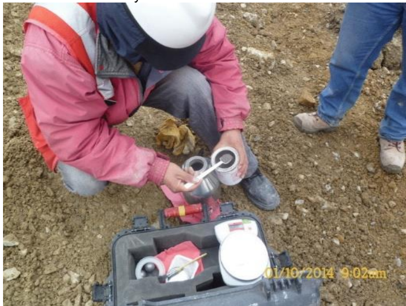
Foto N° 02 Ensayo de humedad con carburo.
