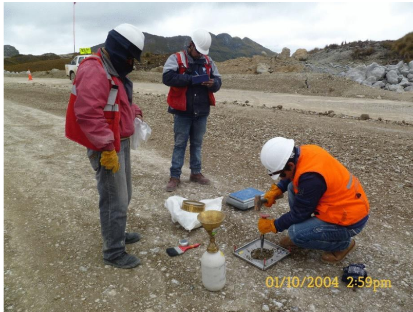
Foto N° 11 Realizando ensayo de cono de arena.
