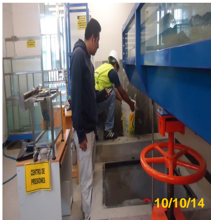
FOTO N° 10: Realizando los ensayos de caudales por el método volumétrico.
