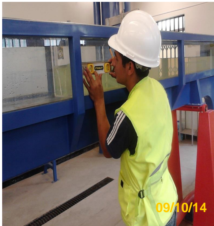
FOTO N° 9: Trazando la línea base a partir de la parte final del vertedero para poder medir las alturas del vertedero existente.
