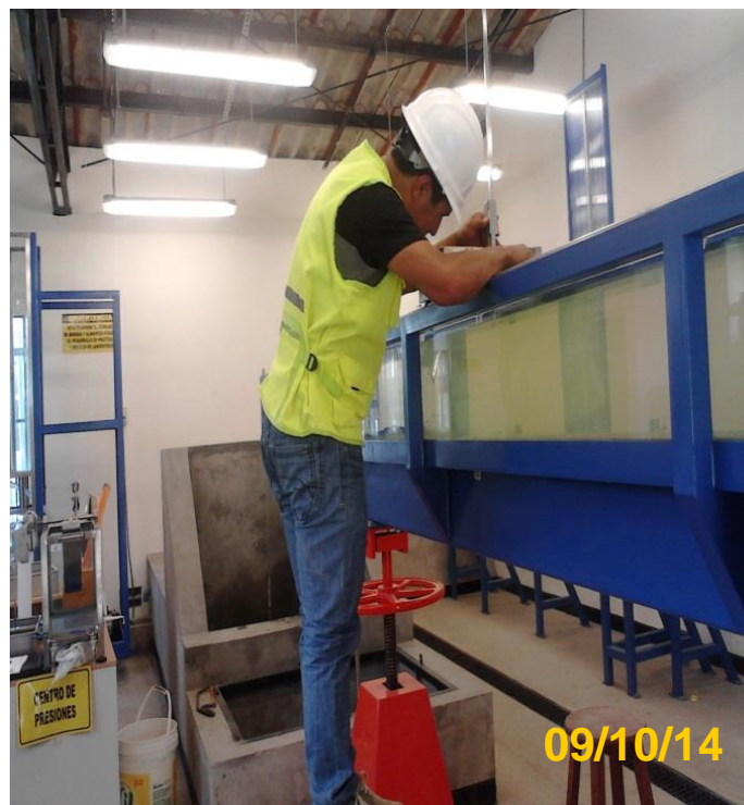
FOTO N° 4: Medición de alturas de vertedero existente.
