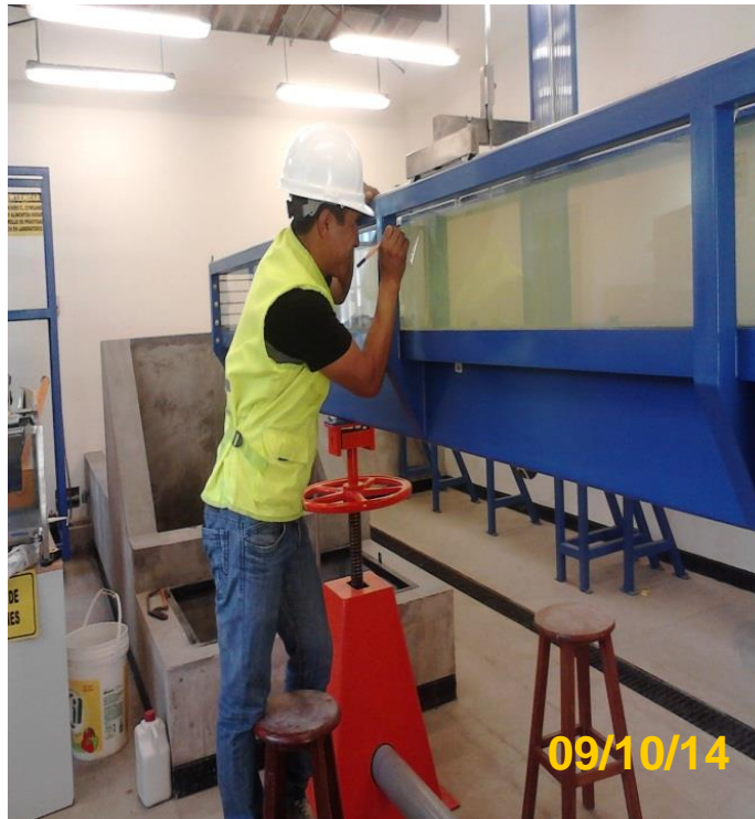
FOTO N° 3: Medición de altura de flujo que pasa por el vertedero existente.
