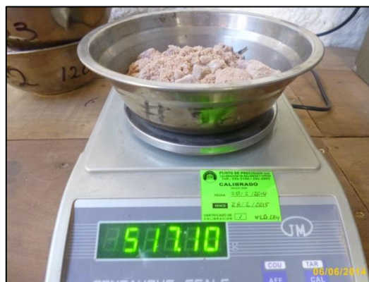
Fotografía n° 41. Derecha. Peso de tara más muestra húmeda de hormigón de cerro para ensayo de contenido de humedad.
