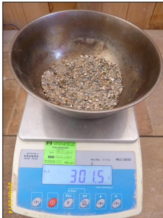
Fotografía n° 50. Peso tara más peso de muestra después de lavada y seca al horno 24 horas, en la fotografía una de las muestras de agregado grueso de río.
