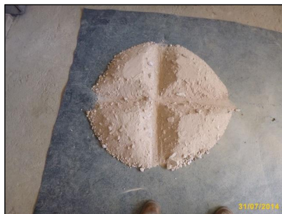
Fotografía n° 45. Cuarteo de hormigón de cerro.
