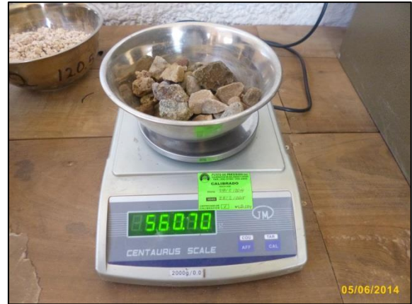
Fotografía n° 35. Izquierda. Peso de tara más muestra húmeda de agregado fino de río para ensayo de contenido de humedad.
