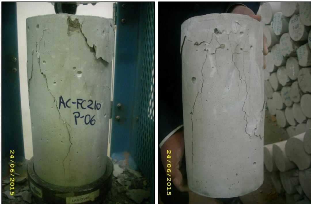
Fotografías n° 173 y n° 174. Probeta con agregado de cerro ensayada a los 28 días.
