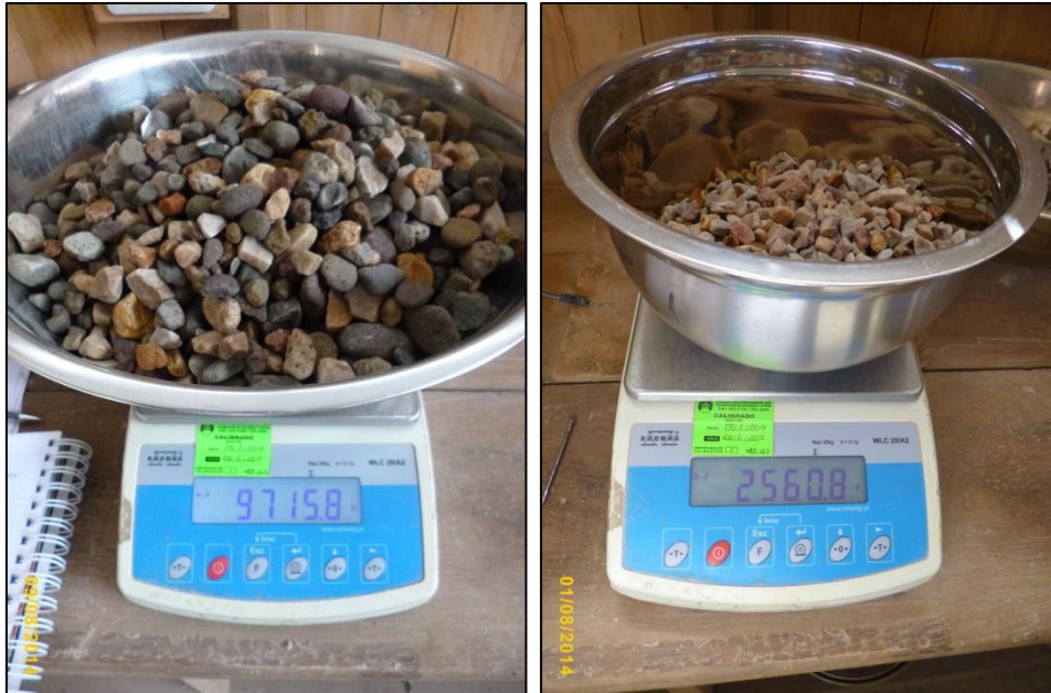
Fotografía n° 98. Izquierda. Peso de tara A-10 más muestra de agregado grueso de río en estado SSS.
