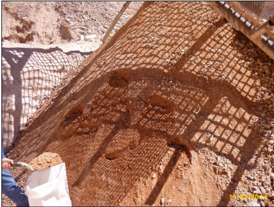
Fotografía n° 18. Pila de hormigón de cerro después de ser muestreada, cantera Don Lucho I.
