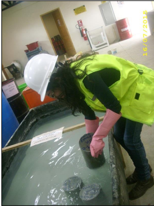
Fotografías n° 145 y n° 146. Sacando las probetas de la poza de curado, para realizar ensayo a compresión.
