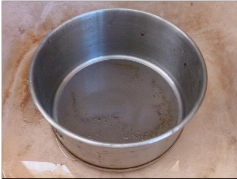
Fotografía n° 26. Tamiz N° 200 para lavado.
