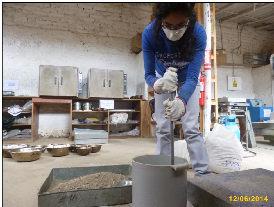
Fotografía n° 75. Compactando la muestra para ensayo de peso unitario compactado, en esta fotografía con agregado fino de río.
