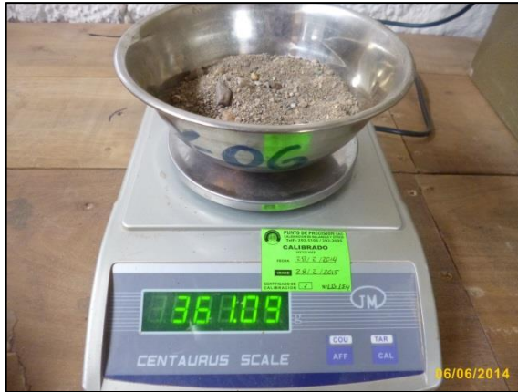
Fotografía n° 38. Izquierda. Peso de tara más muestra seca de agregado fino de río para ensayo de contenido de humedad.
