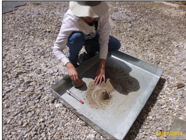
Fotografía n° 92. Preparando la muestra de agregado fino de río después de estar sumergida 24 horas en agua para ensayo de peso específico.
