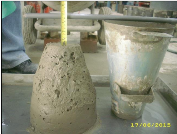
Fotografías n° 128 y n° 129. Medición de Slump o Asentamiento.
