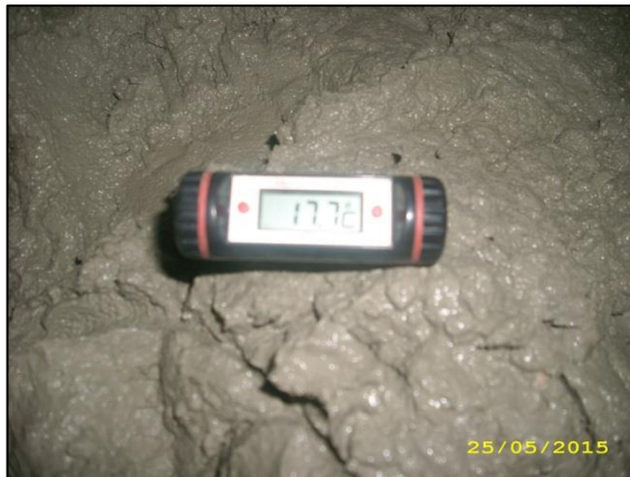
Fotografías n° 122 y n° 123. Lectura de la temperatura de mezcla.
