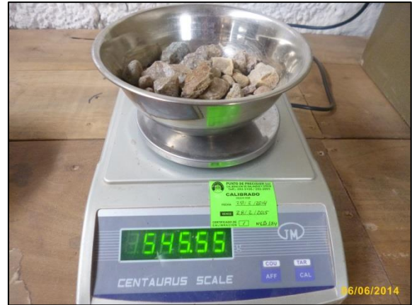
Fotografía n° 38. Izquierda. Peso de tara más muestra seca de agregado fino de río para ensayo de contenido de humedad.
