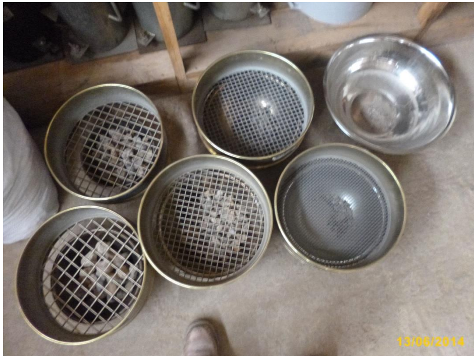
Fotografía n° 48. Fracción gruesa tamizada, en la fotografía una de las muestras de agregado grueso de río.
