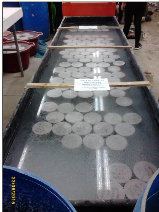
Fotografía n° 144. Curado de probetas.
