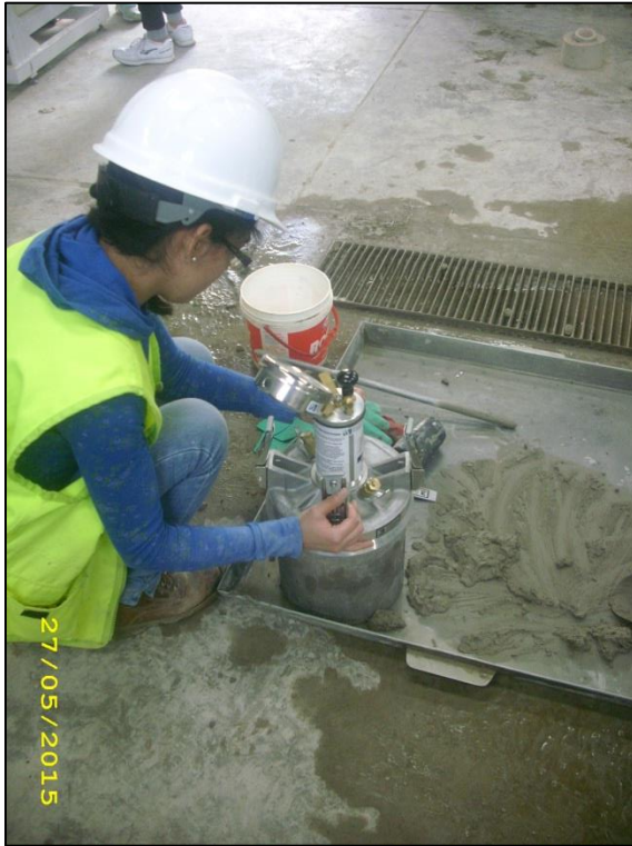
Fotografía n° 134. Colocación de tapa de la Olla de Washington.
