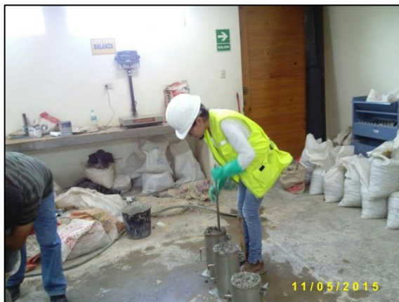
Fotografías n° 140 y n° 141. Llenado de moldes con mezcla.
