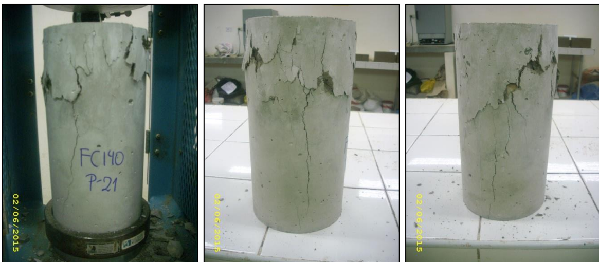
Fotografías n° 159, n° 160 y n° 161. Probeta con agregado de río ensayada a los 28 días.
