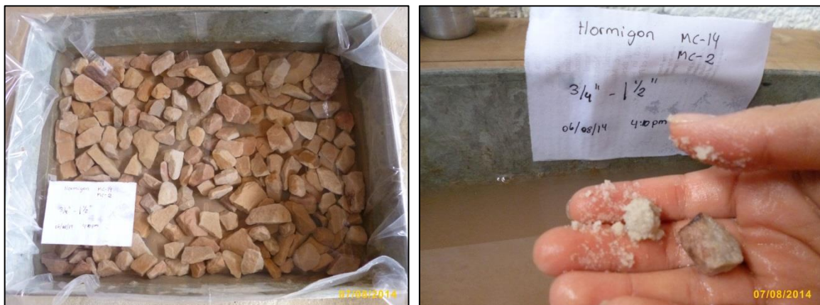
Fotografía n° 114. Izquierda. Muestra de hormigón de cerro retenida entre las mallas 1 1/2" y 3/4", previamente pesadas se las sumerge en agua durante 24 horas. Fotografías n° 115. Derecha. Partículas que se desmenuzan al presionarlas con los dedos.
