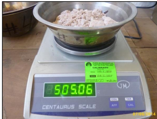
Fotografía n° 42. Peso de tara más muestra seca de hormigón de cerro para ensayo de contenido de humedad.
