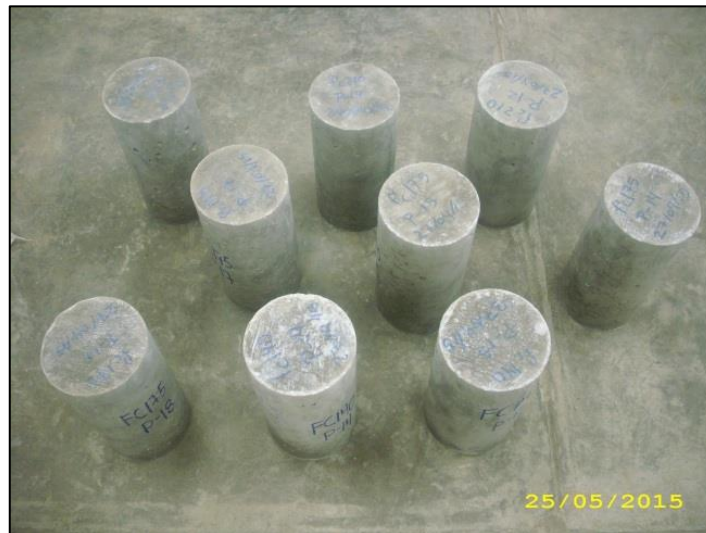
Fotografía n° 147. Las probetas se sacan de la poza y se secan antes del ensayo de resistencia a la compresión.
