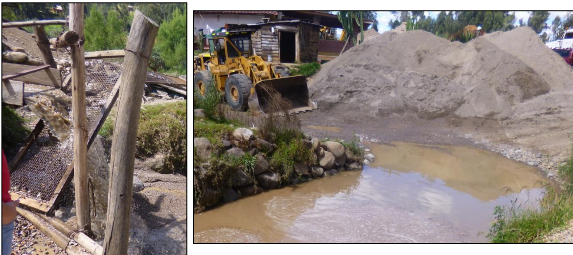
Fotografía n° 2. Izquierda. Cantera Chávez, zaranda de abertura 3/8" para separar el agregado fino.
