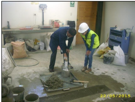
Fotografías n° 136 y n° 137. Bombeado de la Olla de Washington.
