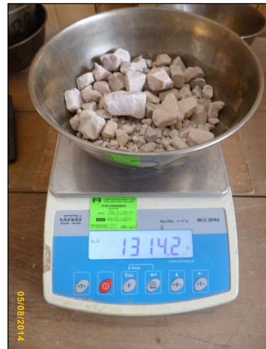
Fotografía n° 68. Peso de tara #38 para pesar el material retenido sobre la malla N° 12 después del ensayo de abrasión.
