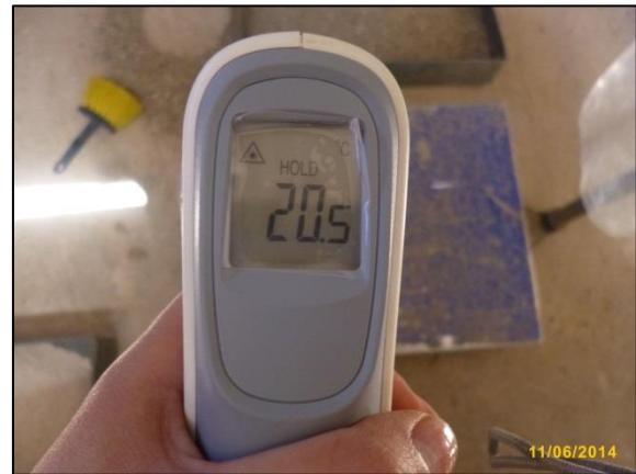
Fotografía n° 72. Izquierda. Midiendo la temperatura del agua.
