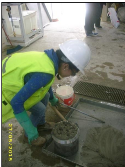
Fotografías n° 130, n° 131, n° 132 y n° 133. Llenado de Olla de Washington en tres capas y enrasado.
