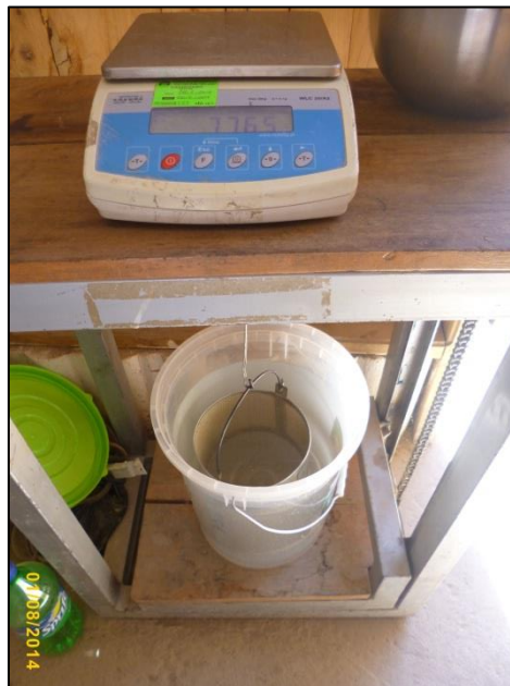
Fotografía n° 100. Peso de canastilla sumergida.
