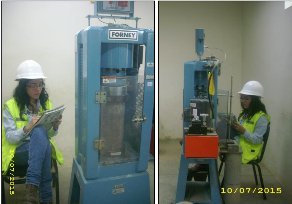
Fotografías n° 157 y n° 158. Lectura de deformación y carga cada 1000 kg de carga.
