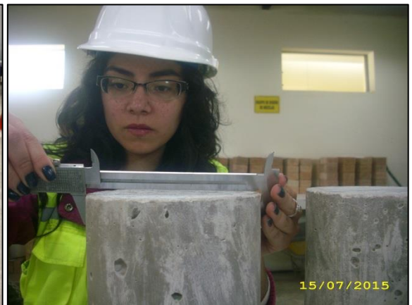
Fotografías n° 150 y n° 151. Medición del diámetro de las probetas.
