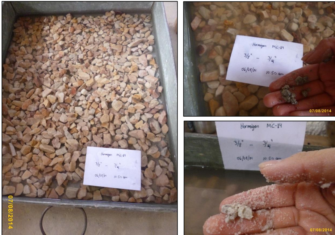
Fotografía n° 111. Izquierda. Muestra de hormigón de cerro retenida entre las mallas 3/4" y 3/8", previamente pesadas se las sumerge en agua durante 24 horas. Fotografías n° 112 y n° 113. Derecha. Partículas que se desmenuzan al presionarlas con los dedos.
