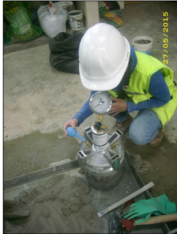
Fotografía n° 134. Colocación de tapa de la Olla de Washington.
