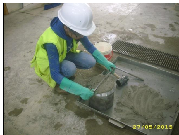
Fotografías n° 130, n° 131, n° 132 y n° 133. Llenado de Olla de Washington en tres capas y enrasado.
