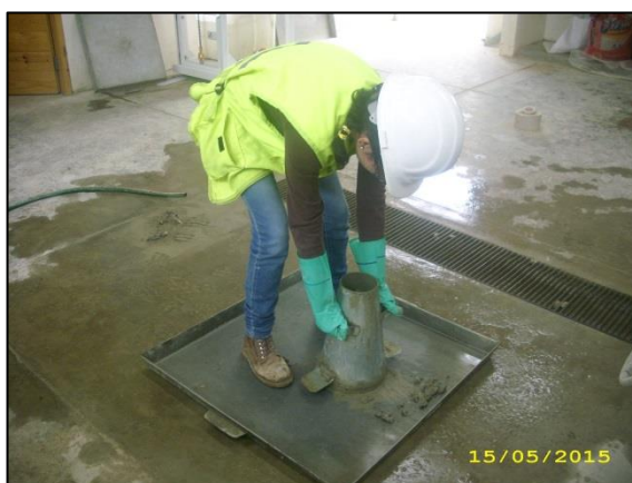
Fotografías n° 124, n° 125, n° 126 y n° 127. Elaboración de ensayo de asentamiento.
