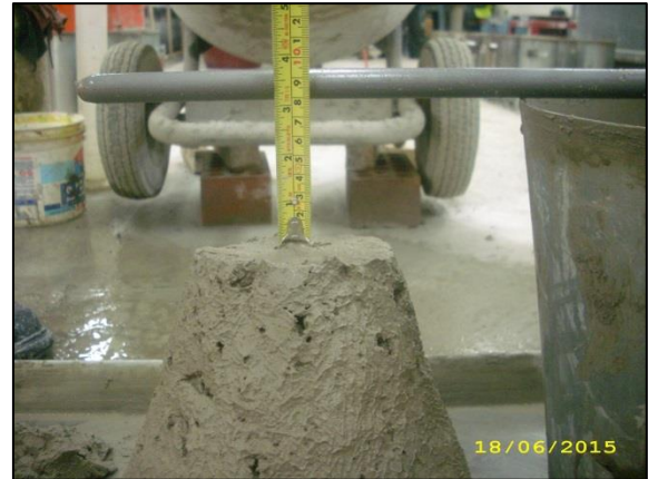
Fotografías n° 128 y n° 129. Medición de Slump o Asentamiento.
