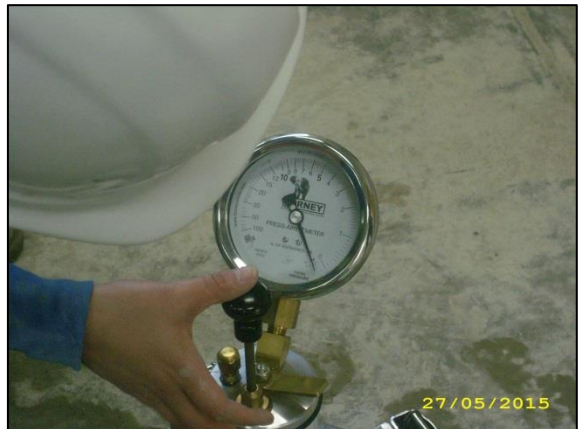
Fotografías n° 136 y n° 137. Bombeado de la Olla de Washington.
