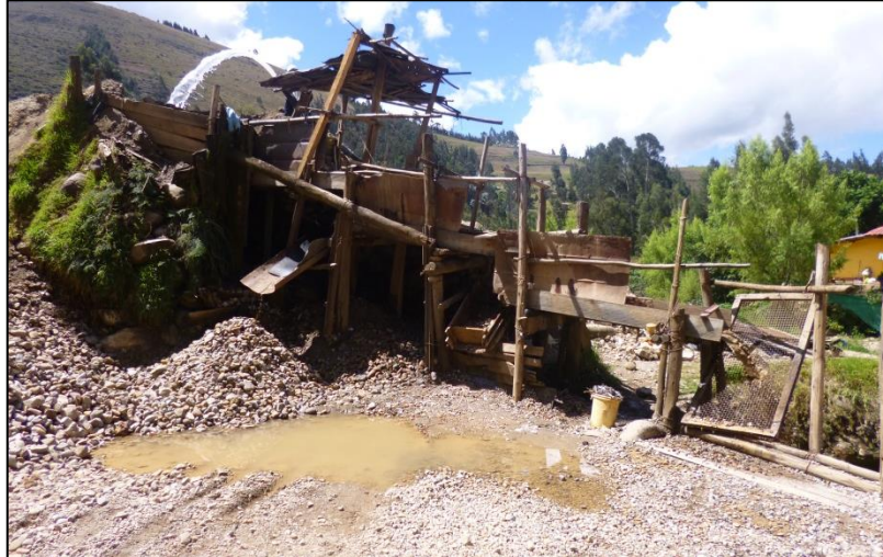
Fotografía n° 1. Cantera Chávez, sistema de lavado y zarandeo de agregado. En esta fotografía observamos el lado donde cae el agregado grueso.
