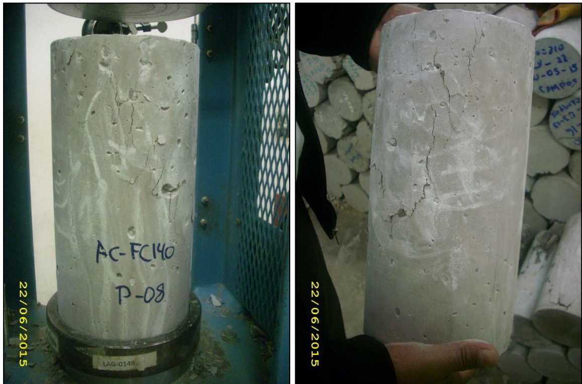
Fotografías n° 169 y n° 170. Probeta con agregado de cerro ensayada a los 28 días.
