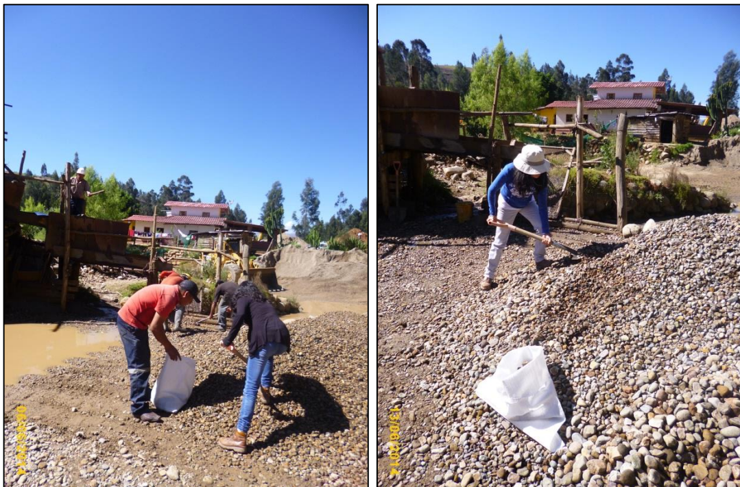
Fotografía n° 11 y n° 12. Muestreo de agregado grueso de río de la cantera Chávez.
