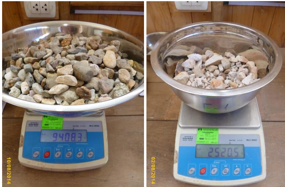
Fotografía n° 101. Izquierda. Peso de tara A-10 más peso muestra de agregado grueso de río seco al horno durante 24 horas.
