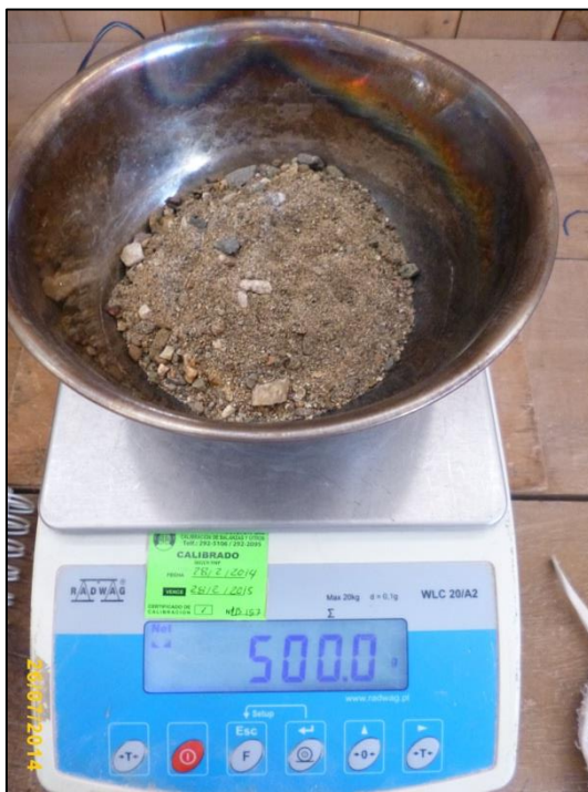
Fotografía n° 93. Izquierda. Muestra de agregado fino de río en estado saturado superficialmente seco.
