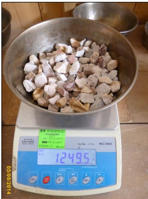
Fotografía n° 62. Arriba izquierda. Peso de muestra pasa malla 1 1/2" y se retiene en malla 1", de hormigón de cerro para ensayo de abrasión.
