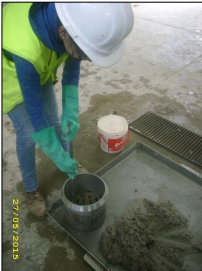
Fotografías n° 128 y n° 129. Medición de Slump o Asentamiento.
