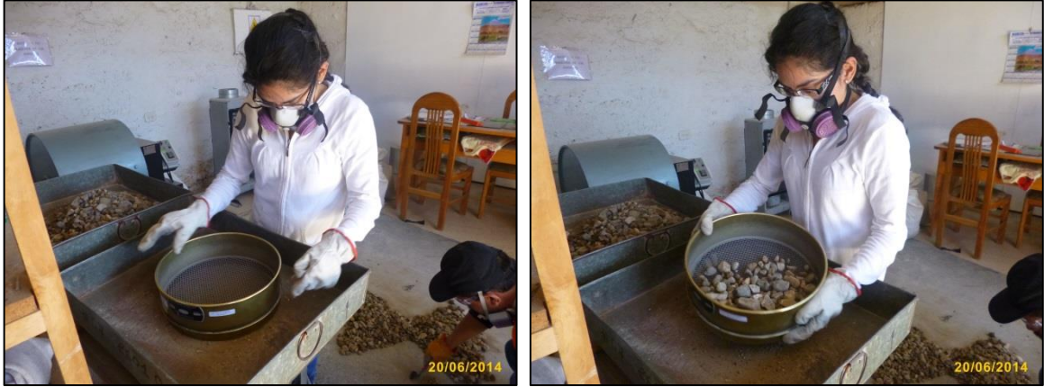
Fotografía n° 46 y n° 47. Separando por la malla N° 4, en la fotografía una de las muestras de agregado grueso de río.
