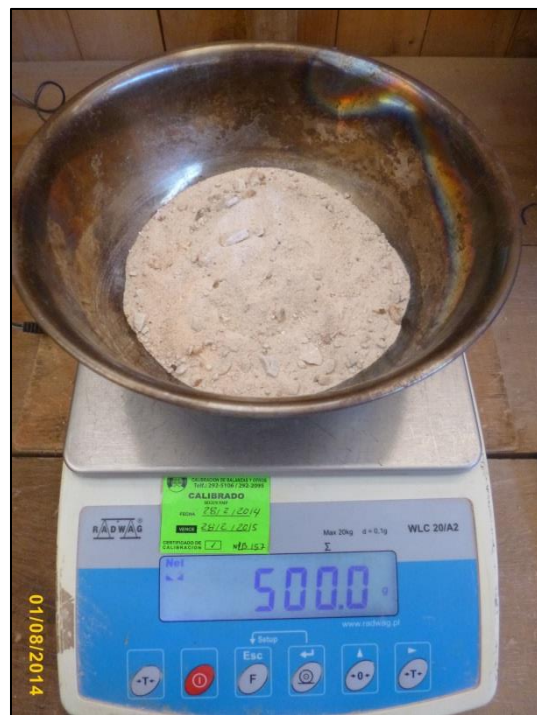
Fotografía n° 93. Izquierda. Muestra de agregado fino de río en estado saturado superficialmente seco.
