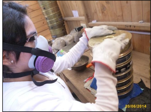
Fotografía n° 51 y n° 52. Tamizado de fracción fina.
