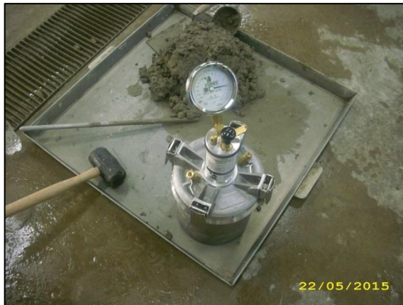
Fotografías n° 138 y n° 139. Lectura de la cantidad de aire.
