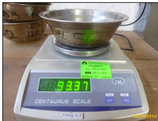
Fotografía n° 40. Peso de tara #52 para ensayo de contenido de humedad.
