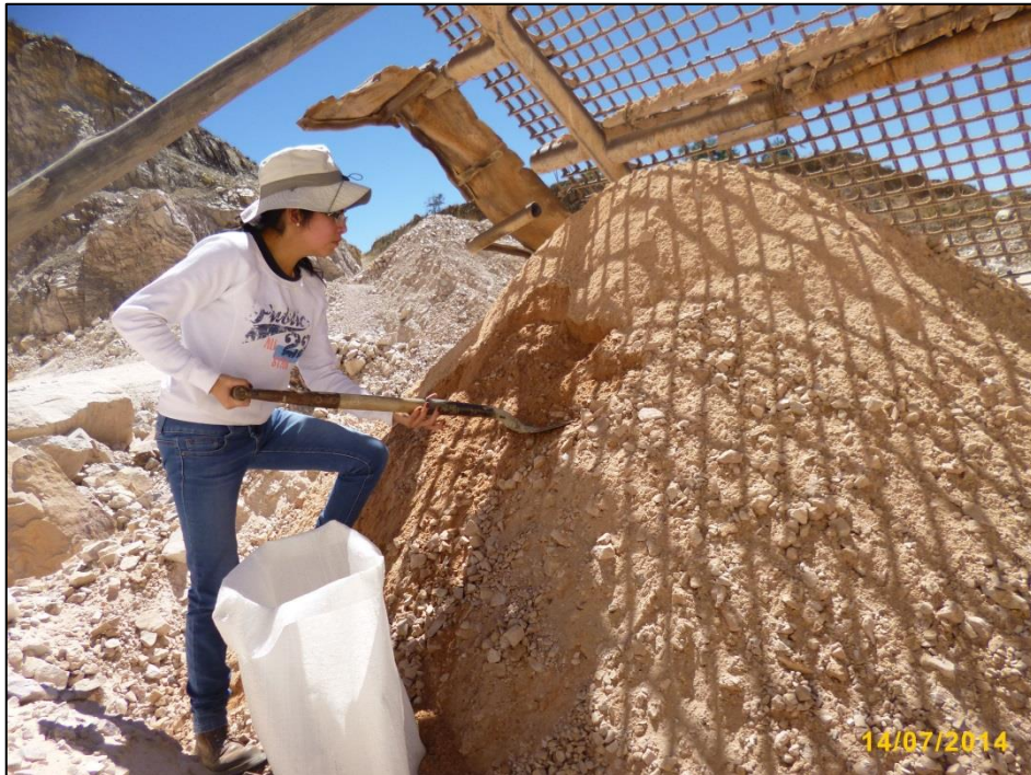
Fotografía n° 17. Muestreando de pila de hormigón de cerro de la cantera Don Lucho I.
