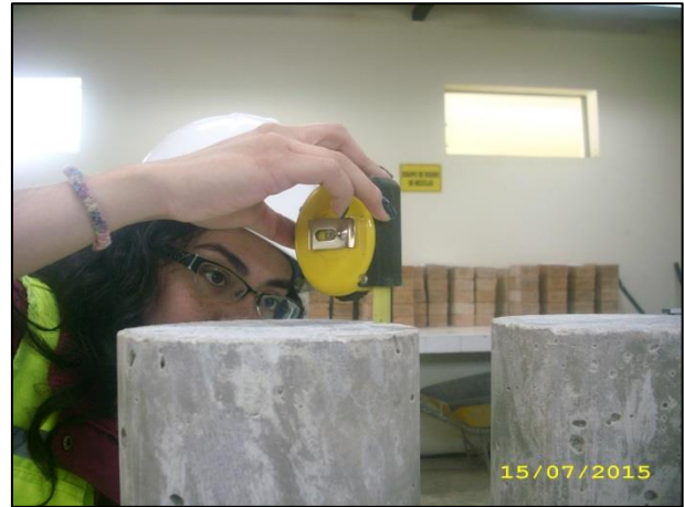
Fotografías n° 148 y n° 149. Medición de la altura o longitud de las probetas.
