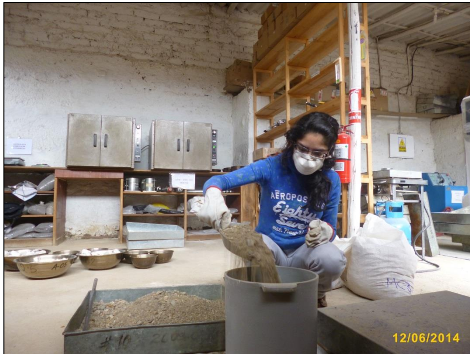
Fotografía n° 74. Llenado de molde para ensayo de peso unitario suelto, en esta fotografía con agregado fino de río.
