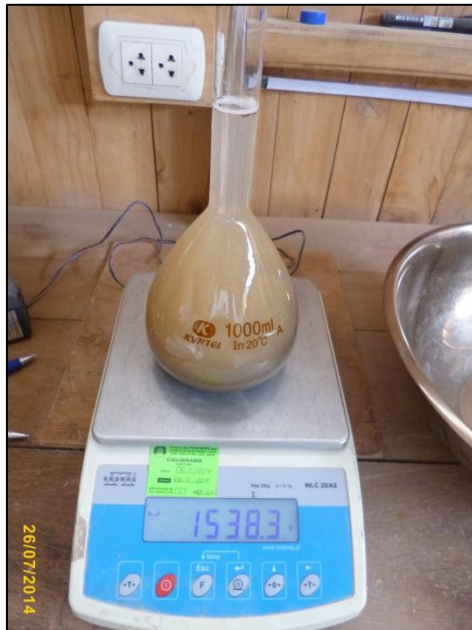
Fotografía n° 95. Izquierda. Peso de fiola más aguas más muestra de agregado fino de río en estado SSS.
