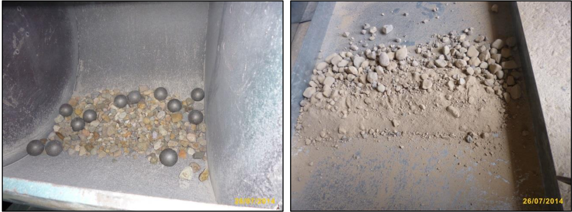
Fotografía n° 59. Izquierda. Muestra de agregado grueso de río para ensayo de abrasión junto a las 12 esferas dentro de la máquina de los ángeles”.
