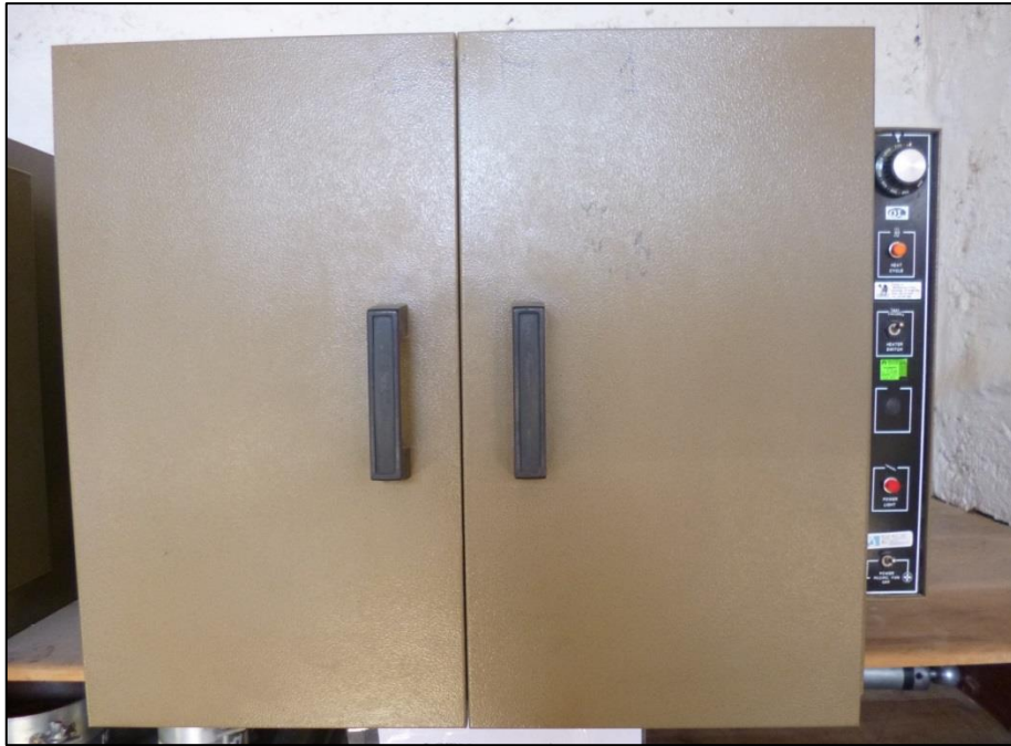
Fotografía n° 24. Estufa a 110 °C, certificado de calibración LT 087 ver en ANEXO C.
