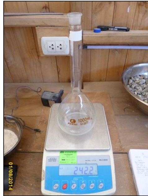
Fotografía n° 88. Izquierda. Peso de fiola para ensayo de peso específico de agregado fino de río.
