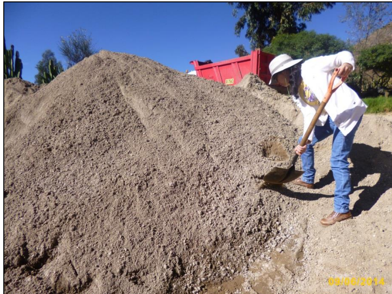
Fotografía n° 9. Muestreando de pila de agregado fino de río de la cantera Chávez.
