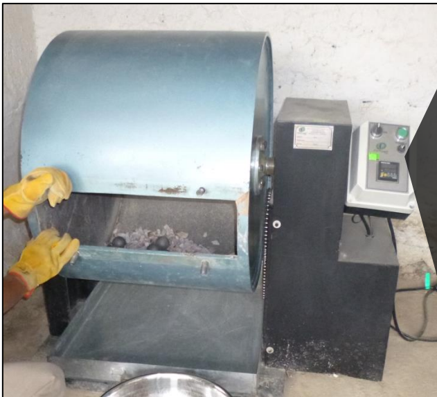
Fotografía n° 25. Máquina de Los Ángeles para ensayo de abrasión del agregado grueso, certificado de calibración LL 101 ver en ANEXO C.
