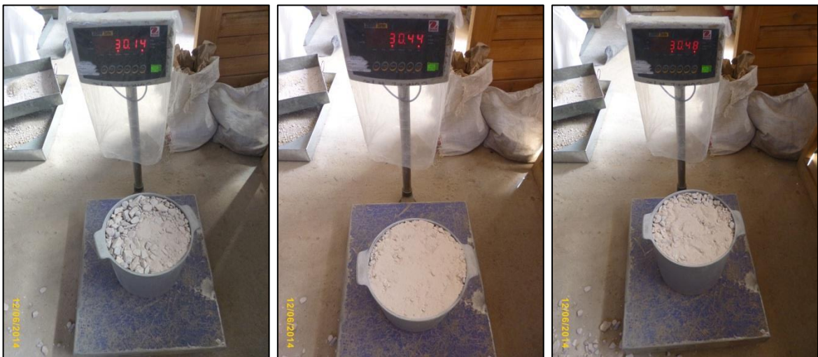
Fotografías n° 85, n° 86 y n° 87. Lecturas de peso de molde más peso de hormigón de cerro para ensayo de peso unitario compactado.
