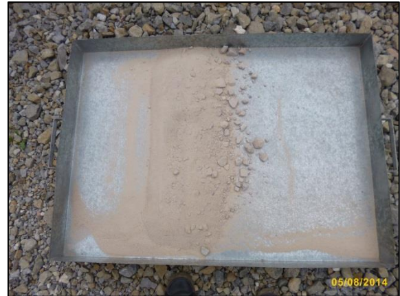
Fotografía n° 66. Izquierda. Muestra de hormigón de cerro para ensayo de abrasión junto a las 12 esferas dentro de la máquina de los ángeles”.
