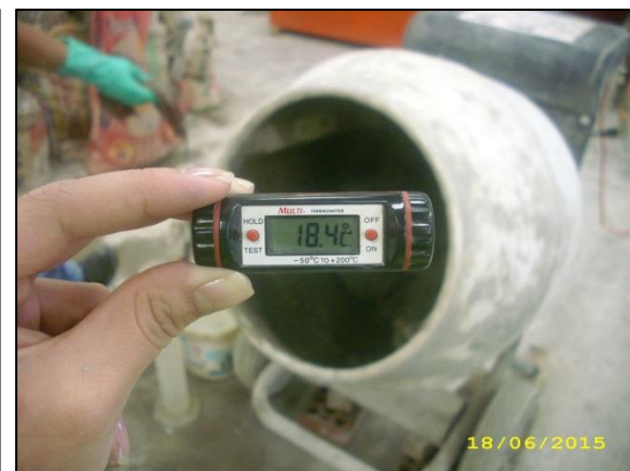
Fotografías n° 120 y n° 121. Lectura de la temperatura ambiente.
