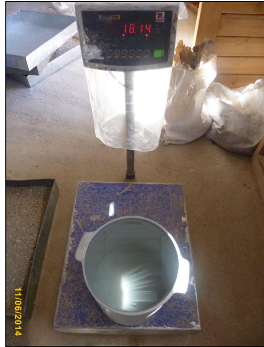
Fotografía n° 70. Izquierda. Peso de molde para ensayo de peso unitario.
