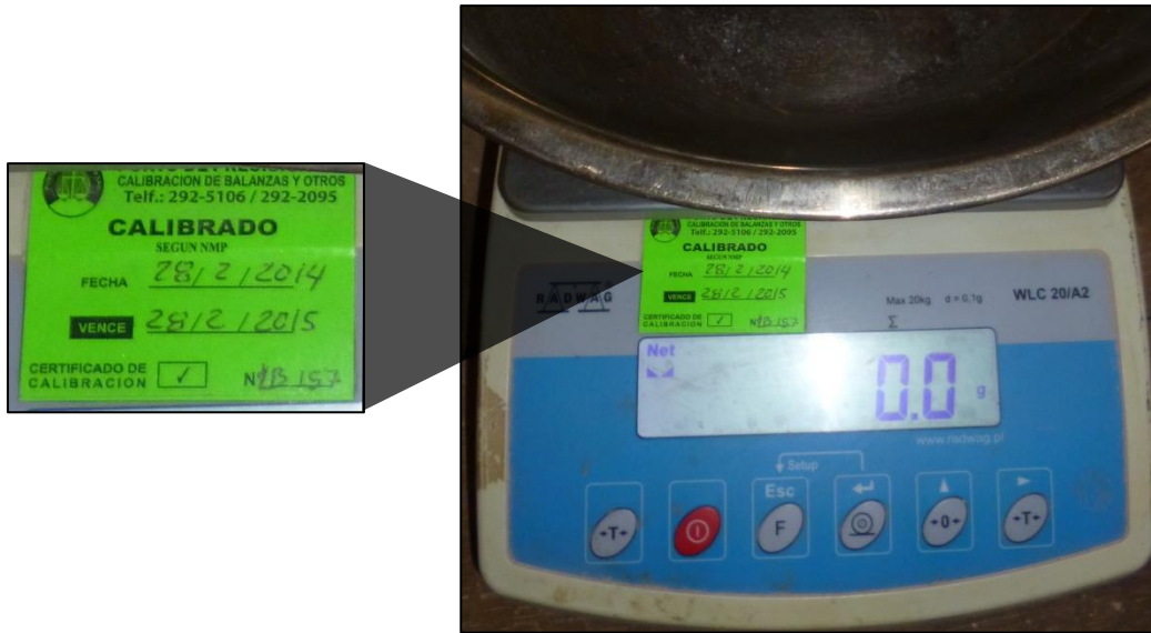
Fotografía n° 22. Balanza electrónica de capacidad 20 000g, certificado de calibración LB 157 ver en ANEXO C.
