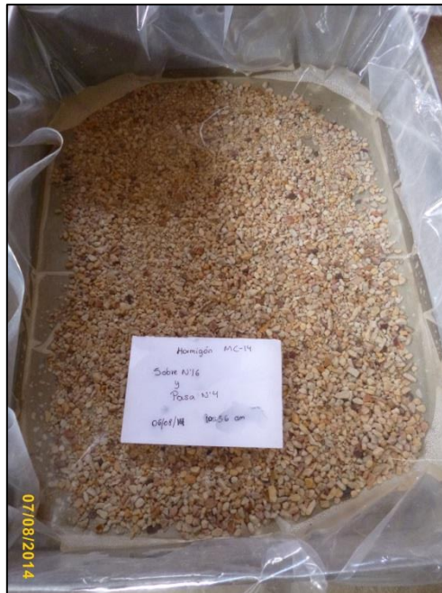
Fotografía n° 107. Muestra de hormigón de cerro retenida entre las mallas N°4 y N°16, previamente pesadas se las sumerge en agua durante 24 horas.
