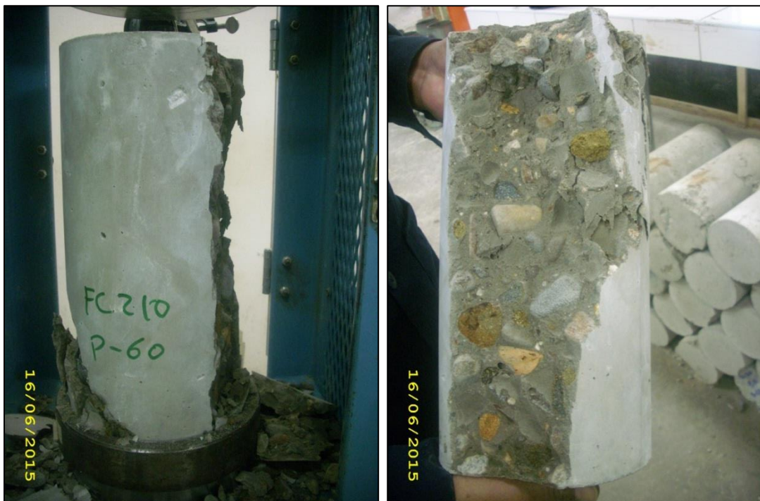
Fotografías n° 164 y n° 165. Probeta con agregado de río ensayada a los 28 días.
