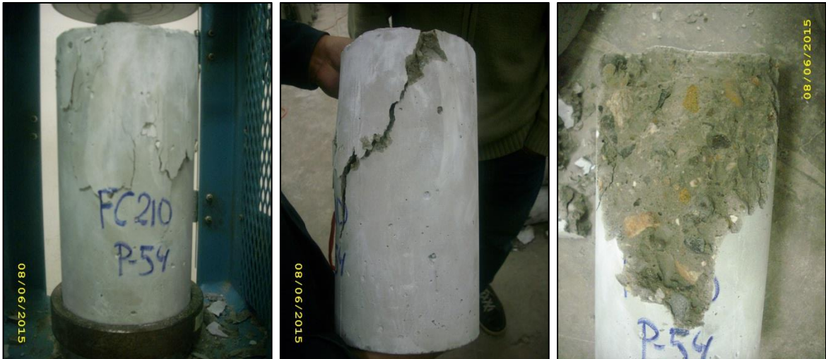
Fotografías n° 166, n° 167 y n° 168. Probeta con agregado de río ensayada a los 28 días.
