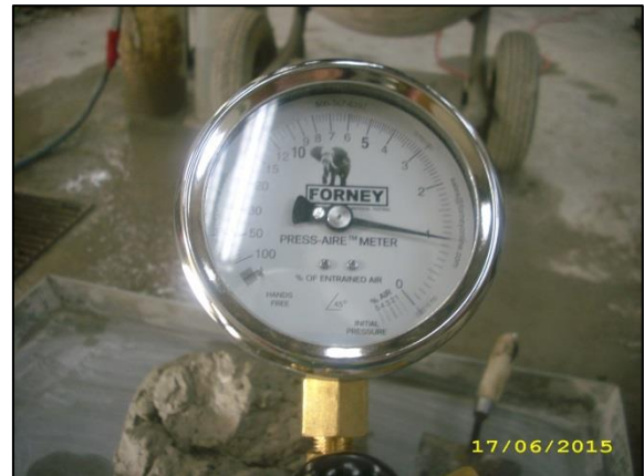
Fotografías n° 138 y n° 139. Lectura de la cantidad de aire.
