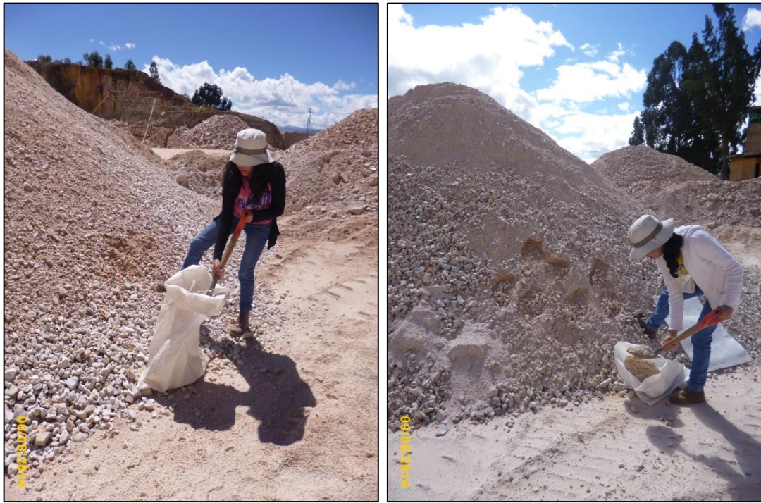
Fotografía n° 15 y n° 16. Muestreo de hormigón de la cantera Don Lucho I.
