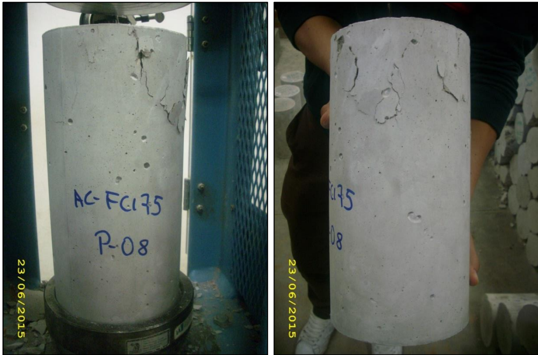
Fotografías n° 171 y n° 172. Probeta con agregado de cerro ensayada a los 28 días.
