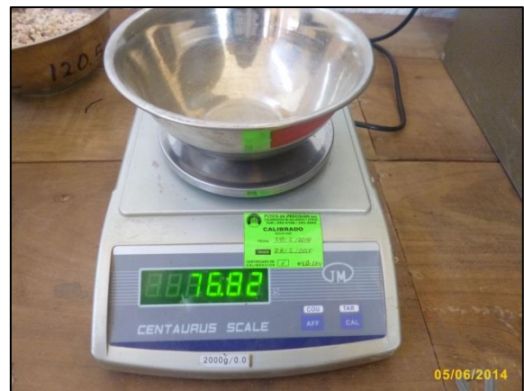
Fotografía n° 33. Izquierda. Peso de tara X-06 para ensayo de contenido de humedad. Fotografía n° 34. Derecha. Peso de tara X-05 para ensayo de contenido de humedad.
