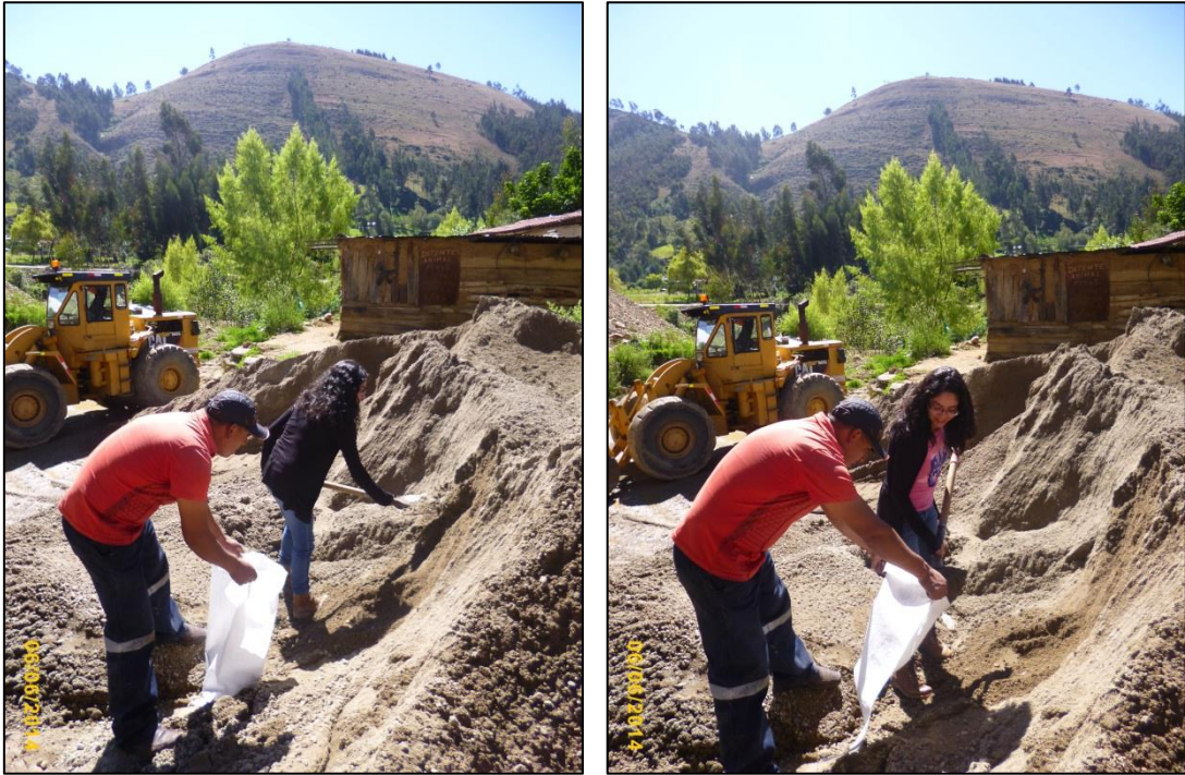
Fotografía n° 7 y n° 8. Muestreo de agregado fino de río de la cantera Chávez.
