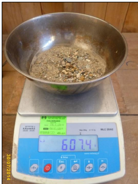
Fotografía n° 95. Izquierda. Peso de tara #45 más muestra de agregado fino de río seca después de 24 horas en el horno.
