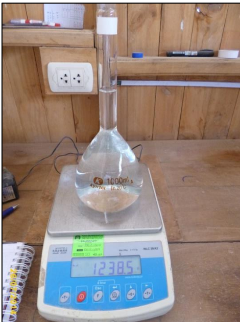
Fotografía n° 90. Izquierda. Peso de fiola más peso de agua para ensayo de peso específico de agregado fino de río.
