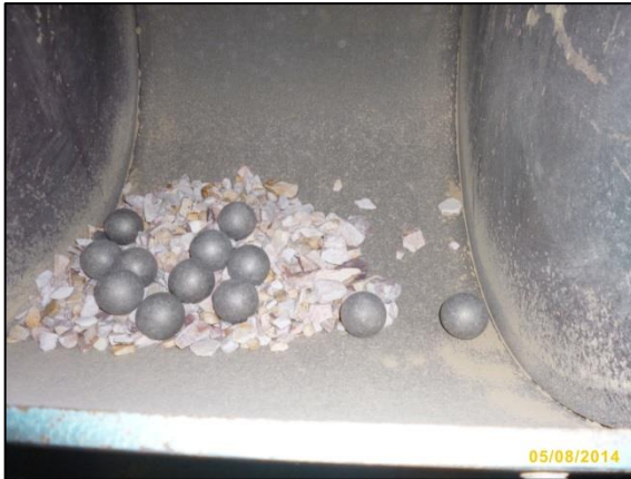
Fotografía n° 66. Izquierda. Muestra de hormigón de cerro para ensayo de abrasión junto a las 12 esferas dentro de la máquina de los ángeles”.
