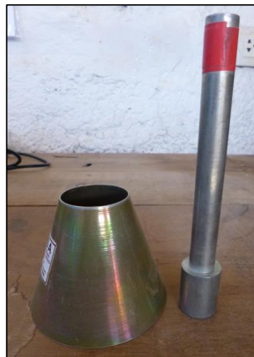
Fotografía n° 29. Izquierda. Instrumentos para ensayo de peso específico de agregado fino, cono metálico y varilla para compactar.
