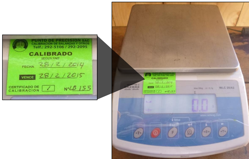
Fotografía n° 21. Balanza electrónica de capacidad 20 000g, certificado de calibración LB 155 ver en ANEXO C.
