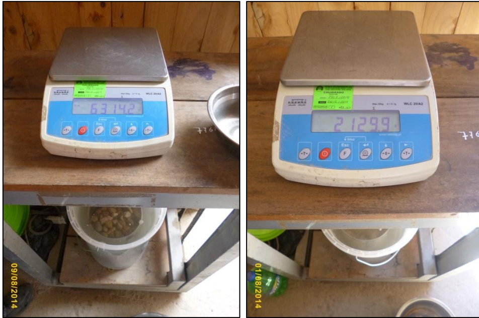
Fotografía n° 101. Izquierda. Peso de canastilla más peso muestra de agregado grueso de río sumergidos.
