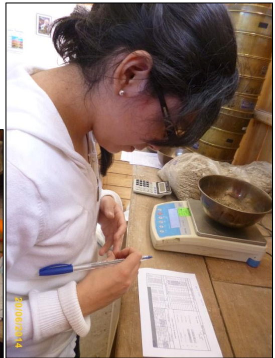
Fotografía n° 53 y n° 54. Toma de datos de ensayo de granulometría.
