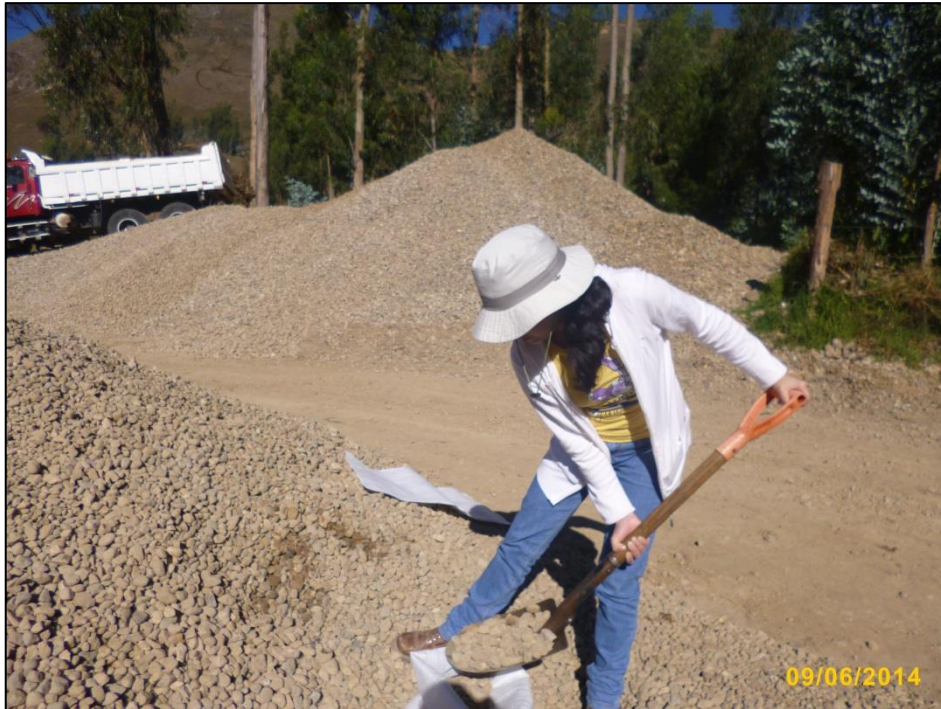
Fotografía n° 13. Muestreando de pila de agregado grueso de río de la cantera Chávez.
