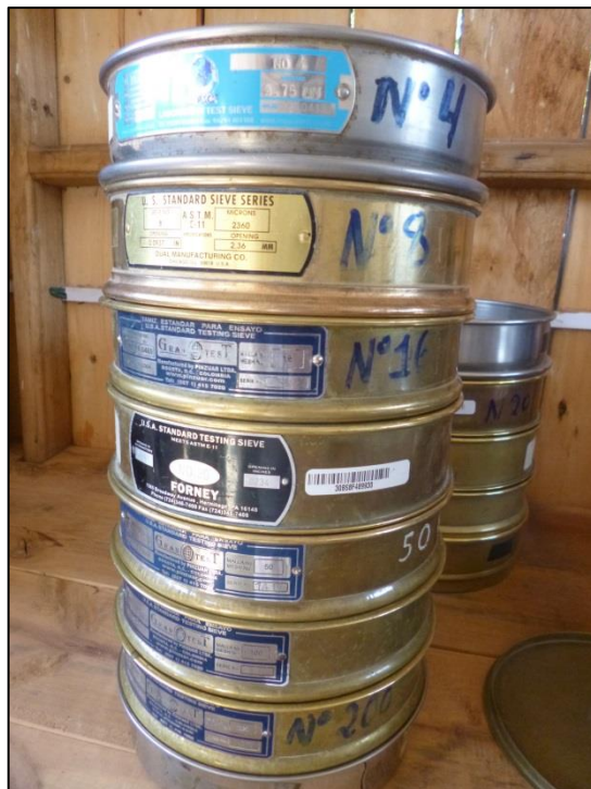
Fotografía n° 27. Juego de tamices 2kg, N°4, N°8, N°16, N°30, N°50, N°100, N°200, cazoleta y tapa.
