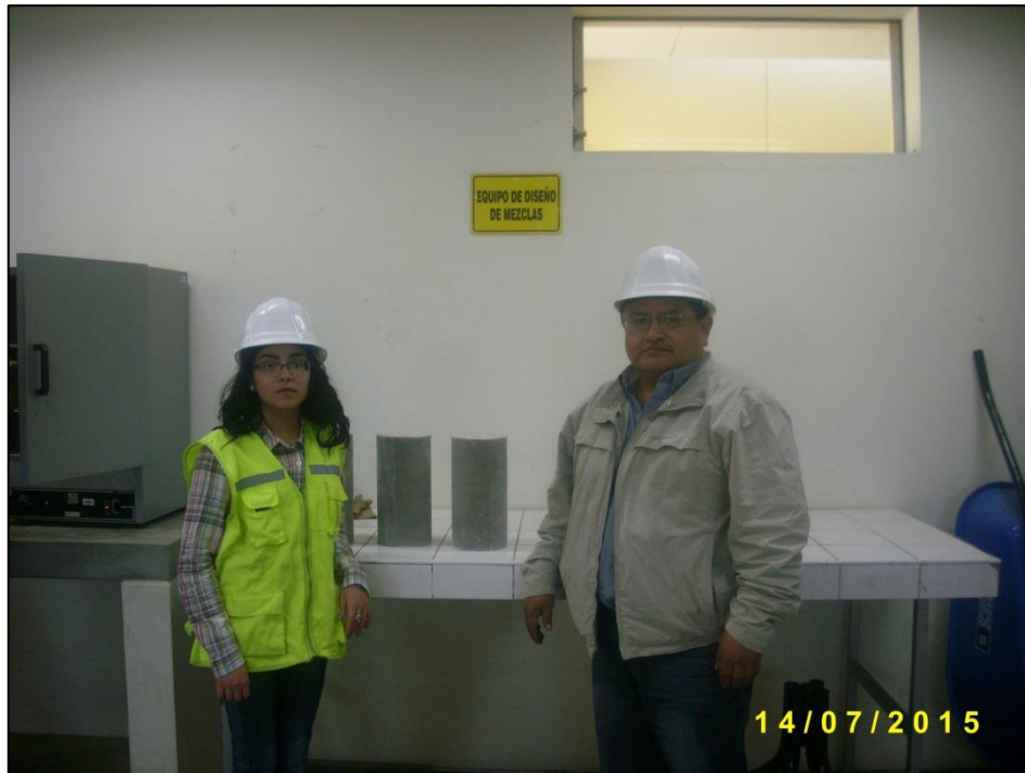
Fotografía n° 152. Probetas listas para ensayo de resistencia a la compresión, compañía del ing. Juan Ávila asesor de tesis.
