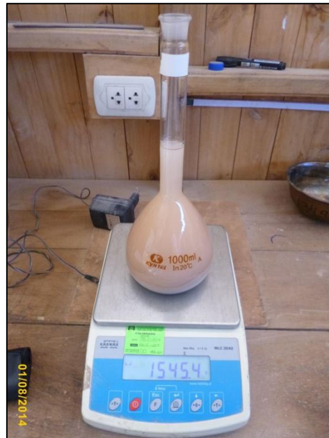
Fotografía n° 95. Izquierda. Peso de fiola más aguas más muestra de agregado fino de río en estado SSS.
