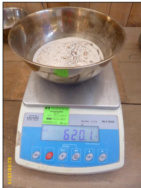
Fotografía n° 95. Izquierda. Peso de tara #45 más muestra de agregado fino de río seca después de 24 horas en el horno.
