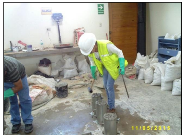
Fotografías n° 140 y n° 141. Llenado de moldes con mezcla.
