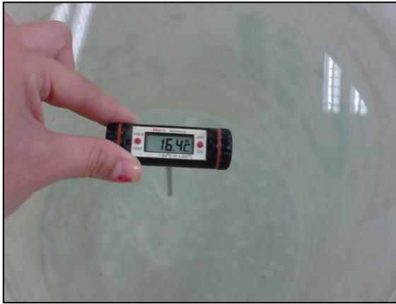
Fotografías n° 116 y n° 117. Toma de temperatura de agua para mezcla.
