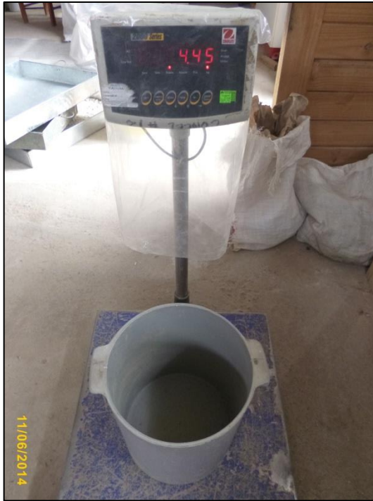
Fotografía n° 70. Izquierda. Peso de molde para ensayo de peso unitario.
