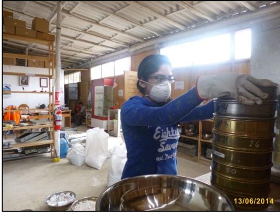
Fotografía n° 51 y n° 52. Tamizado de fracción fina.
