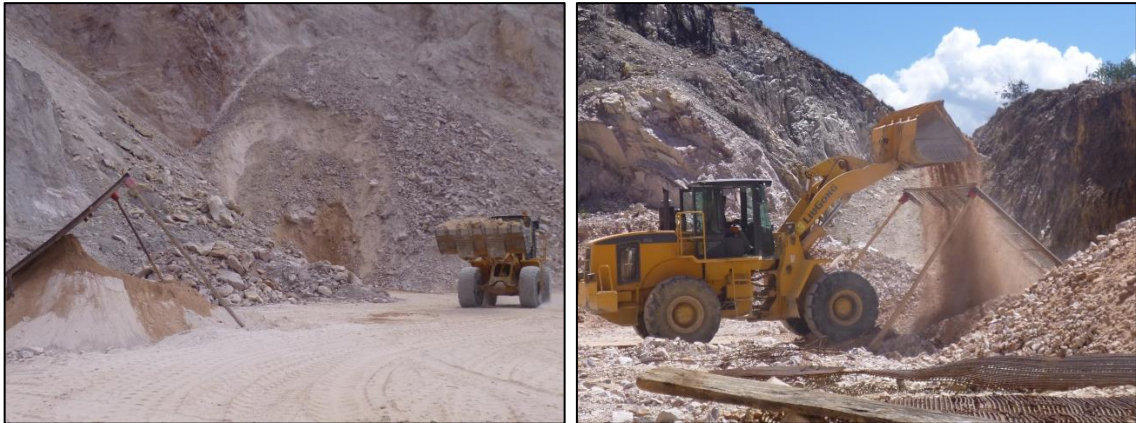
Fotografía n° 4. Izquierda. Cantera Don Lucho I, cargador frontal acarreando material hacia una zaranda.
