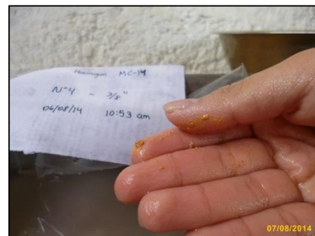
Fotografía n° 107. Muestra de hormigón de cerro retenida entre las mallas N°4 y N°16, previamente pesadas se las sumerge en agua durante 24 horas.
