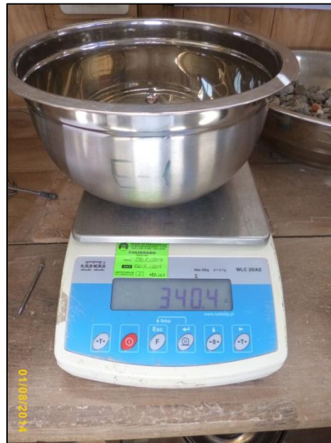
Fotografía n° 97. Peso de tara E-1 utilizada para el ensayo de peso específico de hormigón de cerro (fracción gruesa retenida sobre malla 3/8”).
