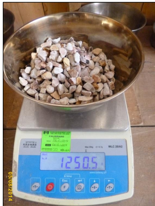
Fotografía n° 62. Arriba izquierda. Peso de muestra pasa malla 1 1/2" y se retiene en malla 1", de hormigón de cerro para ensayo de abrasión.
