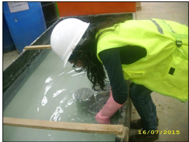
Fotografías n° 145 y n° 146. Sacando las probetas de la poza de curado, para realizar ensayo a compresión.
