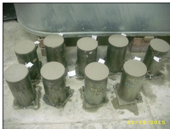
Fotografía n° 142. Moldes llenos y enrasado sobre un superficie lisa donde reposaran 24 horas antes de ser desmoldadas.
