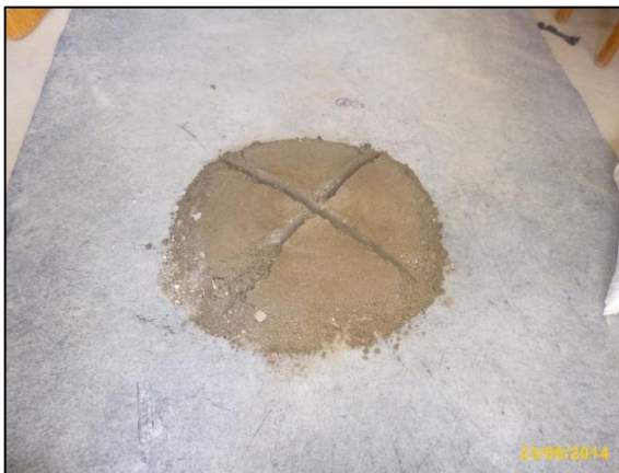
Fotografía n° 43. Izquierda. Cuarteo de agregado fino de río.
