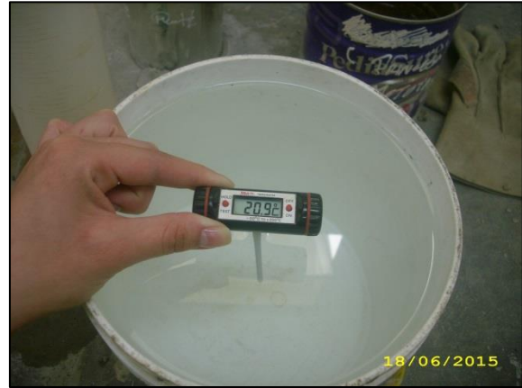
Fotografías n° 116 y n° 117. Toma de temperatura de agua para mezcla.
