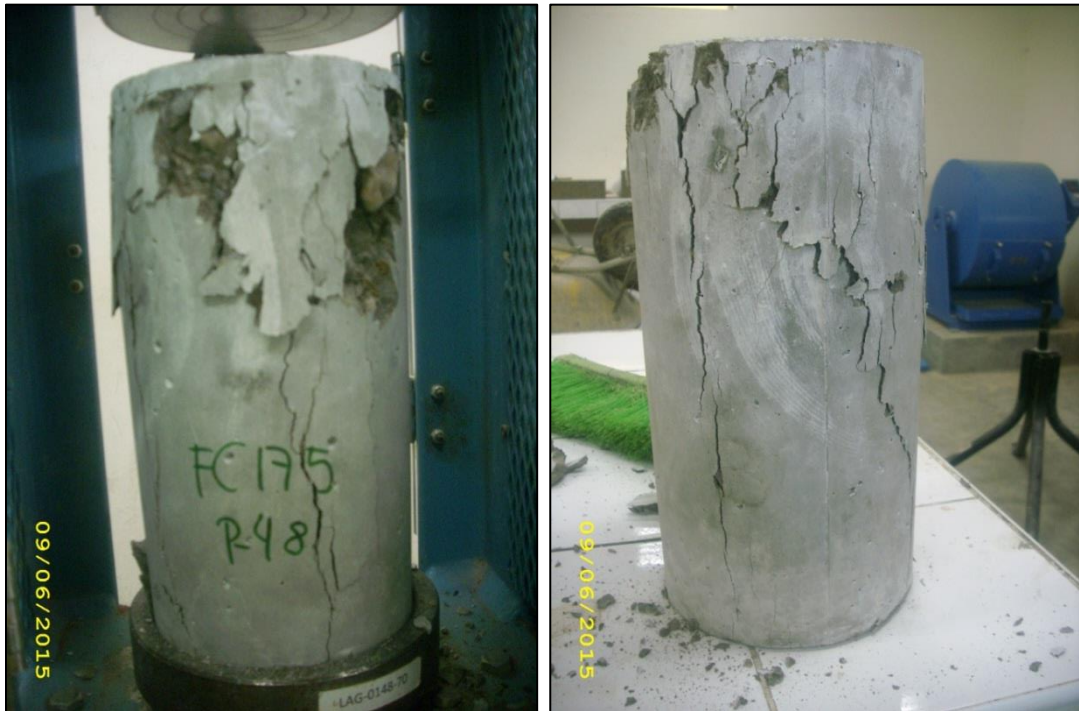
Fotografías n° 162 y n° 163. Probeta con agregado de río ensayada a los 28 días.
