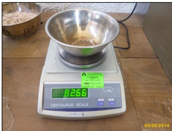
Fotografía n° 33. Izquierda. Peso de tara X-06 para ensayo de contenido de humedad. Fotografía n° 34. Derecha. Peso de tara X-05 para ensayo de contenido de humedad.
