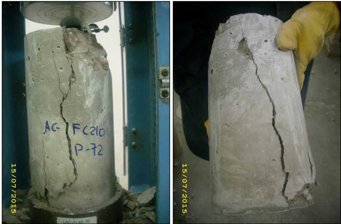
Fotografías n° 175 y n° 176. Probeta con agregado de cerro ensayada a los 28 días. Fractura tipo 3 según NTP 339.034
