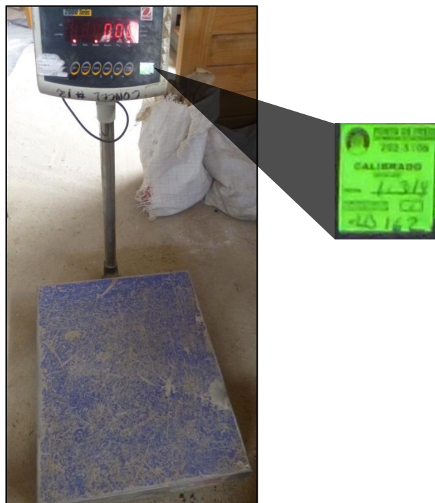
Fotografía n° 23. Balanza electrónica de capacidad 150kg, certificado de calibración LB 162 ver en ANEXO C
