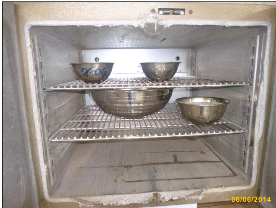
Fotografía n° 37. Muestras llevas al horno, o estufa, por 24 horas a un temperatura 110^{\circ}\text{C} .
