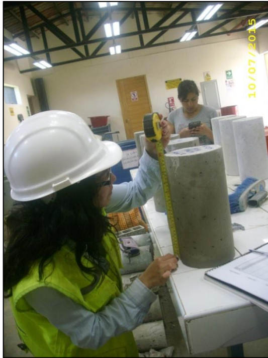
Fotografías n° 148 y n° 149. Medición de la altura o longitud de las probetas.
