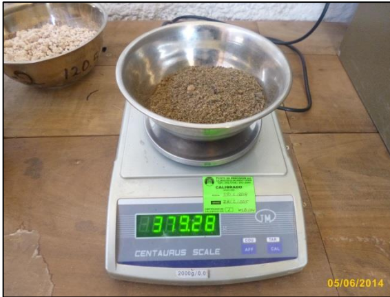
Fotografía n° 35. Izquierda. Peso de tara más muestra húmeda de agregado fino de río para ensayo de contenido de humedad.
