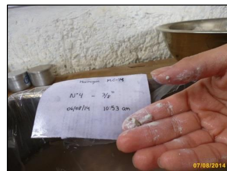
Fotografía n° 108. Izquierda. Muestra de hormigón de cerro retenida entre las mallas 3/8" y N°4, previamente pesadas se las sumerge en agua durante 24 horas.
