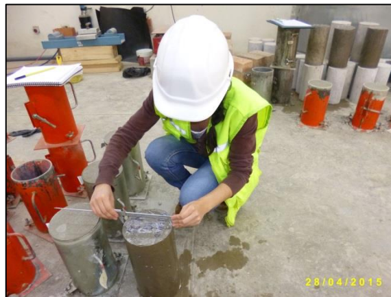
Fotografías n° 150 y n° 151. Medición del diámetro de las probetas.
