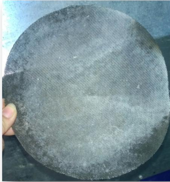
Figura n.º 34. Malla de acero Mesh nº 50
