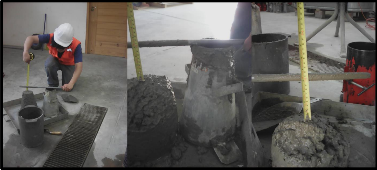
FOTOGRAFIA N° 48 Ensayo para medir el asentamiento o Slump
