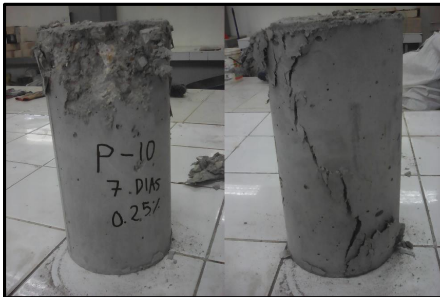
FOTOGRAFIA N° 10 Fractura presentada en la probeta 1 del diseño con 0.25% de Fibras de Polipropileno a los 7 días (Fractura tipo IV)
