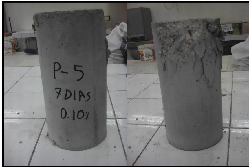
FOTOGRAFIA N° 5 Fractura presentada en la probeta 2 del diseño con 0.10% de Fibras de Polipropileno a los 7 días (Fractura tipo VI)
