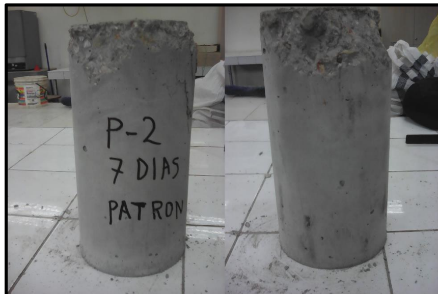
FOTOGRAFIA N° 2 Fractura presentada en la probeta 2 del diseño patrón a los 7 días (Fractura tipo VI)
