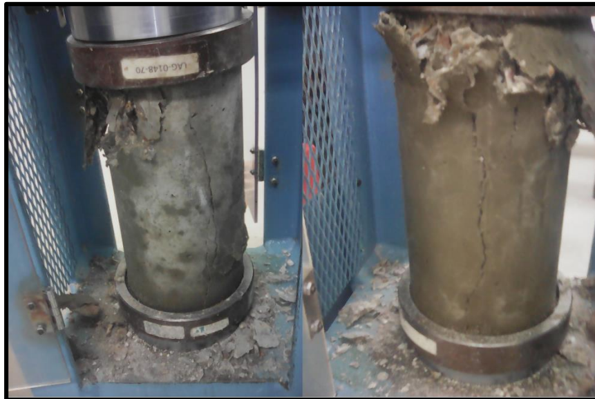
FOTOGRAFIA N° 23 Fractura presentada en la probeta 2 del diseño con 0.25% de fibras de Polipropileno a los 14 días (Fractura tipo III)
