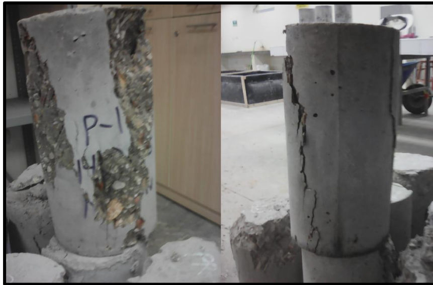
FOTOGRAFIA N° 15 Fractura presentada en la probeta 3 del diseño patrón a los 14 días (Fractura tipo III)
