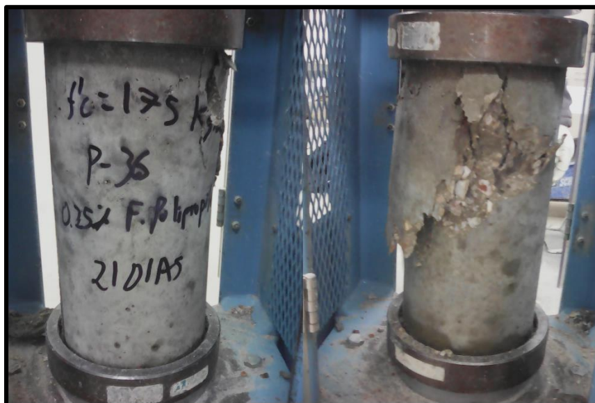
FOTOGRAFIA N° 36 Fractura presentada en la probeta 3 del diseño con 15% de Fibras de Polipropileno a los 21 días (Fractura tipo II)
