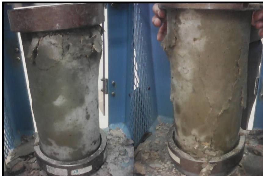
FOTOGRAFIA N° 24 Fractura presentada en la probeta 3 del diseño con 0.25% de fibras de Polipropileno a los 14 días (Fractura tipo III)
