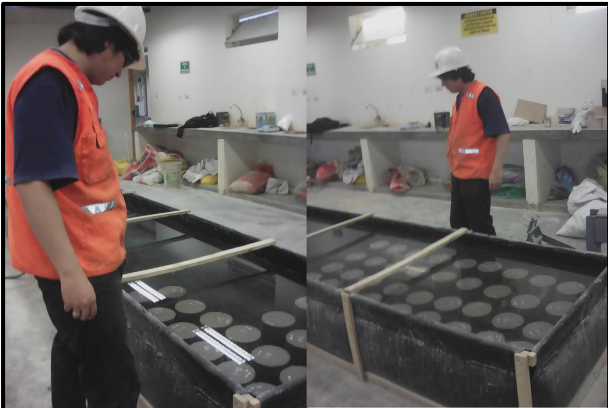
FOTOGRAFIA N° 51 Probetas sumergidas a la poza de curado inmediatamente después del desencofrado
