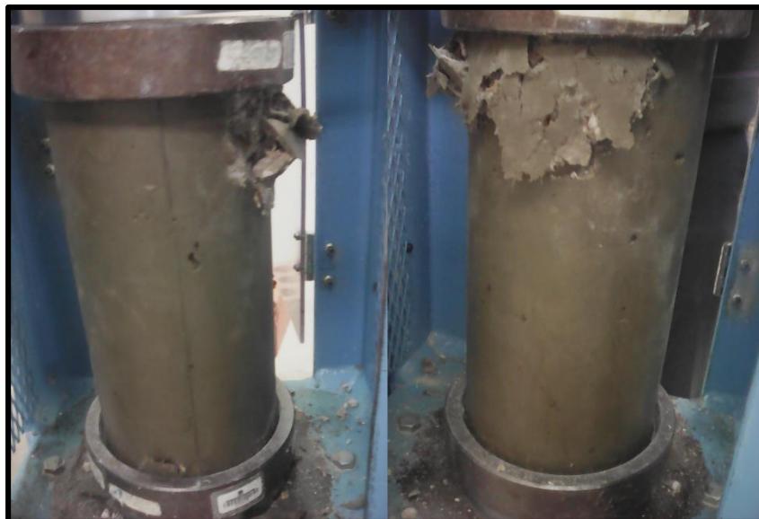
FOTOGRAFIA N° 20 Fractura presentada en la probeta 2 del diseño con 0.17% de fibras de Polipropileno a los 14 días (Fractura tipo V)
