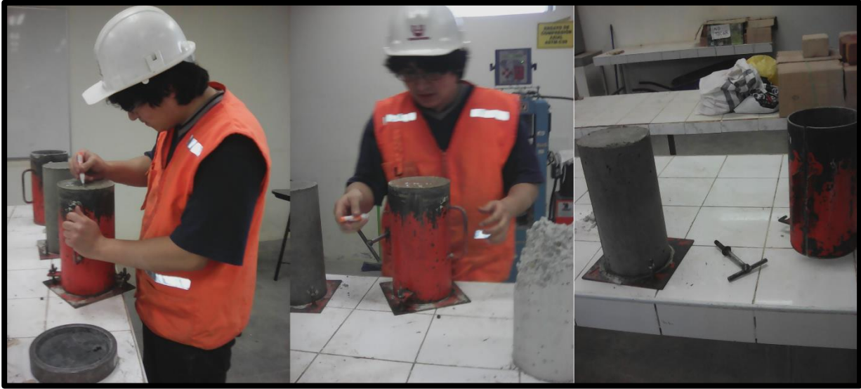
FOTOGRAFIA N° 50 Desencofrado de Probetas a las 24 horas
