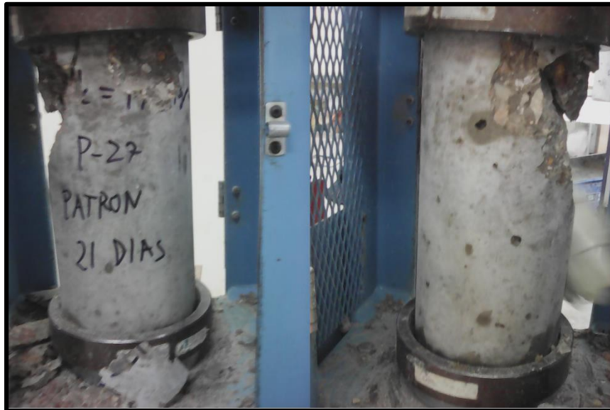
FOTOGRAFIA N° 27 Fractura presentada en la probeta 3 del diseño patrón a los 21 días (Fractura tipo VI)
