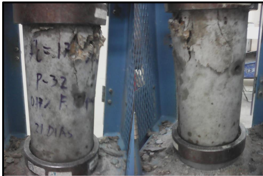
FOTOGRAFIA N° 32 Fractura presentada en la probeta 2 del diseño con 0.17% de fibras de Polipropileno a los 21 días (Fractura tipo V)
