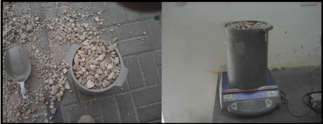
FOTOGRAFIA N° 44 Peso unitario volumétrico suelto seco y peso unitario volumétrico compactado seco del agregado Grueso.
