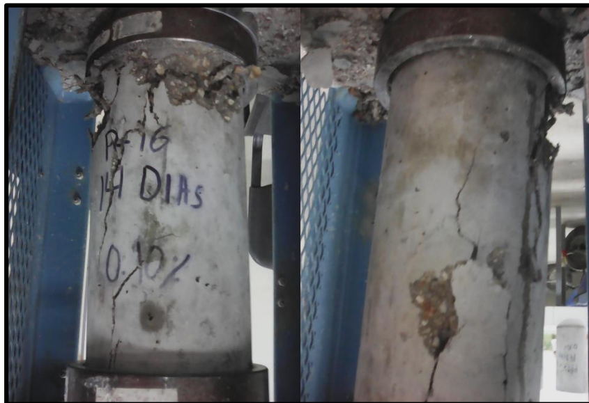
FOTOGRAFIA N° 16 Fractura presentada en la probeta 1 del diseño con 0.10% de fibras de Polipropileno a los 14 días (Fractura tipo III)
