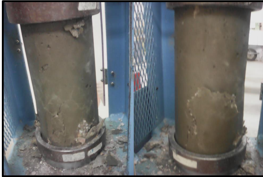
FOTOGRAFIA N° 21 Fractura presentada en la probeta 3 del diseño con 0.17% de fibras de Polipropileno a los 14 días (Fractura tipo VI)
