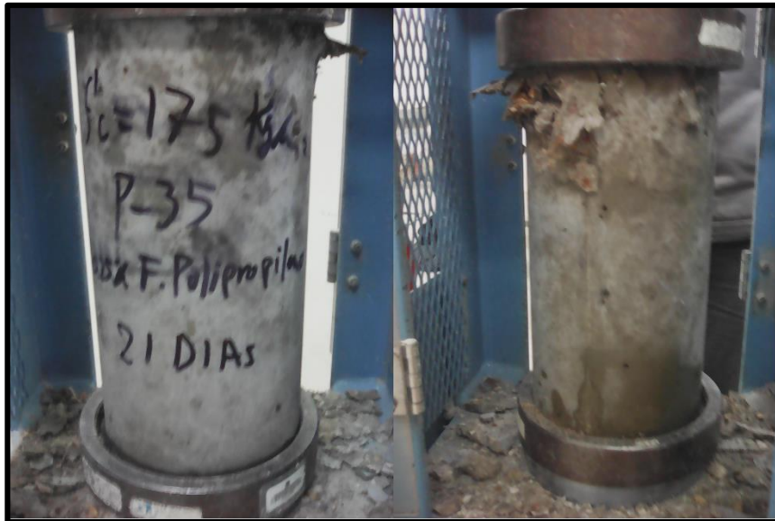
FOTOGRAFIA N° 35 Fractura presentada en la probeta 2 del diseño con 0.25% de fibras de Polipropileno a los 21 días (Fractura tipo V)
