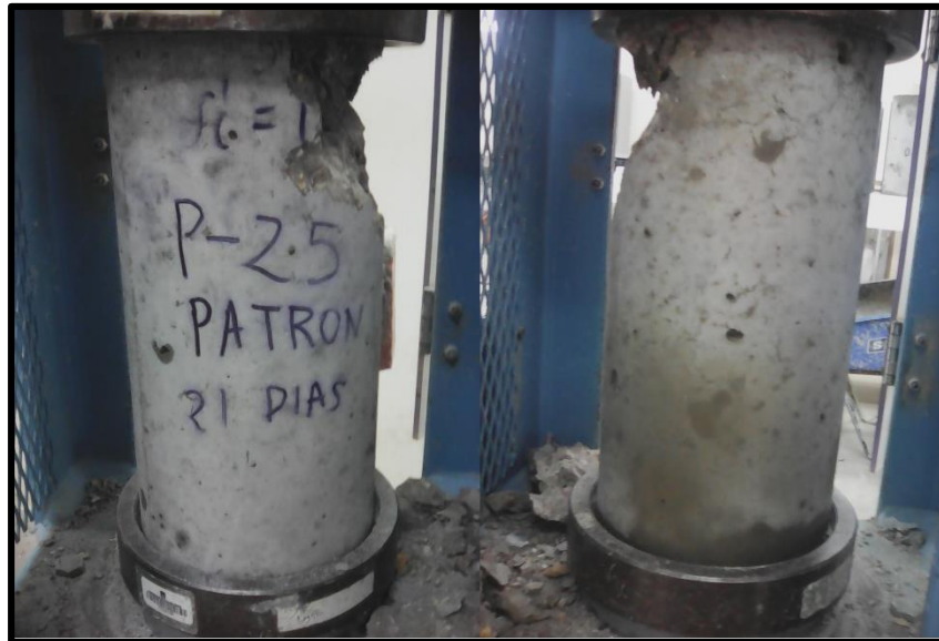
FOTOGRAFIA N° 25 Fractura presentada en la probeta 1 del diseño patrón a los 21 días (Fractura tipo V)
