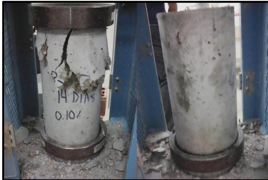
FOTOGRAFIA N° 17 Fractura presentada en la probeta 2 del diseño con 0.10% de fibras de Polipropileno a los 14 días (Fractura tipo V)
