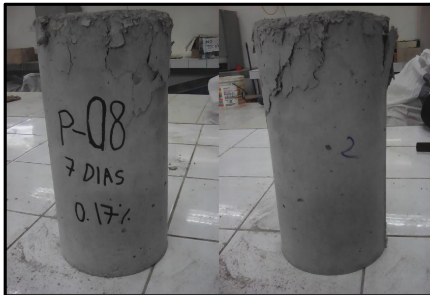
FOTOGRAFIA N° 8 Fractura presentada en la probeta 2 del con 0.17% de Fibras de Polipropileno a los 7 días (Fractura tipo II)
