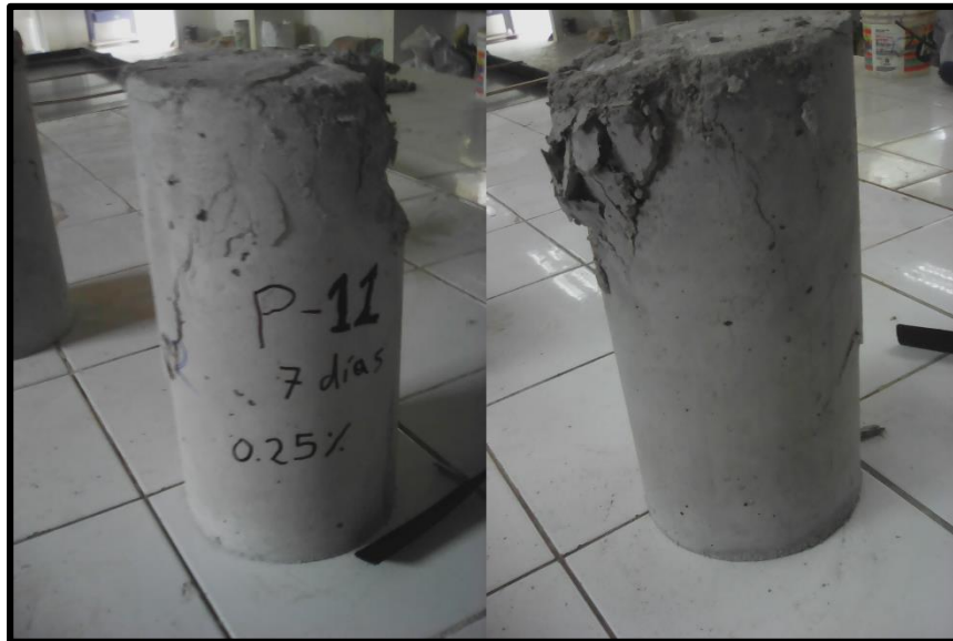
FOTOGRAFIA N° 11 Fractura presentada en la probeta 2 del diseño con 0.25% de Fibras de Polipropileno a los 7 días (Fractura tipo II)
