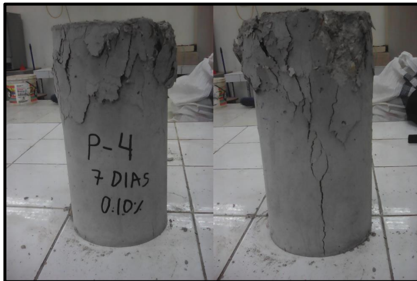
FOTOGRAFIA N° 4 Fractura presentada en la probeta 1 del diseño con 0.10% de Fibras de Polipropileno a los 7 días (Fractura tipo III)
