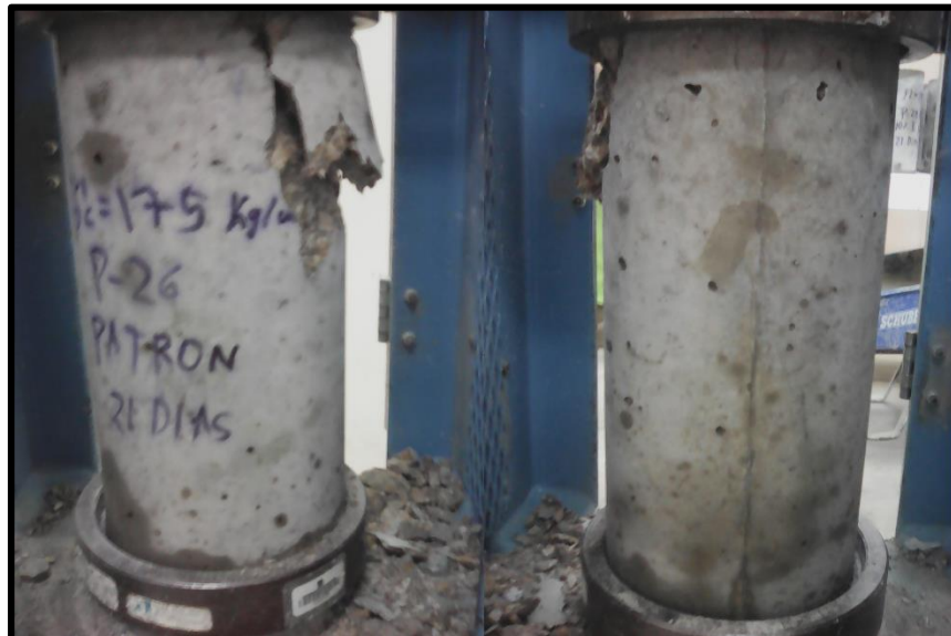
FOTOGRAFIA N° 26 Fractura presentada en la probeta 2 del diseño patrón a los 21 días (Fractura tipo V)
