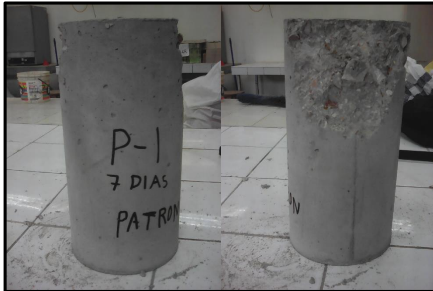
FOTOGRAFIA N° 1 Fractura presentada en la probeta 1 del diseño patrón a los 7 días (Fractura tipo VI)
