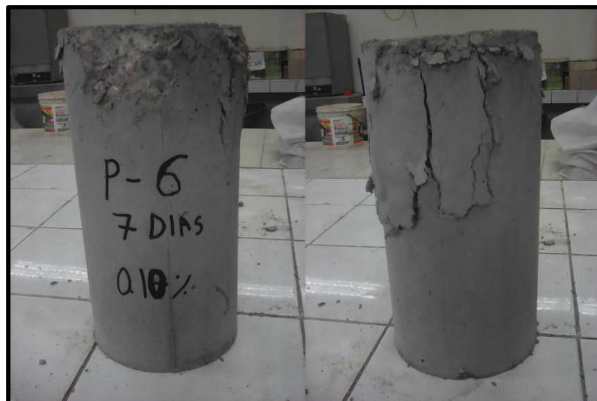
FOTOGRAFIA N° 6 Fractura presentada en la probeta 3 del diseño con 0.10% de Fibras de Polipropileno a los 7 días (Fractura tipo II)
