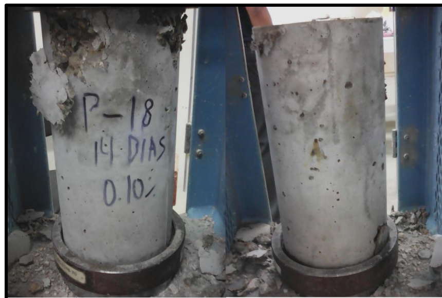
FOTOGRAFIA N° 18 Fractura presentada en la probeta 3 del diseño con 0.10% de fibras de Polipropileno a los 14 días (Fractura tipo VI)
