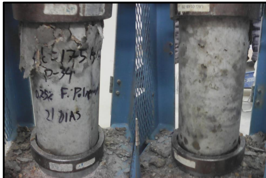
FOTOGRAFIA N° 34 Fractura presentada en la probeta 1 del diseño con 0.25% de fibras de Polipropileno a los 21 días (Fractura tipo V)
