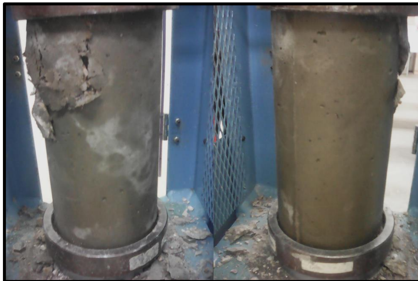
FOTOGRAFIA N° 22 Fractura presentada en la probeta 1 del diseño con 0.25% de fibras de Polipropileno a los 14 días (Fractura tipo V)
