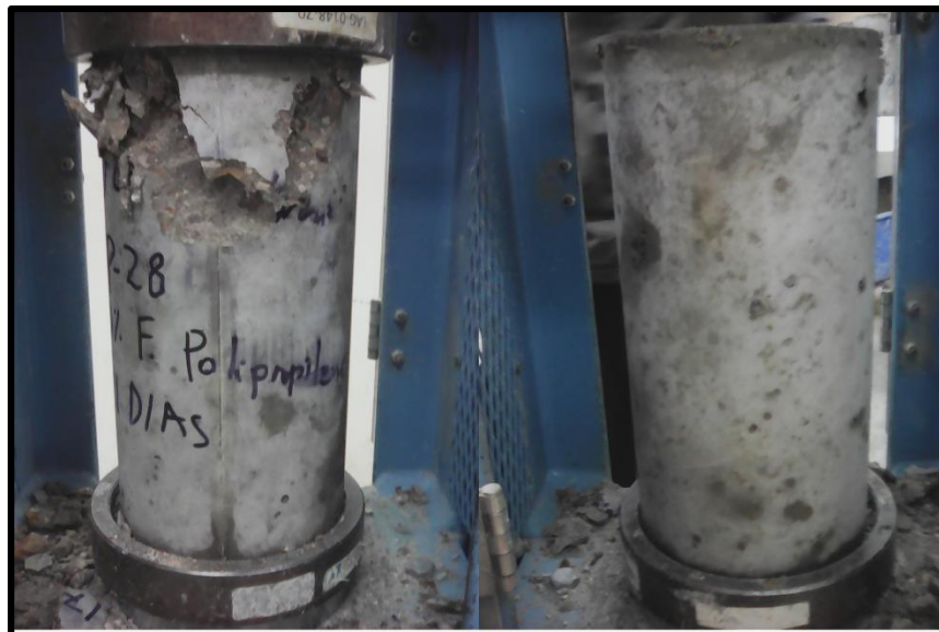
FOTOGRAFIA N° 28 Fractura presentada en la probeta 1 del diseño con 0.10% de fibras de Polipropileno a los 21 días (Fractura tipo V)
