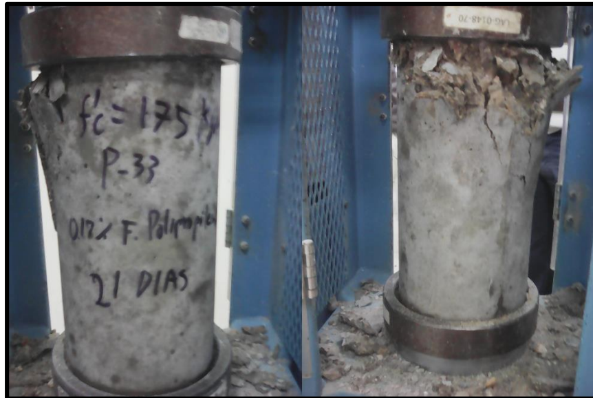
FOTOGRAFIA N° 33 Fractura presentada en la probeta 3 del diseño con 0.17% de fibras de Polipropileno a los 21 días (Fractura tipo V)
