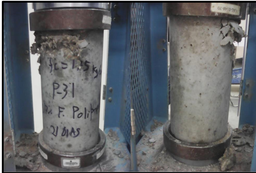
FOTOGRAFIA N° 31 Fractura presentada en la probeta 1 del diseño con 0.17% de fibras de Polipropileno a los 21 días (Fractura tipo V)
