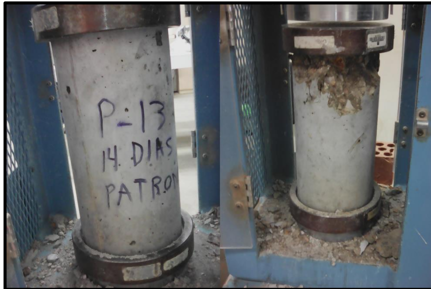
FOTOGRAFIA N° 13 Fractura presentada en la probeta 1 del diseño patrón a los 14 días (Fractura tipo VI)
