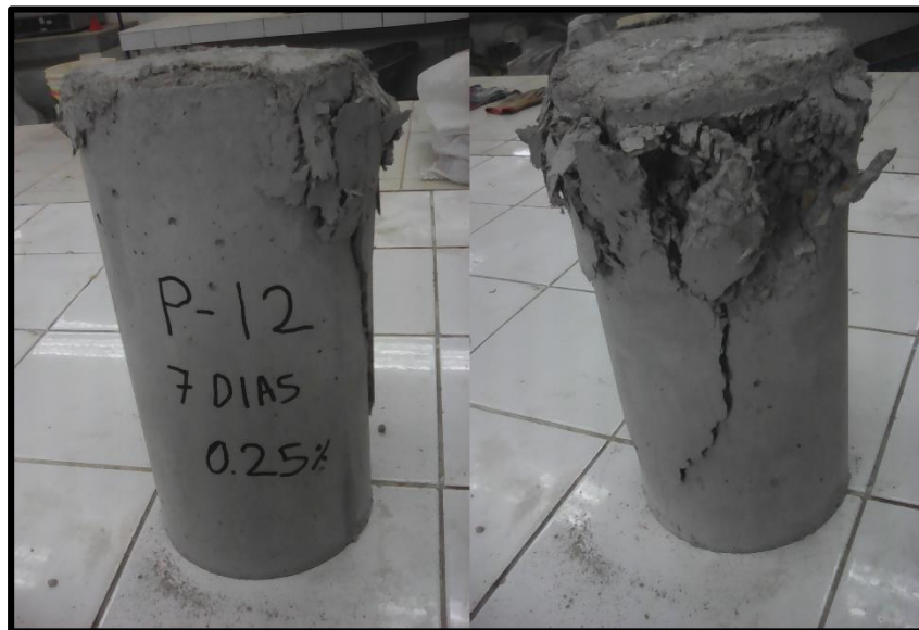
FOTOGRAFIA N° 12 Fractura presentada en la probeta 3 del diseño con 0.25% de Fibras de Polipropileno a los 7 días (Fractura tipo IV)
