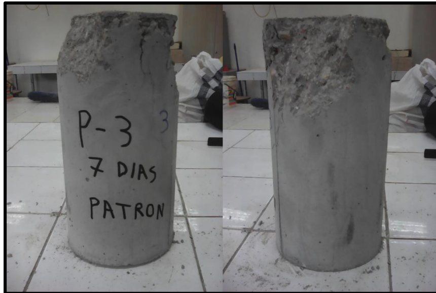
FOTOGRAFIA N° 3 Fractura presentada en la probeta 3 del diseño patrón a los 7 días (Fractura tipo VI)
