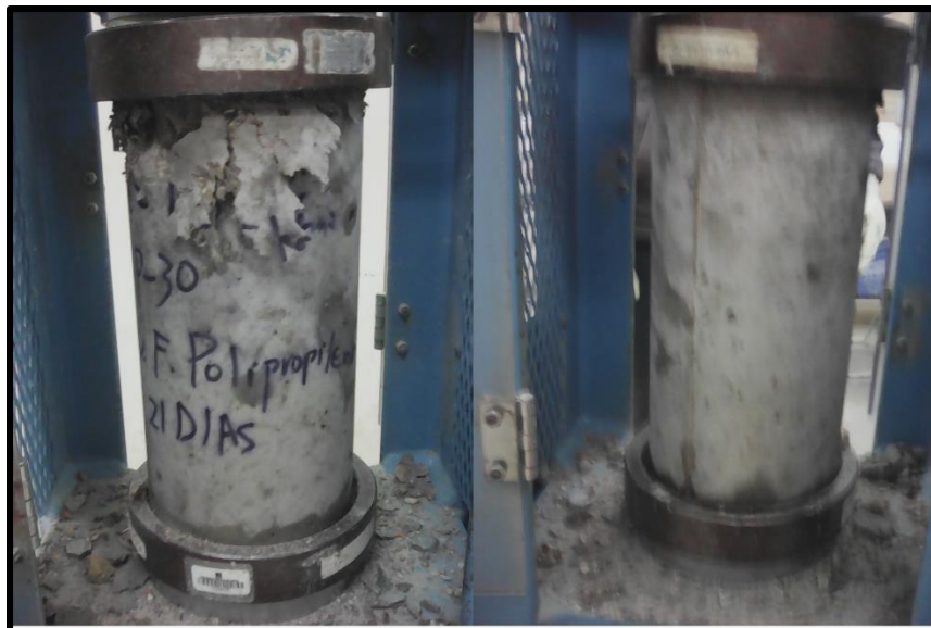
FOTOGRAFIA N° 30 Fractura presentada en la probeta 3 del diseño con 0.10% de fibras de Polipropileno a los 21 días (Fractura tipo V)
