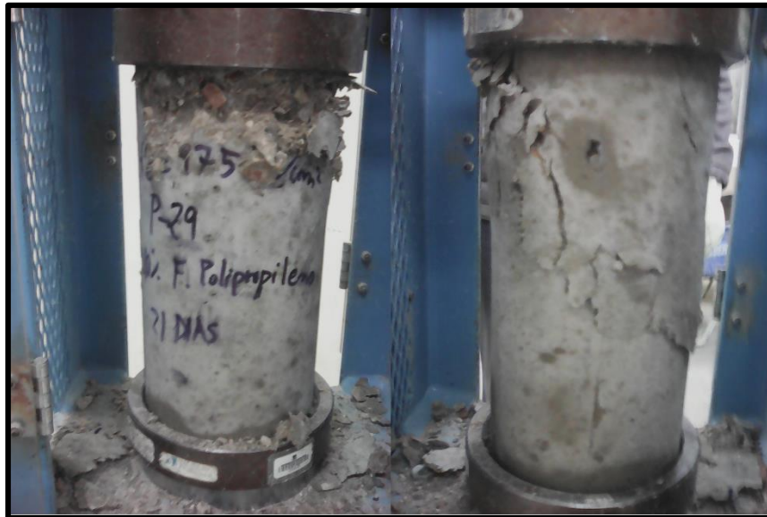
FOTOGRAFIA N° 29 Fractura presentada en la probeta 2 del diseño 0.10% de fibras de Polipropileno a los 21 días (Fractura tipo II)
