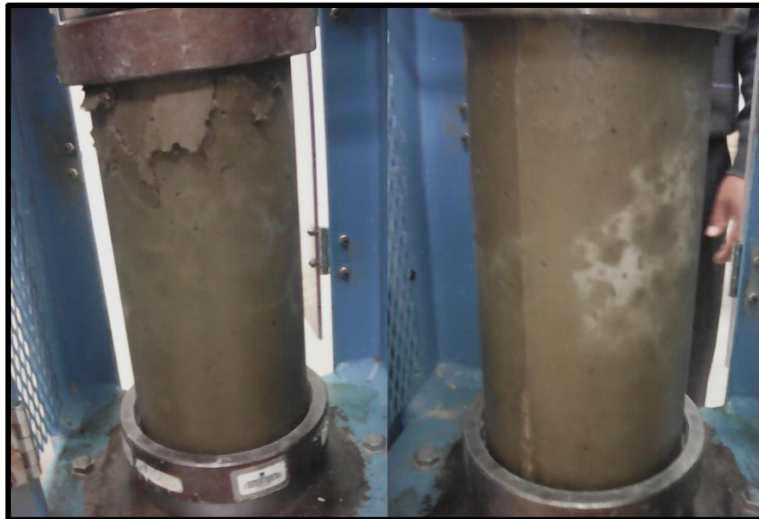
FOTOGRAFIA N° 19 Fractura presentada en la probeta 1 del diseño con 0.17% de fibras de Polipropileno a los 14 días (Fractura tipo V)
