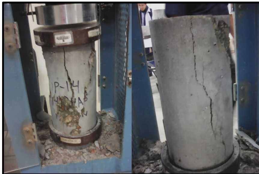
FOTOGRAFIA N° 14 Fractura presentada en la probeta 2 del diseño patrón a los 14 días (Fractura tipo III)
