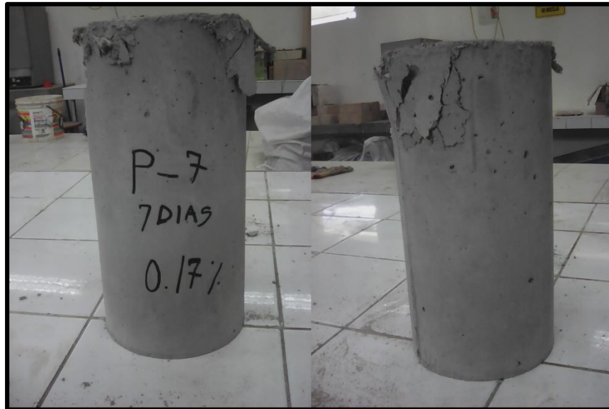
FOTOGRAFIA N° 7 Fractura presentada en la probeta 1 del con 0.17% de Fibras de Polipropileno a los 7 días (Fractura tipo VI)
