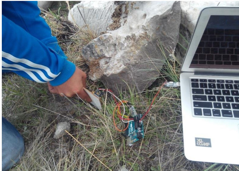
Figura N ° 16 Instalación del acelerómetro con la base de madera 10cm x10cm
