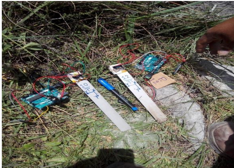
Figura N° 18 Acelerómetros instalados en cada perfil de aluminio
