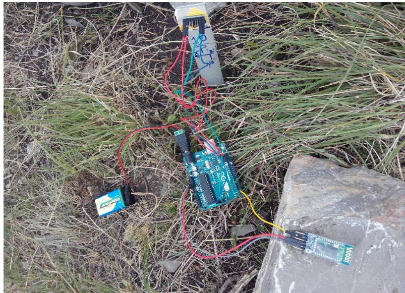
Figura N° 20 Acelerómetros (2) enterrado a 15cm
