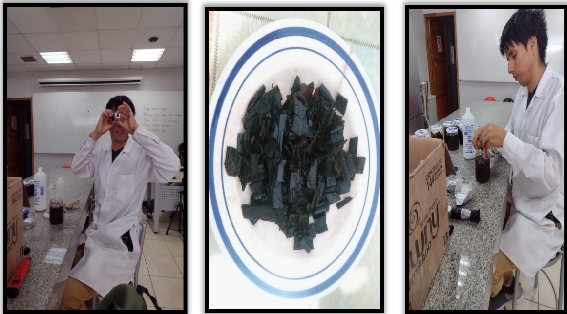
Figura 12. Medición de °Brix y pH con el refractómetro al inicio y final de la fermentación
