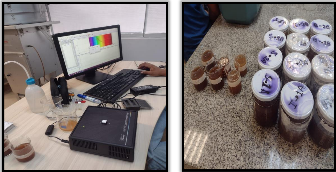
Figura 14. Determinación de la absorbancia en el espectrómetro UV – Visible,
